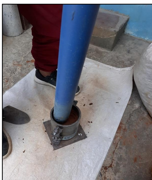
Fotografía 38: Compactación con 25 golpes.
