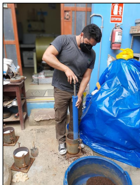
Fotografía 37: Proceso de compactación
