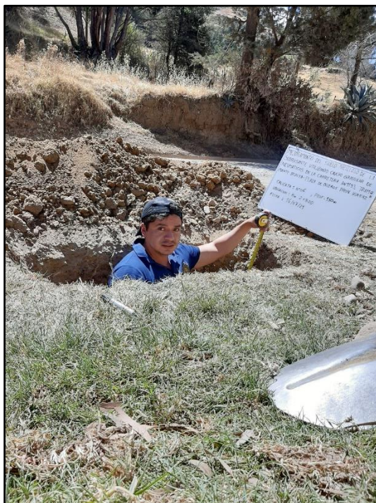
Fotografía 15: Profundidad 1.50 m calicata N°06
