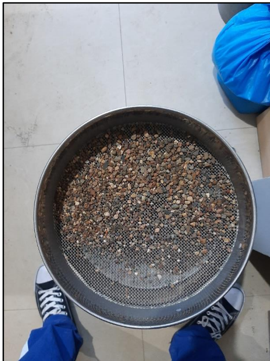
Fotografía 29: Material retenido en la malla N°40
