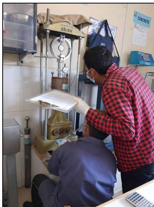
Fotografía 44: Toma de datos de ensayo de CBR.
