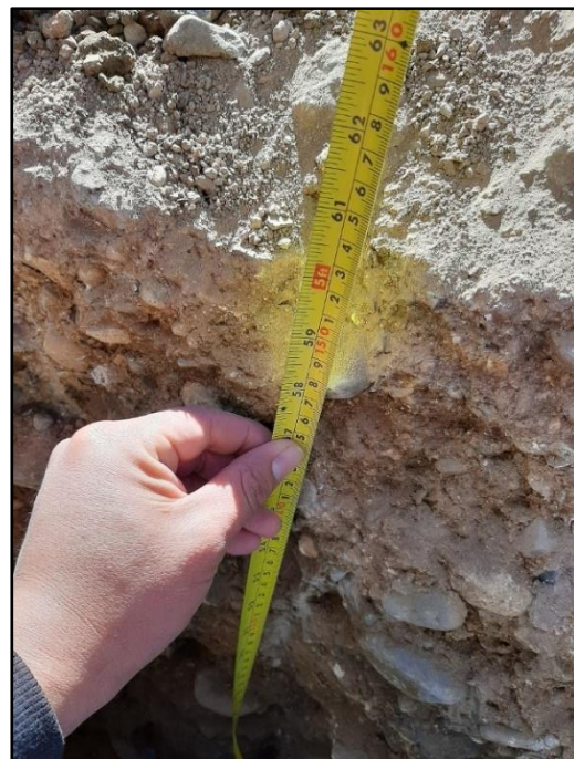
Fotografía 4: Profundidad 1.5 m de calicata N°01
