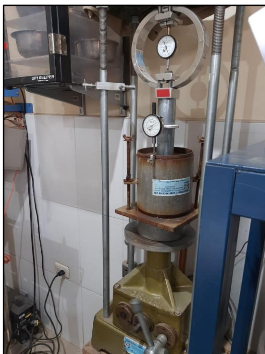
Fotografía 43: Ensayo de CBR.
