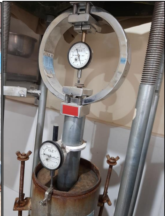
Fotografía 50: Ensayo de CBR de muestra con caucho granular de neumáticos.
