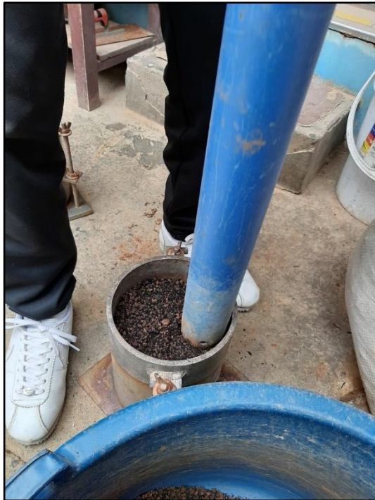
Fotografía 47: Compactación de la muestra con caucho granular de neumáticos.
