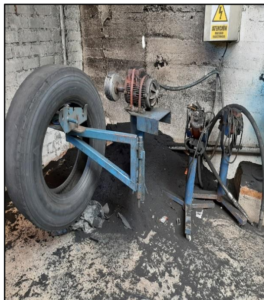
Fotografía 52: Proceso de molido de caucho
