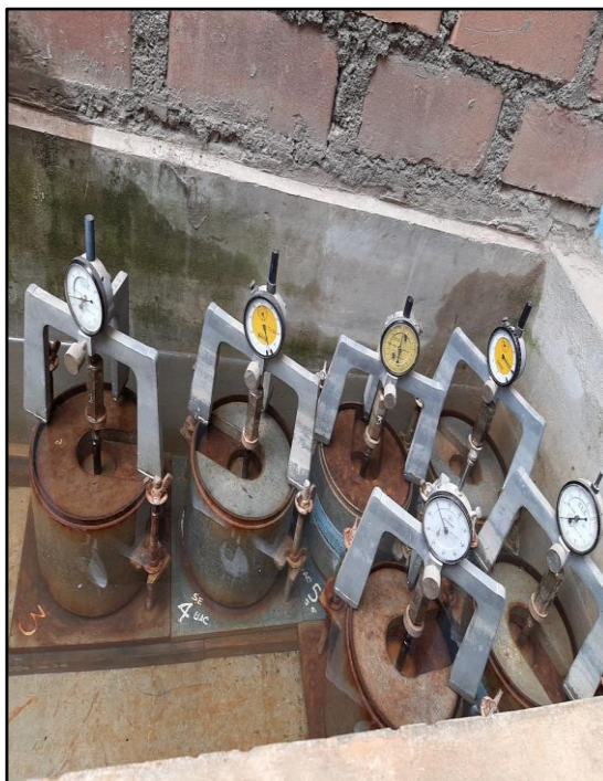
Fotografía 49: Saturación de muestra con caucho granular de neumáticos.
