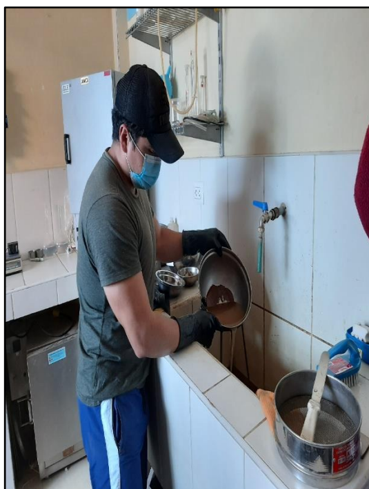
Fotografía 31: Lavado de muestra con agua potable
