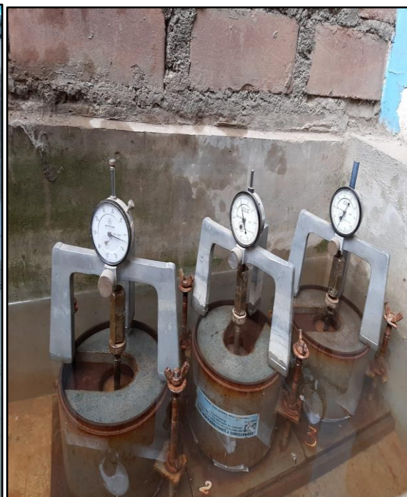
Fotografía 42: Saturación de muestra compactada para ensayo de CBR.
