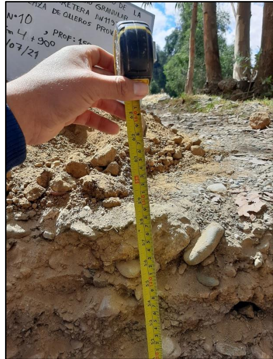
Fotografía 26: Profundidad 1.5 m. Calicata N°010
