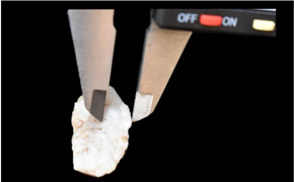
Anexo 81. Uso del calibrador vernier digital para obtener el valor de "D" del unifacial (código OP 260-15). Toledo, K. (2022)
