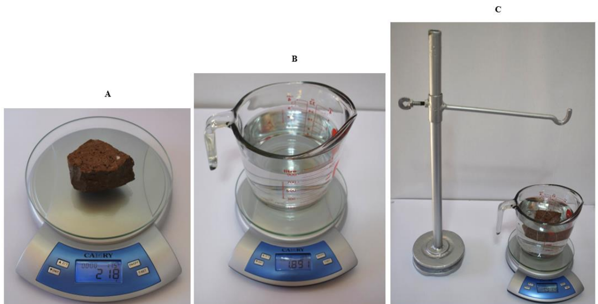
Anexo 76. Ejemplo de la recolección de datos para hallar la masa de empuje del núcleo OP-261-1: (A) masa del núcleo, (B) jarra de vidrio con agua y (C) núcleo sumergido. Toledo, K. (2022)
