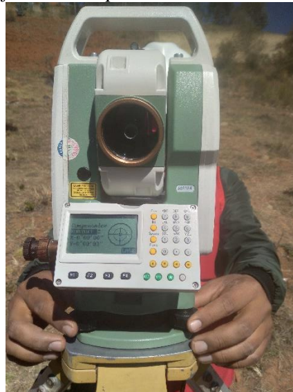
Figura 47 Nivelación fina y verificación de plomada laser
