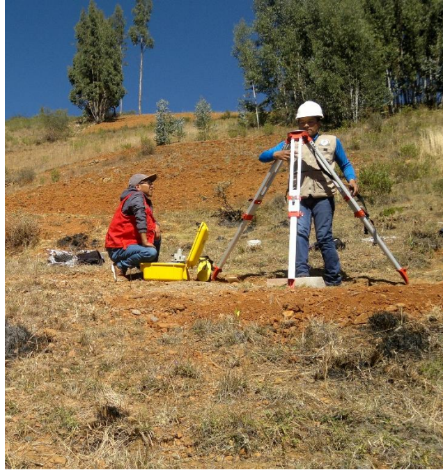
Figura 62 Nivelación de plataforma de trípode de GPS Diferencial
