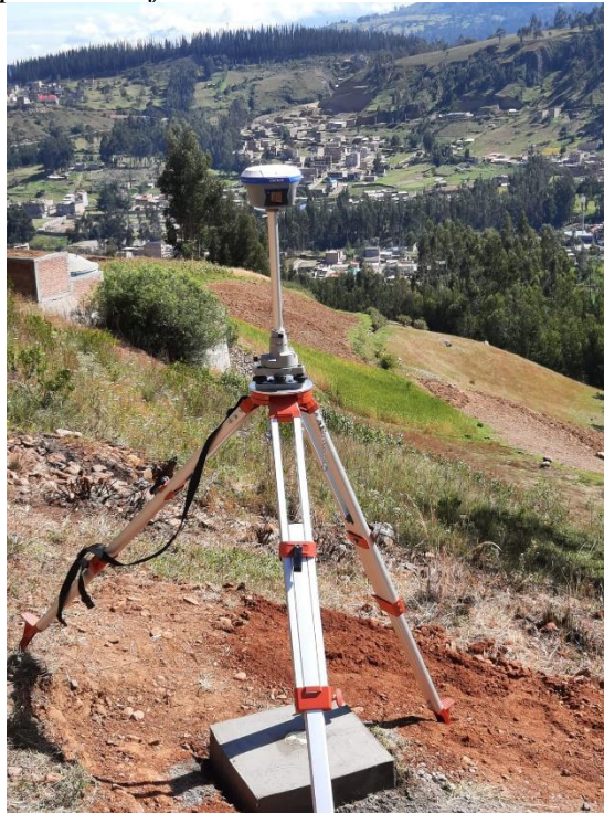
Figura 25 Colocación de equipo GPS Diferencial
