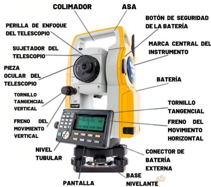
Figura 4 Representación partes de una estación total
