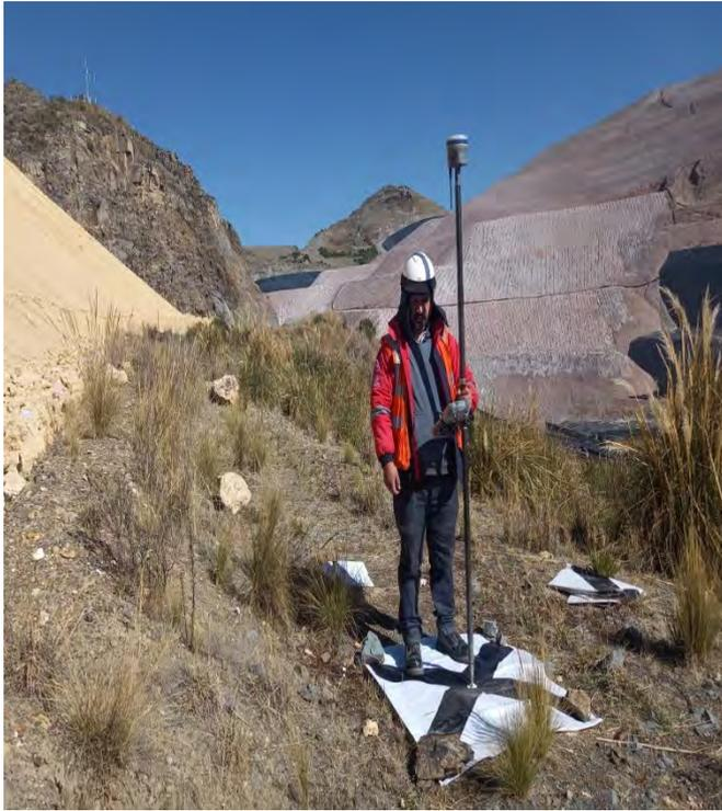
Levantamiento de puntos de fotocontrol con receptor rover GNSS TRIMBLE R10 en modo RKT y colector TRIMBLE TSC3, estos puntos de fotocontrol son para verificar la precisión y error del procesamiento fotogramétrico.
