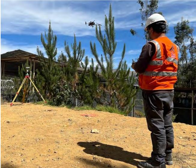
Levantamiento aéreo con dron MAVIC 3 ENTERPRISE modo PPK, este modo de vuelo requiere de un post procesa para georreferenciación sin la necesidad de puntos de apoyo.
