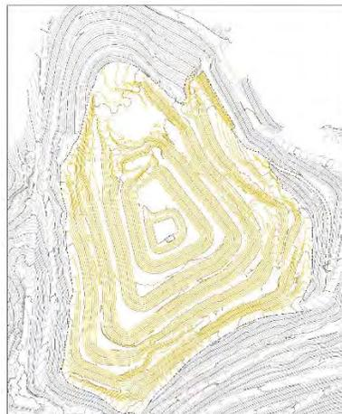
*Nota.* El gráfico representa la forma del terreno tomado topográficamente por métodos tradicionales (terrestre) o aéreos (dron).
