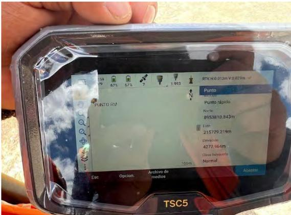
Lectura de coordenadas de punto BM con receptor GNSS para ubicación de estación base.
