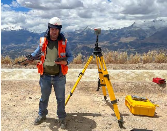
Modo de levantamiento aéreo empleado para la toma de datos es en PPK (KINEMATIC POSTPROCESADO).
