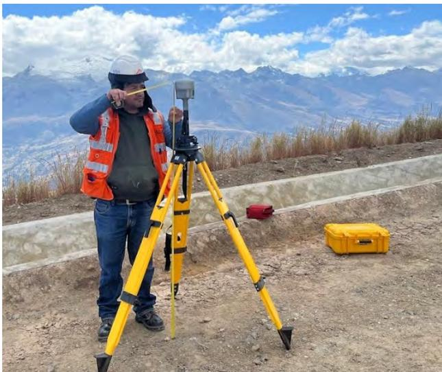
Instalación de receptor GNSS en modo base para toma de datos estáticos, la ubicación de receptor base es en el punto BM.
