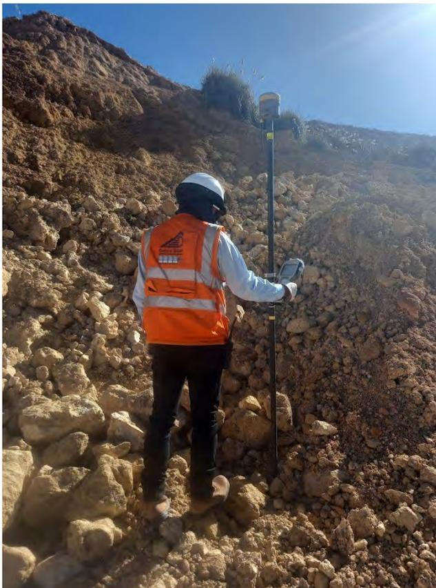
Levantamiento superficial con receptor rover GNSS TRIMBLE R10 en modo RKT y colector TRIMBLE TSC3, Levantamiento avance de corte y relleno en zonas de talud.
