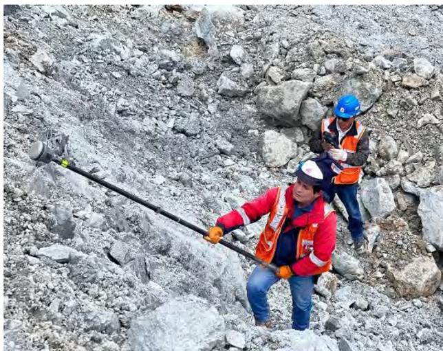
Levantamiento superficial con receptor rover GNSS TRIMBLE R10 en modo RKT y colector TRIMBLE TSC3, Levantamiento avance de corte y relleno en zonas de talud.
