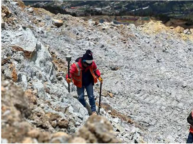
Levantamiento superficial con receptor rover GNSS TRIMBLE R10 en modo RKT y colector TRIMBLE TSC3, Levantamiento avance de corte y relleno en zonas de talud.
