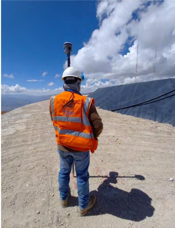
Levantamiento superficial con receptor rover GNSS TRIMBLE R10 en modo RKT y colector TRIMBLE TSC3, Levantamiento de áreas liberadas de corte y relleno en zonas de banquetas.
