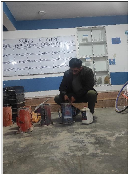
Foto 37: Engrasar el molde metálico para las probetas
