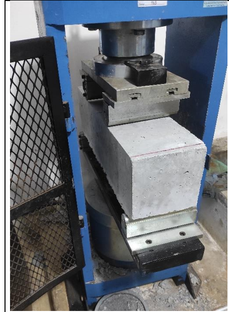
Foto 60: Colocación de las vigas en el dispositivo de flexión
