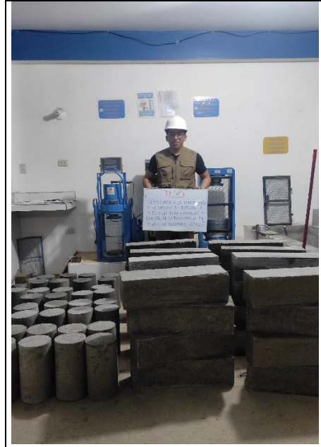
Foto 52: Desencofrado de las probetas y vigas de concreto
