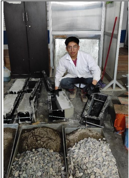
Foto 49: Desencofrado de las probetas y vigas de concreto
