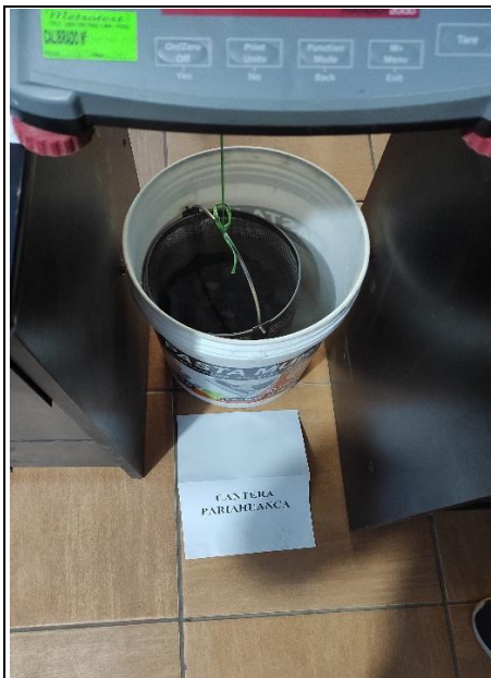
Foto 31: Pesaje de la muestra sumergida en una cesta metálica
