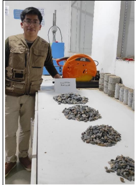
Foto 18: Granulometría del agregado grueso
