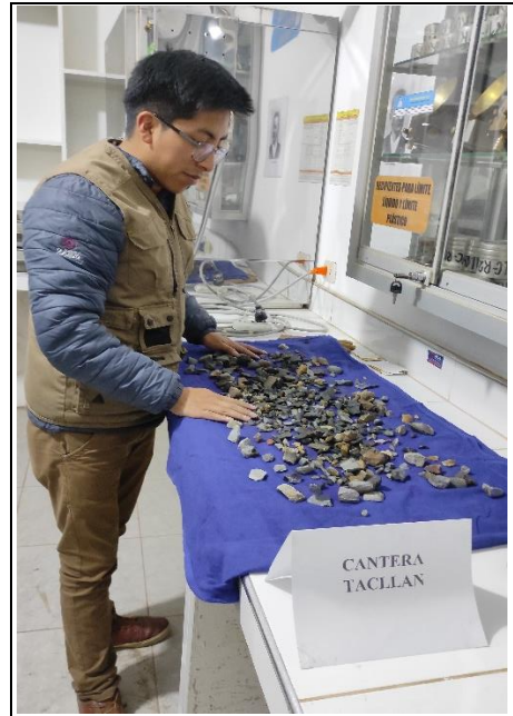
Foto 30: Secado superficial del agregado grueso con un paño
