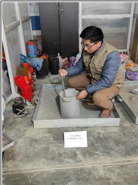
Foto 19: Compactación del agregado fino
