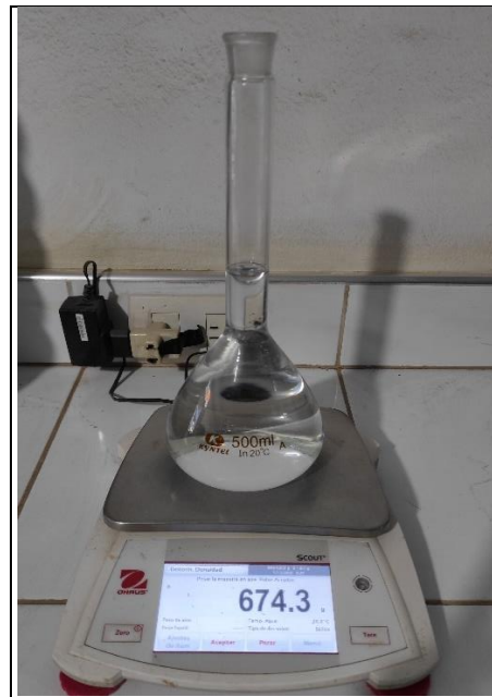
Foto 26: Pesaje del picnómetro con agua hasta la marca
