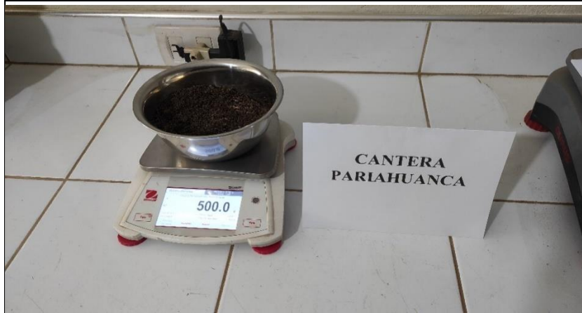
Foto 7: Peso del agregado fino, para el cálculo de la humedad
