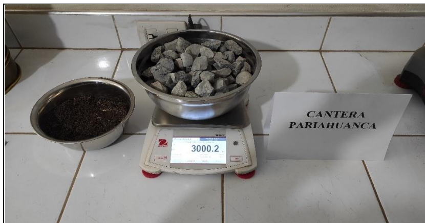
Foto 9: Peso seco de agregados, para el cálculo de la humedad
