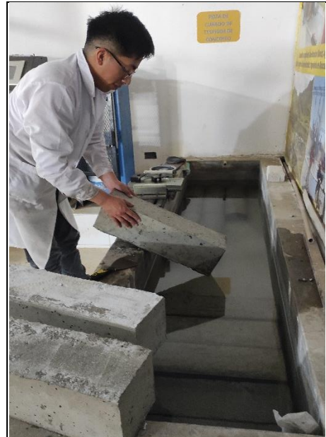
Foto 50: Curado de las probetas y vigas de concreto
