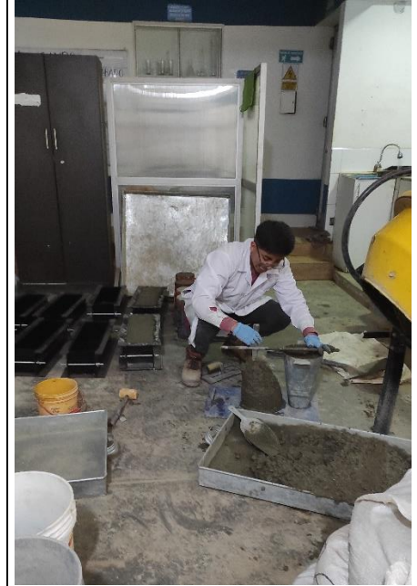
Foto 44: Medición del slump, cumple con el diseño
