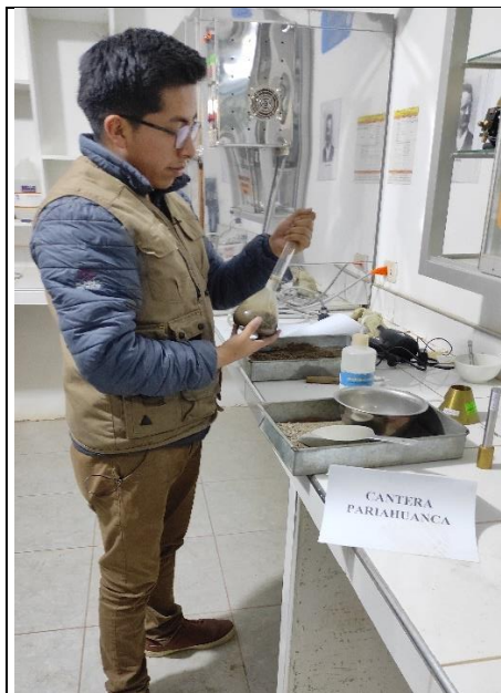
Foto 27: Eliminación de burbujas de aire de manera manual
