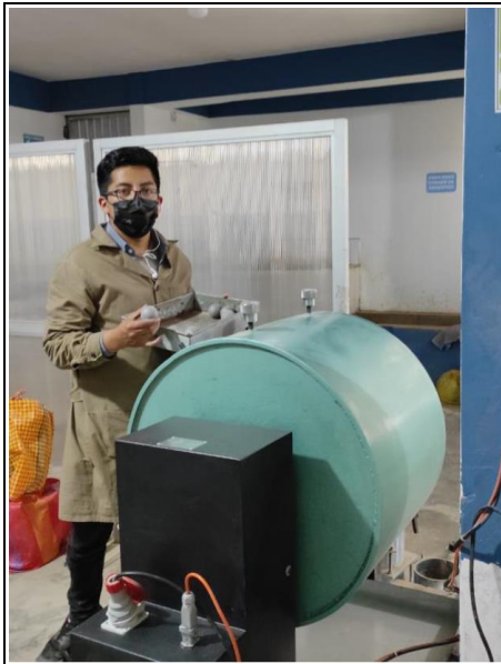
Foto 33: Ensayo de abrasión del agregado grueso
