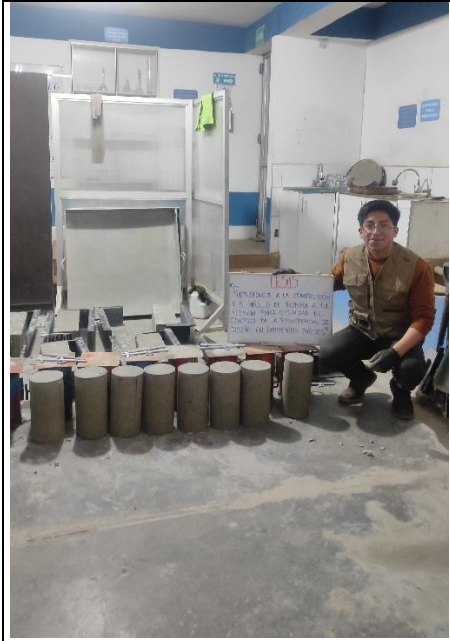
Foto 51: Desencofrado de las probetas y vigas de concreto
