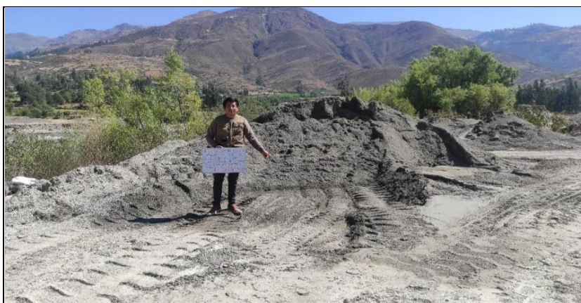
Foto 3: Muestreo del agregado fino de la cantera Pariahuanca
