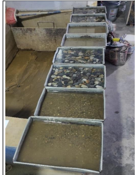
Foto 24: Saturación por 24hrs de los agregados, para el cálculo de la absorción
