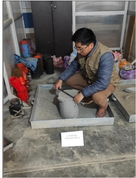
Foto 20: Enrasado del agregado fino compactado
