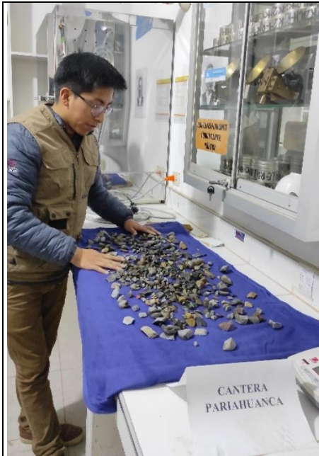
Foto 29: Secado superficial del agregado grueso con un paño
