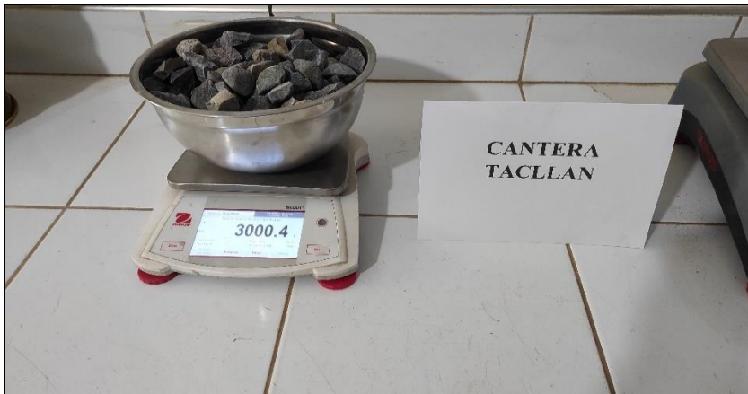
Foto 11: Peso del agregado grueso, para el cálculo de la humedad
