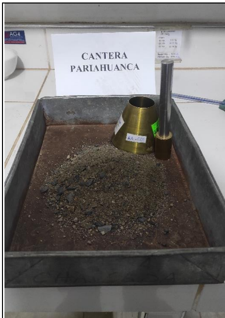
Foto 25: Agregado fino en estado saturado superficialmente seca
