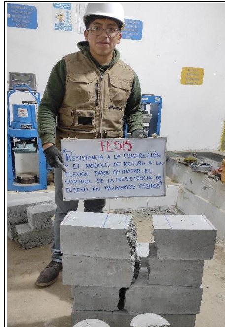
Foto 62: Ensayo de resistencia a la flexión
