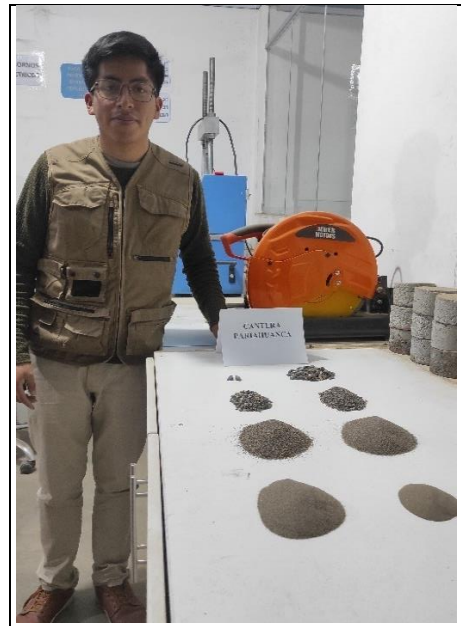
Foto 16: Granulometría del agregado fino
