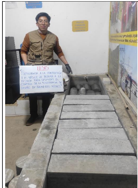
Foto 54: Curado de las probetas y vigas de concreto
