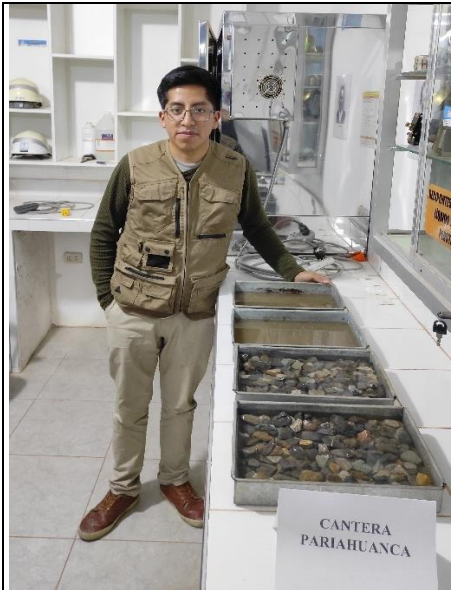
Foto 23: Saturación por 24hrs de los agregados, para el cálculo del peso específico
