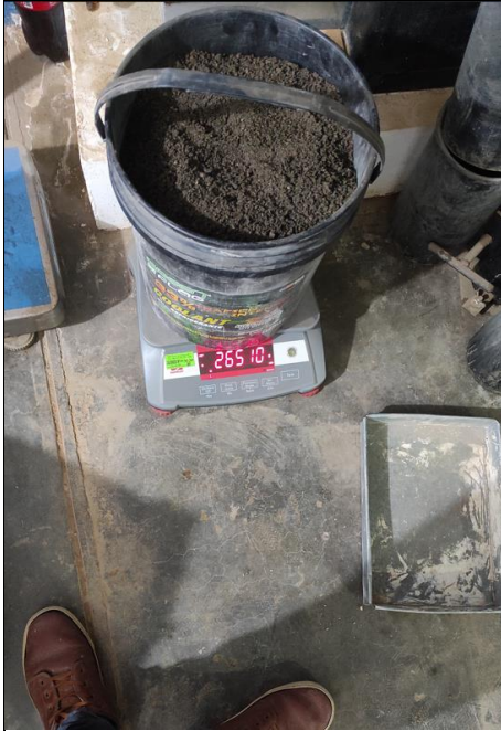
Foto 35: Pesado del agregado fino según el diseño de mezcla
