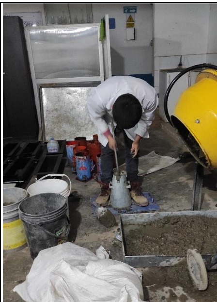
Foto 41: Prueba del cono de Abrams
