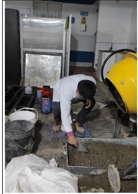
Foto 40: Vaciado de la mezcla de prueba
