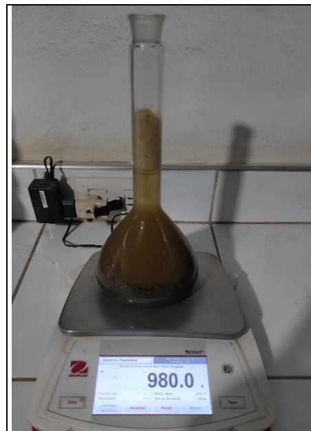
Foto 28: Pesaje del picnómetro más la muestra sin burbujas de aire
