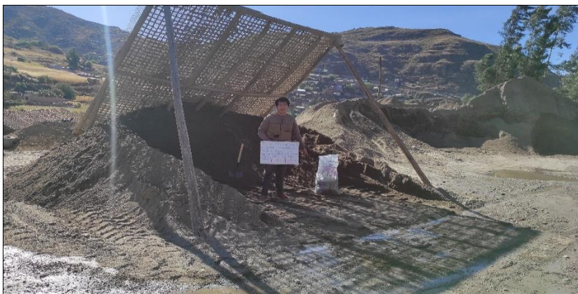
Foto 6: Muestreo del agregado fino de la cantera Tacllan
