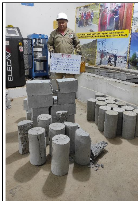
Foto 58: Ensayo de resistencia a la compresión
