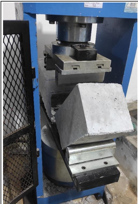
Foto 61: Fallo a flexión de las vigas
