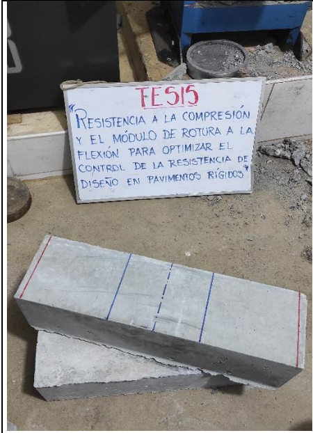
Foto 59: Señalización a los tercios de la viga de concreto
