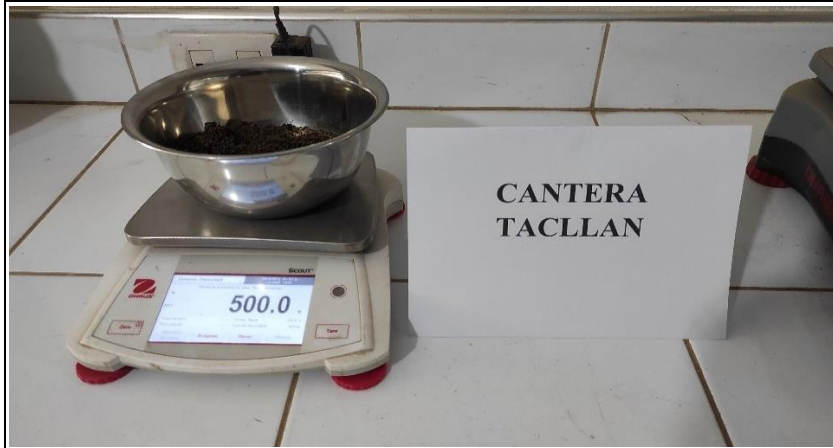
Foto 10: Peso del agregado fino, para el cálculo de la humedad
