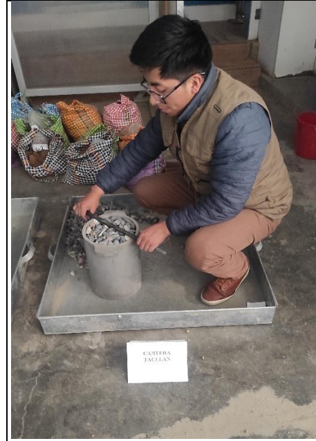
Foto 22: Enrasado del agregado grueso compactado
