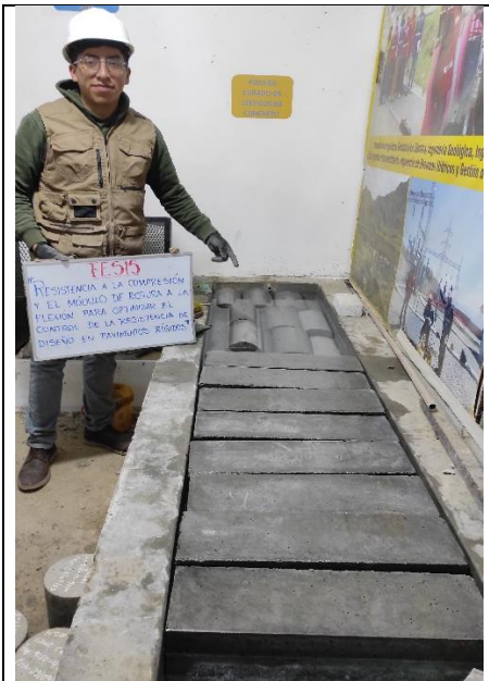
Foto 53: Curado de las probetas y vigas de concreto
