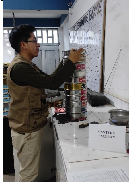
Foto 17: Tamizado del agregado grueso
