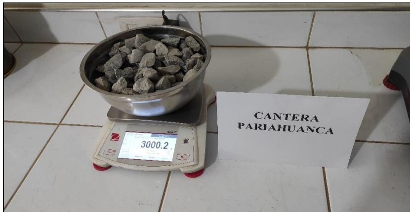
Foto 8: Peso del agregado grueso, para el cálculo de la humedad
