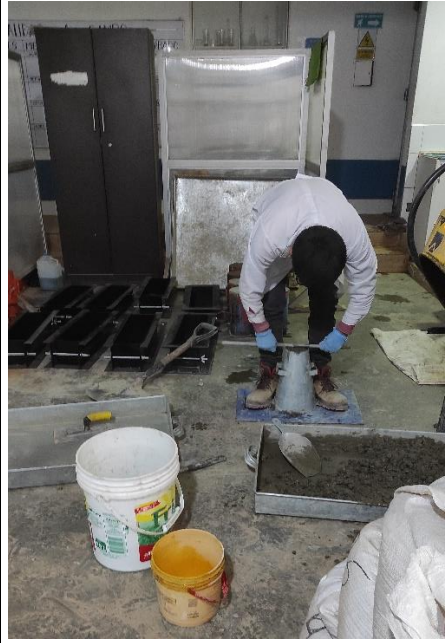
Foto 43: Prueba del cono de Abrams final
