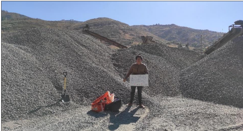
Foto 5: Muestreo del agregado grueso de la cantera Tacllan
