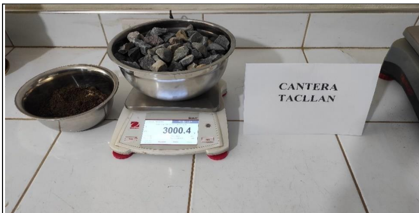
Foto 12: Peso seco de agregados, para el cálculo de la humedad
