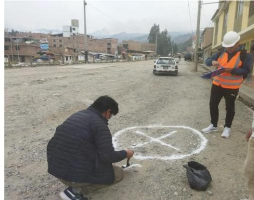
Foto 20: identificación del punto de extracción de la calicata C-1
