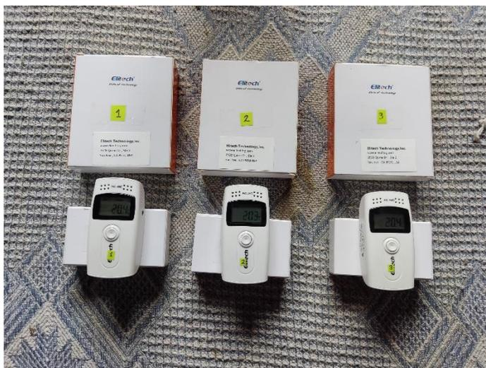
La toma de datos de temperatura y humedad se realizó mediante el uso de 3 Dataloggers de temperatura y humedad. Estos dispositivos tienen la capacidad de medir
