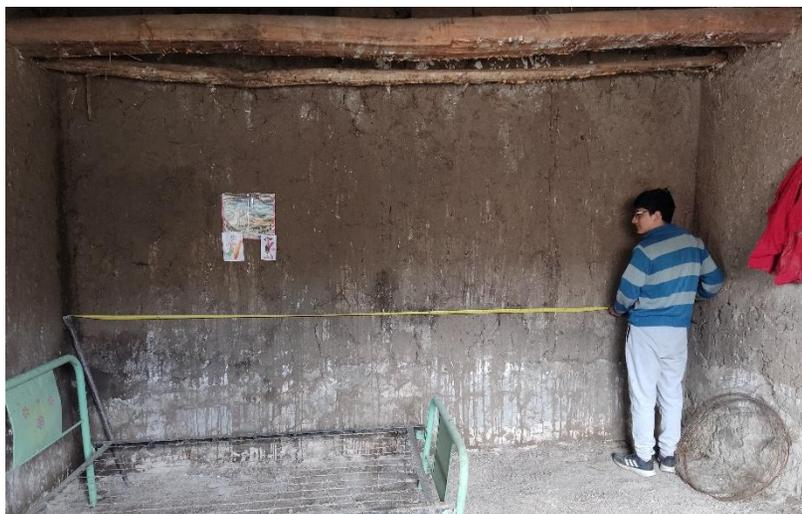
Posteriormente, se procedió a instalar los instrumentos de medición de temperatura y humedad en tres ubicaciones estratégicas. Uno de estos medidores se colocó en el centro de la habitación, otro en el centro del baño y el tercero se ubicó en una estructura específica diseñada para protegerlo de la lluvia y el sol, al mismo tiempo que se expusiera a corrientes
