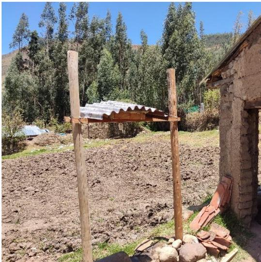
Siguiendo las recomendaciones del distribuidor, estos instrumentos deben colocarse en lugares alejados de la exposición directa al sol. Además, para realizar mediciones de temperatura exterior, es necesario ubicarlos en lugares donde reciban corrientes de aire desde todas las direcciones. Por esta razón, para este trabajo de investigación, se construyó una estructura que albergará al instrumento encargado de tomar medidas del exterior. Esta estructura cumple con la condición de no verse afectada
