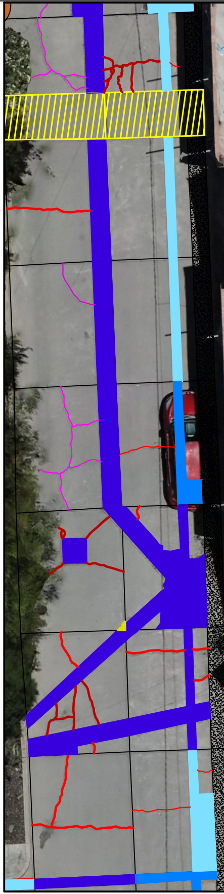
IDENTIFICACION DE DAÑOS
