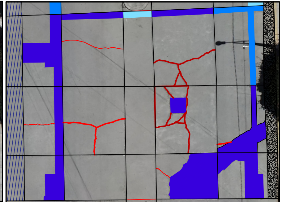
IDENTIFICACION DE DAÑOS C-02
