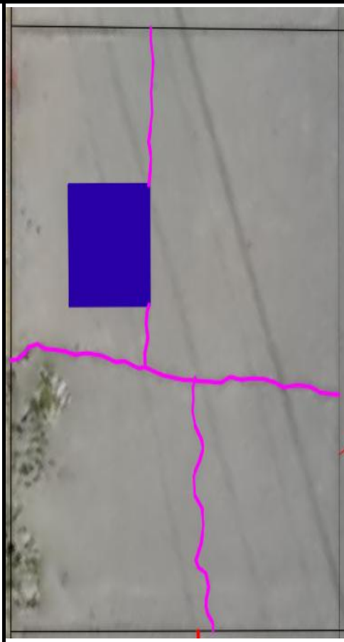
Daños: Parche grande de severidad alta y losa dividida de severidad media (29H y 23M)
