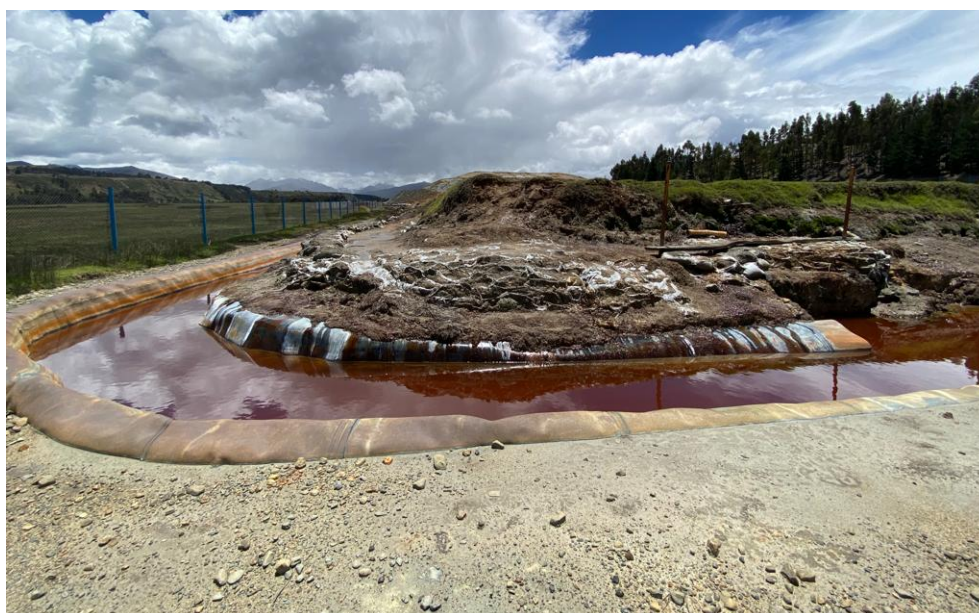
Figura 13 Punto de recolección del drenaje ácido de mina del relave minero - Mesapata
