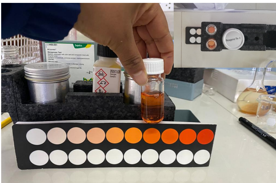
Figura 17 Medición de la concentración de hierro del DAM tratado con orina hidrolizada.
