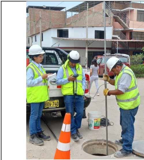
Fotografía N°07. Se toman las medidas de las velocidades iniciales y características del colector.
