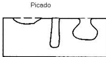
Fig. 3. Muestra la corrosión por picado
