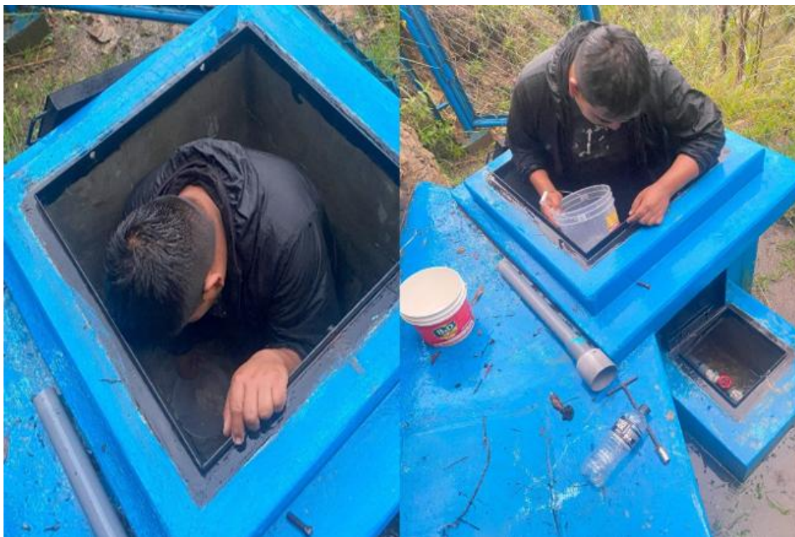
Foto N° 3 Aforo de caudal de ingreso al reservorio
