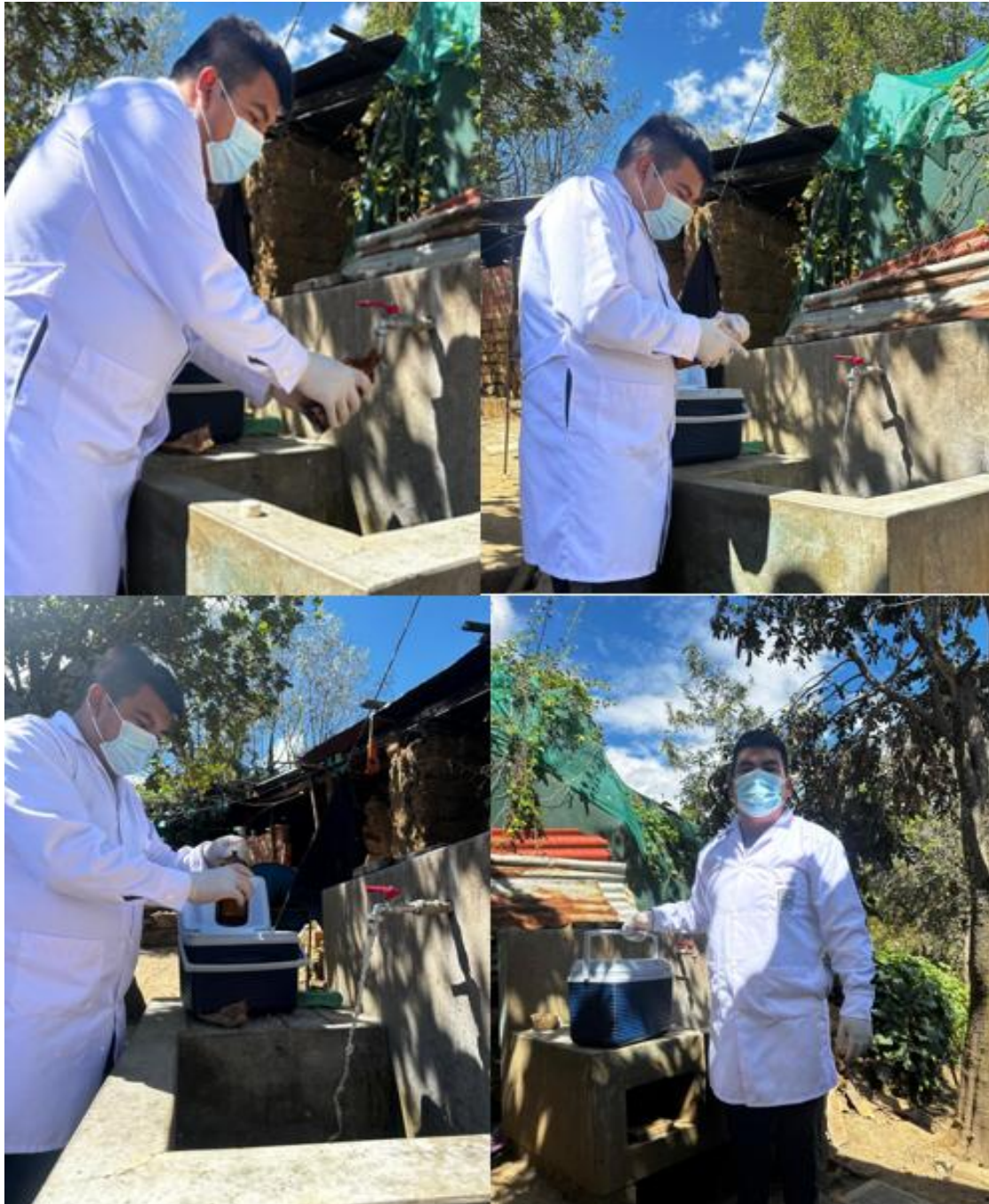
Foto N° 12 : Toma de muestra realizada según protocolos para análisis de coliformes fecales y torales
