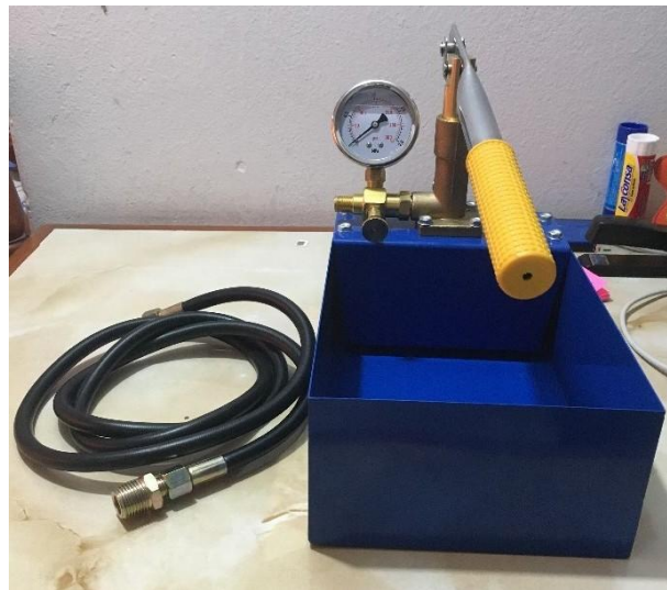
Foto N° 08: Vista del Balde de Prueba Hidráulica de Alta Presión.
