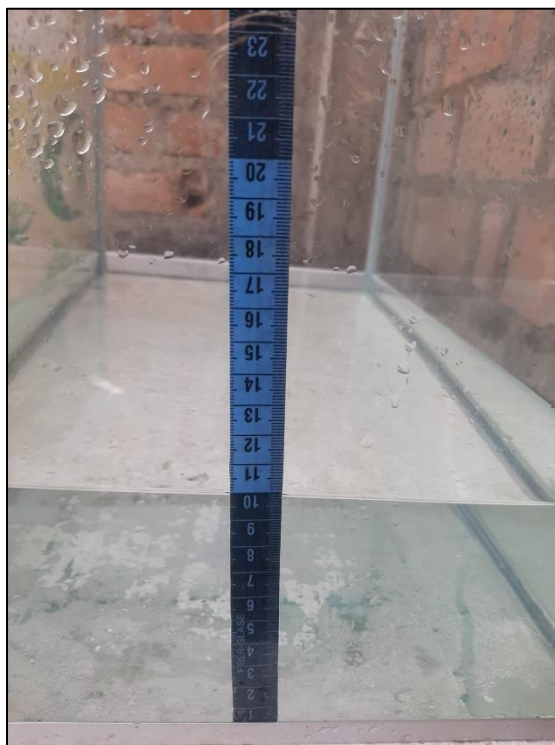
Figura 29 Contenedor de vidrio de 0.50 m x 0.30 m, para aforo de caudal
