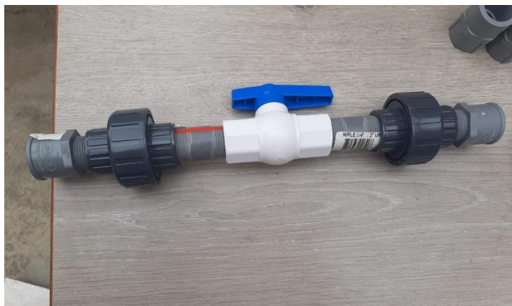
Figura 16 Válvula de control PVC roscada diámetro 3/4" - Punto A
