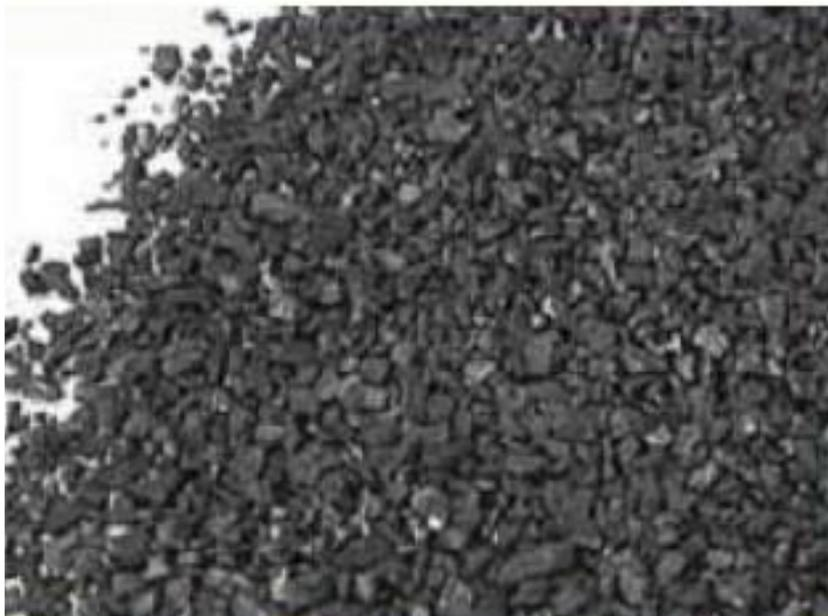
Figura N°7 Medio filtrante Carbón activado
