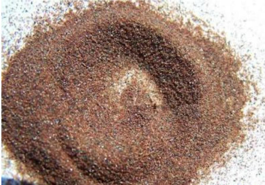
Figura N°8 Medio filtrante Granate
