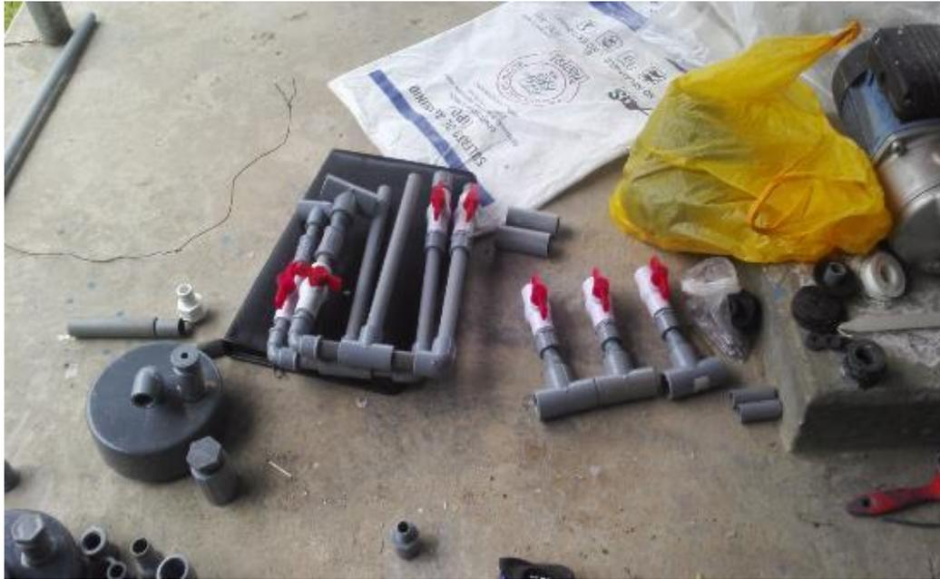
Fotografía N° 12 Materiales utilizados para la construcción del filtro piloto
