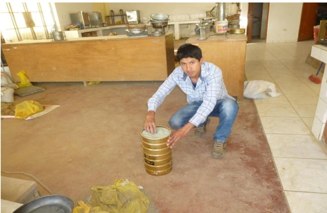
Fotografía N° 16 Determinación de la granulometría del medio filtrante
