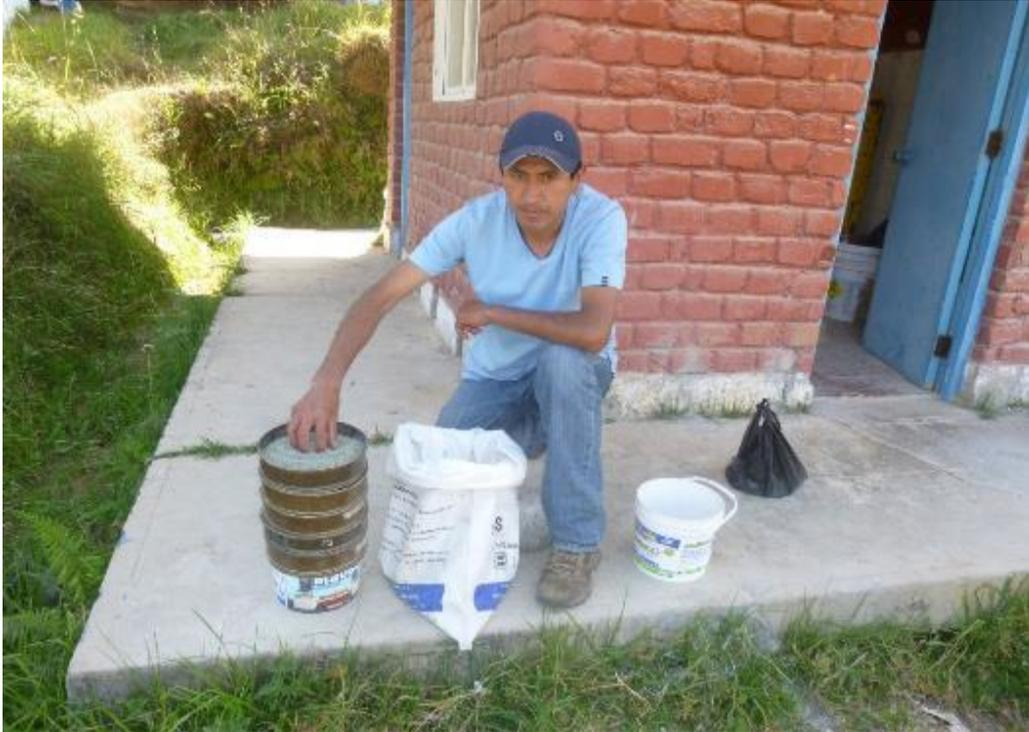
Fotografía N° 9 Tamizado de la zeolita natural
