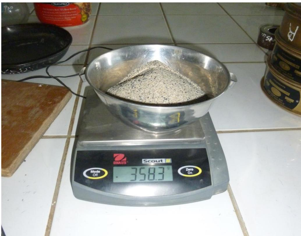
Fotografía N° 7 Peso de la muestra del medio filtrante.
