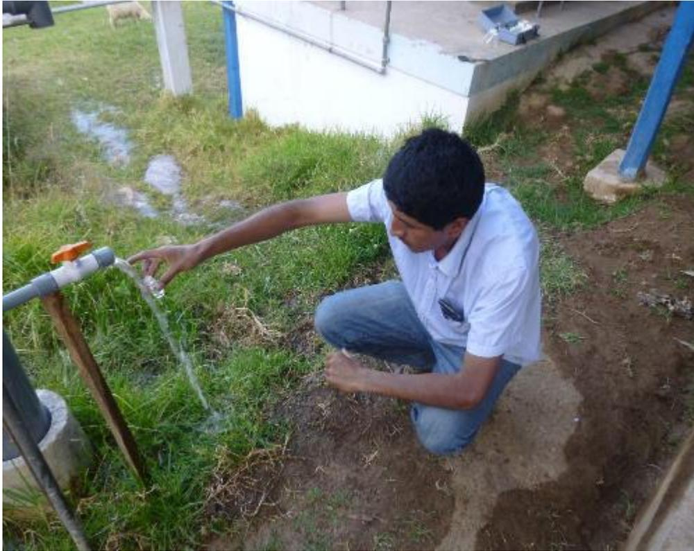
Fotografía N° 14 Toma de muestra de agua a la salida del filtro piloto.
