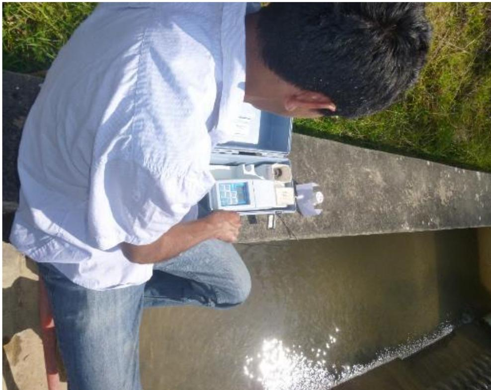
Fotografía N° 2 Toma de muestra de la salida del agua decantada
