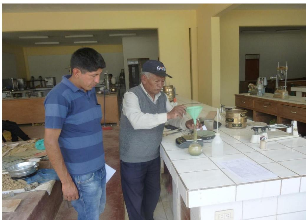
Fotografía N° 8 Realizando el ensayo de peso específico del medio filtrante
