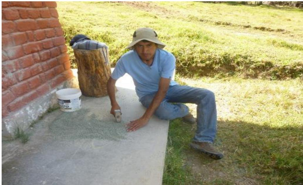
Fotografía N° 8 Trituración de la zeolita natural
