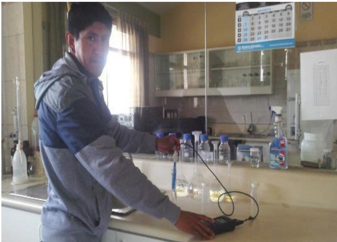
Fotografía N° 6 Medición del PH y temperatura del agua
