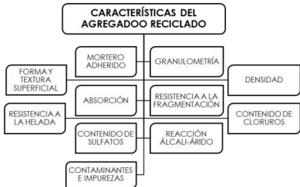
Figura IV-3 Características del Agregado Reciclado
