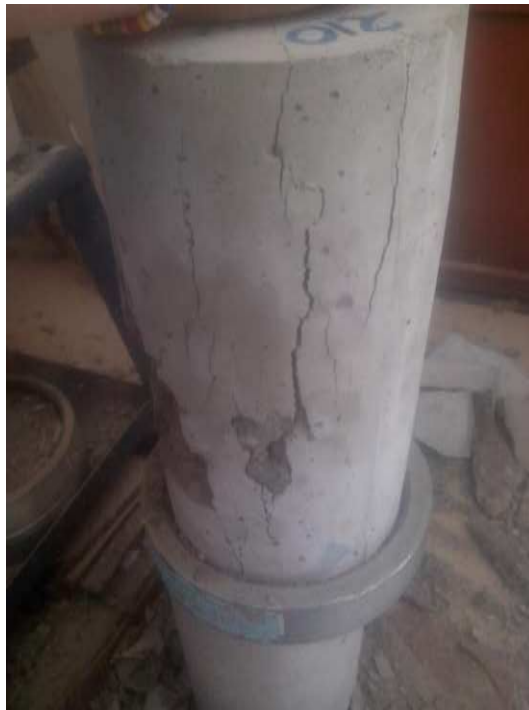
Figura A 15 Briqueta ensayada de f'_c = 210 \text{ kg/cm}^2
