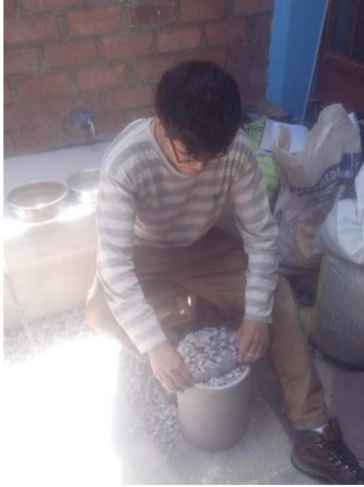
Figura A 7 Enrasado de la superficie a nivel de la parte superior del recipiente, en el ensayo de peso unitario suelto.
