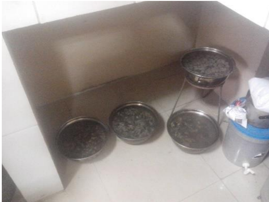
Figura A 5 Saturación de las 4 dosificaciones de agregados en estudio
