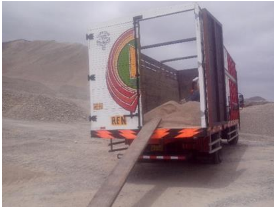
Figura A 3 Adquisición del Agregado Fino Natural (Arena Gruesa) y Agregado Grueso Natural (Piedra Zarandeada) en la misma Cantera Río Seco, y colocación en el camión.
