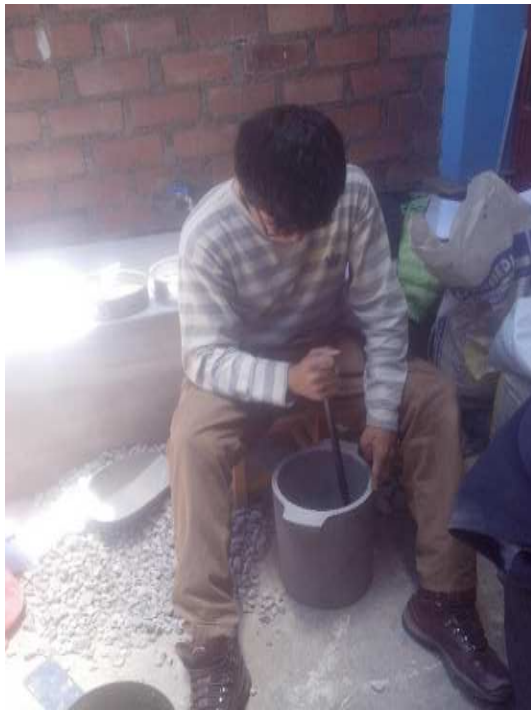
Figura A 8 Apisonado con la varilla a un tercio del volumen del recipiente, en el ensayo de peso unitario compactado.
