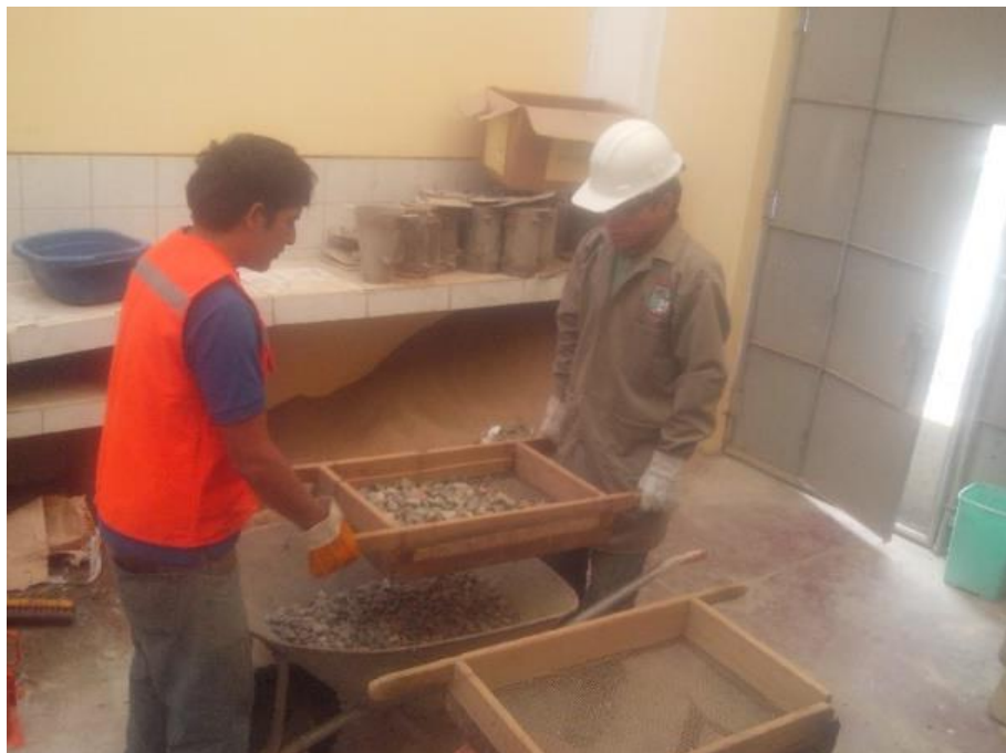
Figura A 10 Zarandeo del agregado grueso reciclado, con la finalidad de reducir la cantidad de polvo que presenta.
