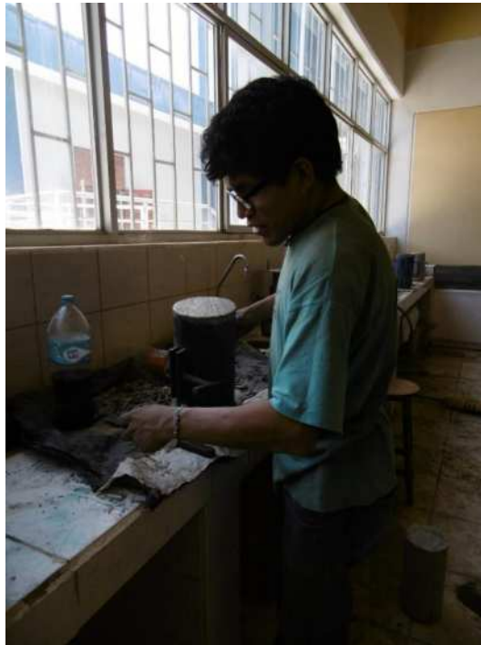
Figura A 13 Desencofrado de Briquetas
