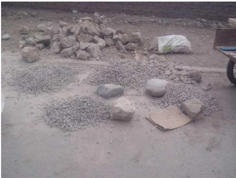
Figura A - 2 Obtención del Agregado Grueso Reciclado
