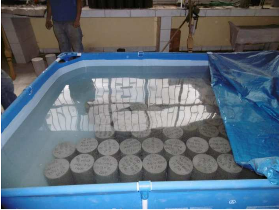
Figura A 14 Curado de Briquetas
