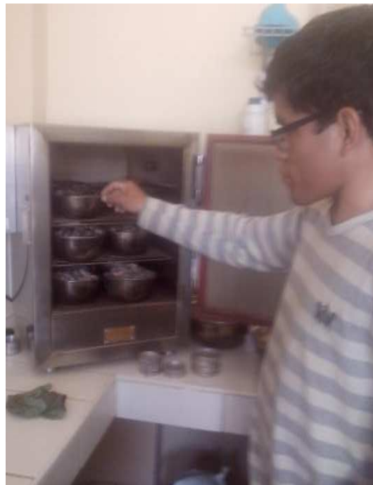
Figura A 6 Muestras llevadas al horno para su secado
