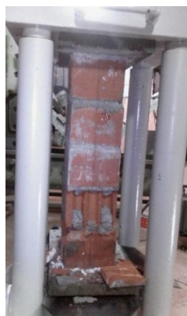
Figura E.68 Ensayo de compresión de prismas muestra L-1.
