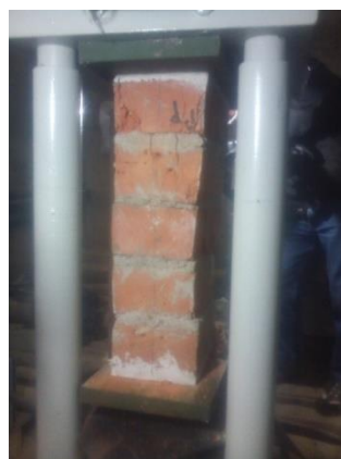
Figura E.8 Ensayo de compresión de prismas muestra B-1
