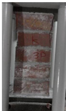
Figura E.66 Ensayo de compresión de prismas muestra K-3.
