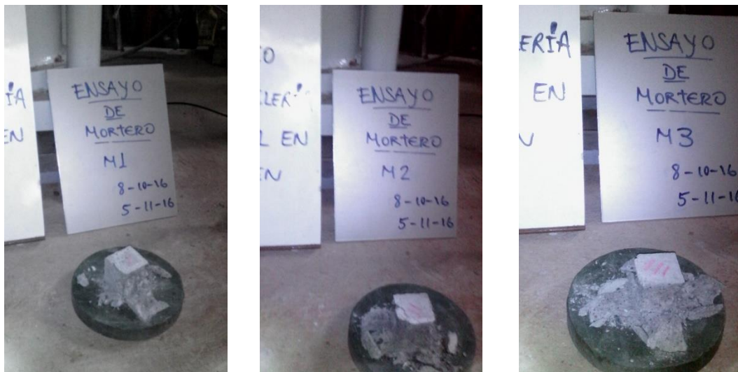
Figura A.5 Ensayo de compresión de mortero muestra 5.
