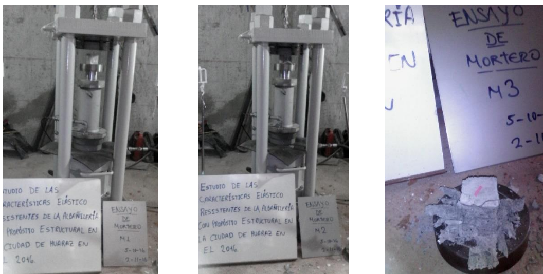
Figura A.3 Ensayo de compresión de mortero muestra 3.
