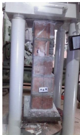
Figura E.62 Ensayo de compresión de prismas muestra K-1.
