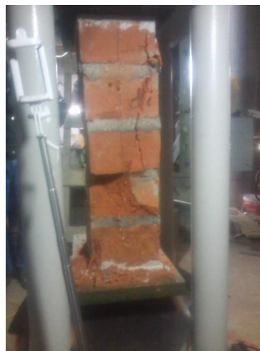
Figura D.2 Ensayo de compresión de prismas muestra B-2.
