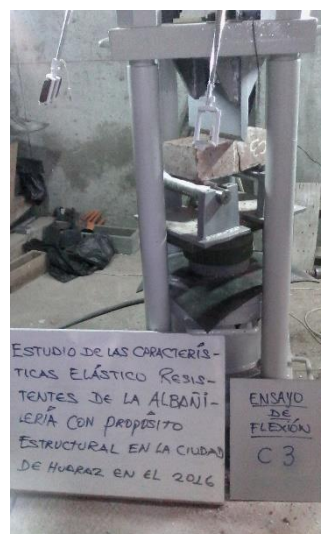
Figura C.3 Ensayo de flexión de la unidad muestra C-3.
