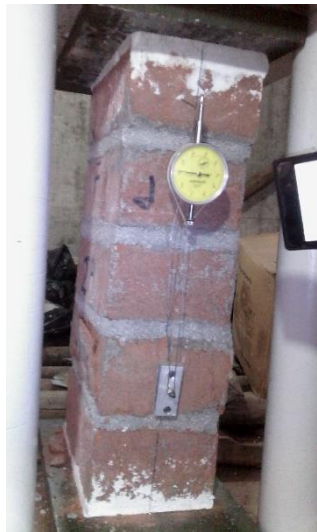
Figura E.34 Ensayo de compresión de prismas muestra F-2.
