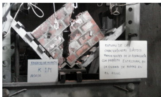
Figura G.62 Ensayo de compresión diagonal de murete K-1.
