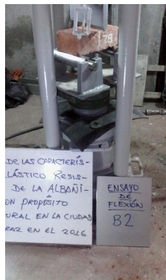
Figura C.2 Ensayo de flexión de la unidad muestra B-2.
