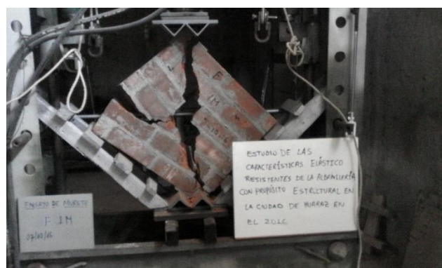
Figura G.32 Ensayo de compresión diagonal de murete F-1.
