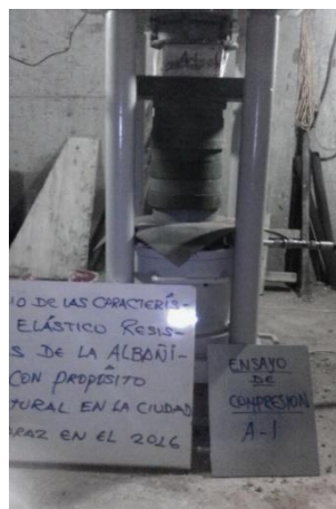
Figura B.1 Ensayo de compresión de la unidad muestra A-1.
