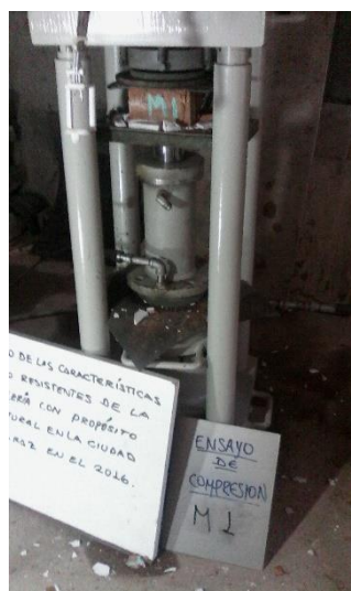
Figura B.13 Ensayo de compresión de la unidad muestra M-1.
