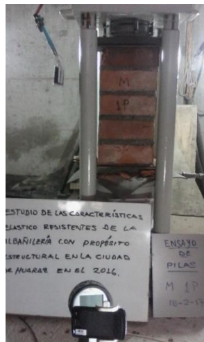
Figura D.13 Ensayo de compresión de prismas muestra M-1.
