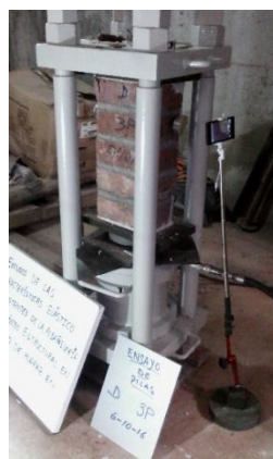
Figura E.24 Ensayo de compresión de prismas muestra D-3
