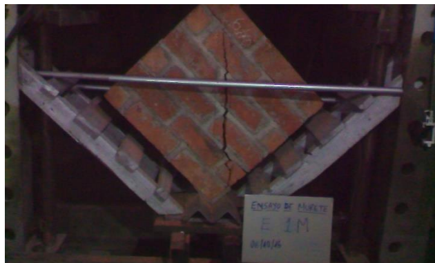
Figura G.26 Ensayo de compresión de diagonal de murete E-1.
