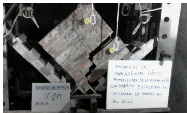
Figura G.56 Ensayo de compresión diagonal de murete J-1.
