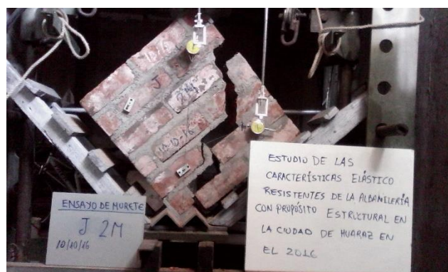
Figura G.58 Ensayo de compresión diagonal de murete J-2.
