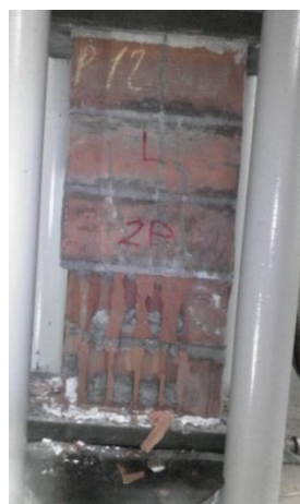
Figura E.70 Ensayo de compresión de prismas muestra L-2.
