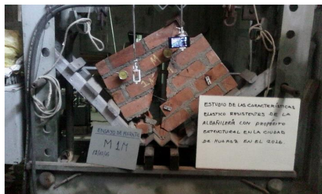
Figura G.74 Ensayo de compresión diagonal de murete M-1.
