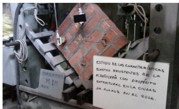
Figura F.13 Ensayo de compresión diagonal de murete M-1.
