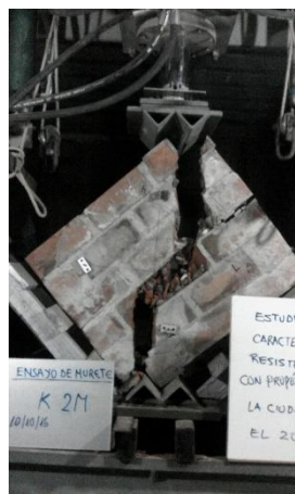
Figura F.11 Ensayo de compresión diagonal de murete K-2.
