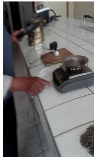
Figura A.1 Ensayo de granulometría de la arena gruesa.
