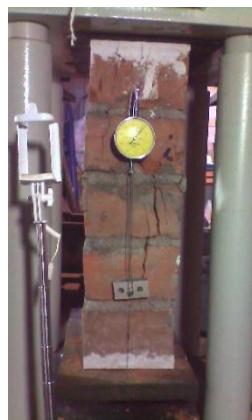
Figura E.14 Ensayo de compresión de prismas muestra C-1
