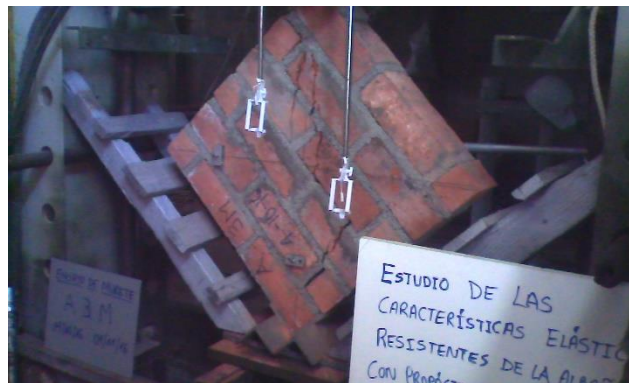
Figura G.6 Ensayo de compresión de diagonal de murete A-3.
