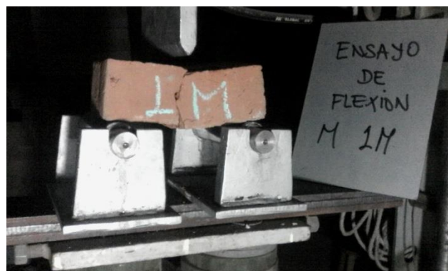
Figura C.13 Ensayo de flexión de la unidad muestra M-1.
