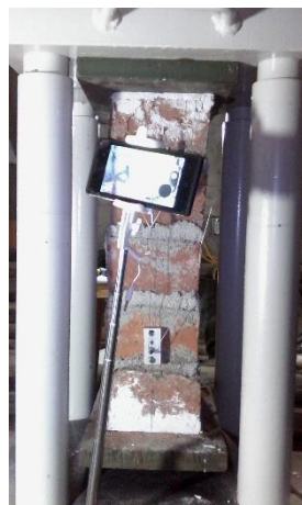
Figura E.20 Ensayo de compresión de prismas muestra D-1
