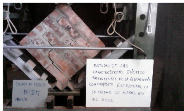
Figura F.8 Ensayo de compresión diagonal de murete H-2.
