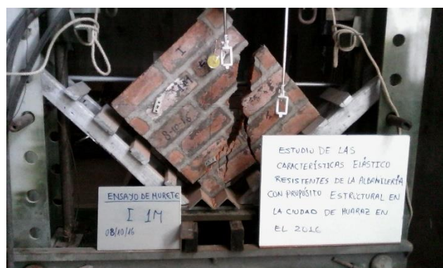
Figura G.50 Ensayo de compresión diagonal de murete I-1.
