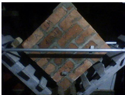
Figura G.2 Ensayo de compresión diagonal de murete A-1.
