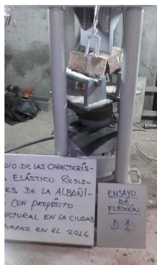
Figura C.4 Ensayo de flexión de la unidad muestra D-1.
