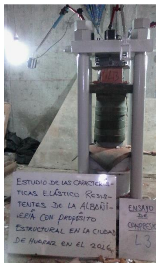
Figura B.12 Ensayo de compresión de la unidad muestra L-3.
