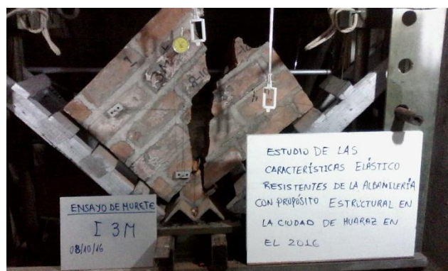
Figura G.54 Ensayo de compresión diagonal de murete I-3.
