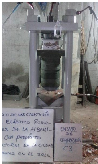
Figura B.3 Ensayo de compresión de la unidad muestra C-3.
