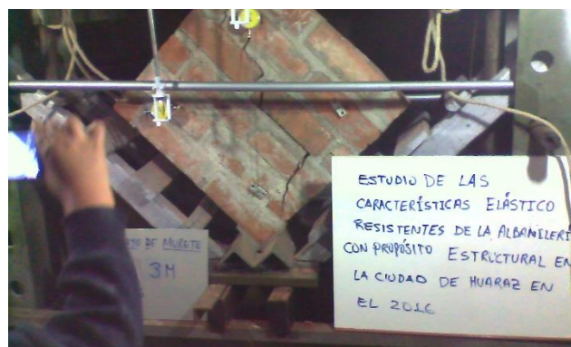
Figura F.6 Ensayo de compresión diagonal de murete F-3.
