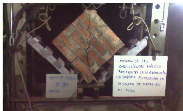
Figura G.38 Ensayo de compresión diagonal de murete G-1.
