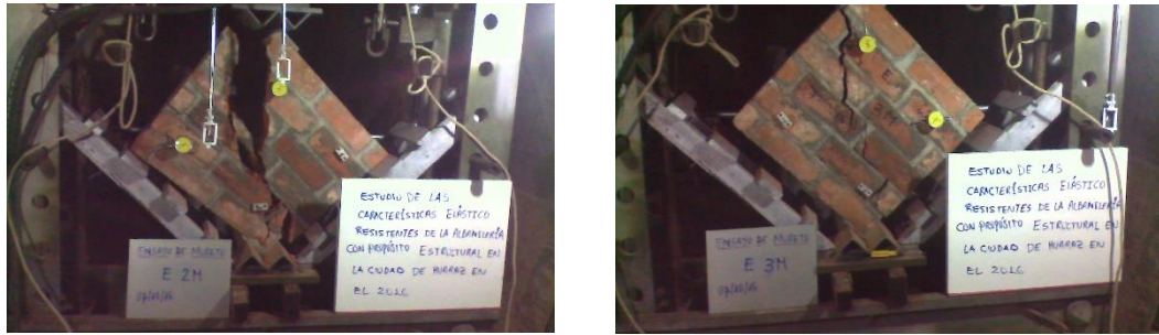
Figura 4.15 Instrumentación para el análisis de la elasticidad de muretes.
