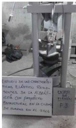
Figura C.6 Ensayo de flexión de la unidad muestra F-3.
