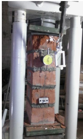
Figura E.76 Ensayo de compresión de prismas muestra M-2.
