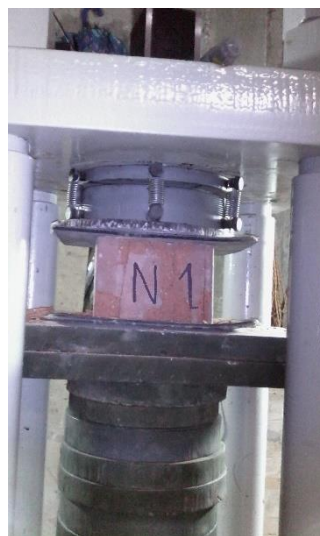
Figura B.14 Ensayo de compresión de la unidad muestra N-1.
