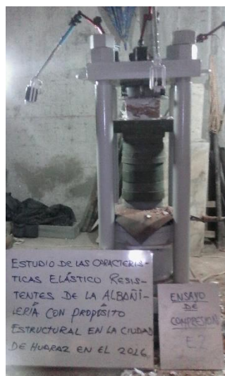
Figura B.5 Ensayo de compresión de la unidad muestra E-2.
