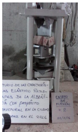
Figura C.11 Ensayo de flexión de la unidad muestra K-2.
