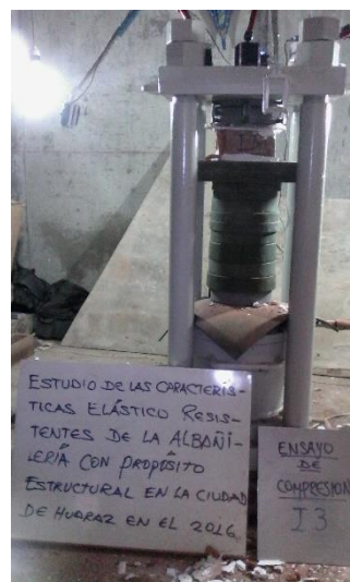
Figura B.9 Ensayo de compresión de la unidad muestra I-3.
