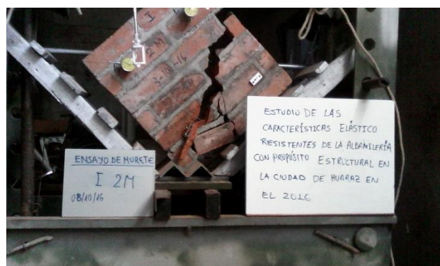
Figura G.52 Ensayo de compresión diagonal de murete I-2.
