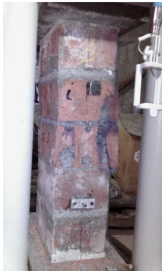
Figura E.64 Ensayo de compresión de prismas muestra K-2.
