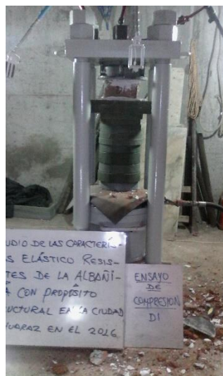
Figura B.4 Ensayo de compresión de la unidad muestra D-1.
