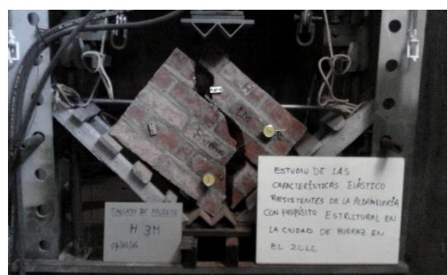
Figura G.44 Ensayo de compresión diagonal de murete H-1.
