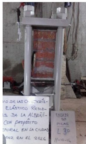
Figura D.12 Ensayo de compresión de prismas muestra L-3.
