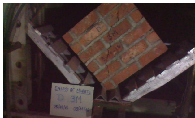
Figura G.24 Ensayo de compresión de diagonal de murete D-3.
