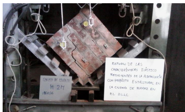
Figura G.46 3 Ensayo de compresión diagonal de murete H-2.
