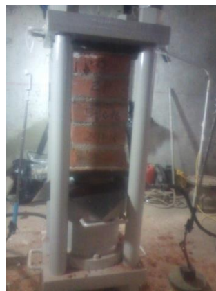
Figura E.10 Ensayo de compresión de prismas muestra B-2
