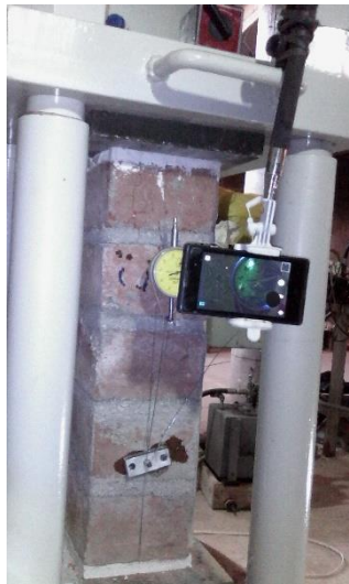
Figura E.48 Ensayo de compresión de prismas muestra H-3.
