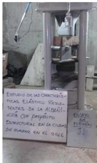
Figura C.10 Ensayo de flexión de la unidad muestra J-1.
