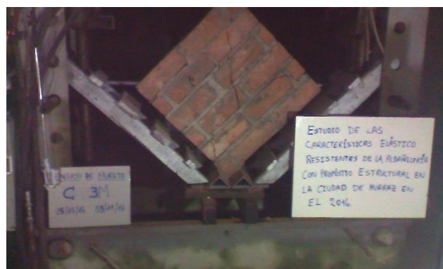
Figura F.3 Ensayo de compresión diagonal de murete C-3.
