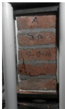
Figura E.6 Ensayo de compresión de prismas muestra A-3
