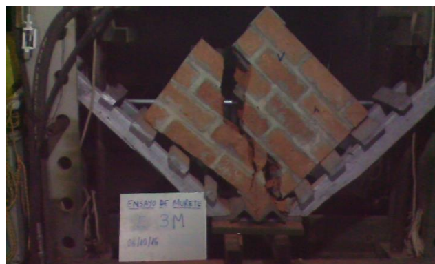
Figura G.30 Ensayo de compresión diagonal de murete E-3.
