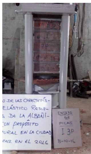
Figura D.9 Ensayo de compresión de prismas muestra I-3.
