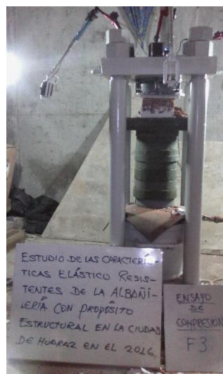
Figura B.6 Ensayo de compresión de la unidad muestra F-3.
