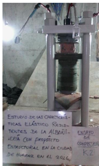
Figura B.11 Ensayo de compresión de la unidad muestra K-2.
