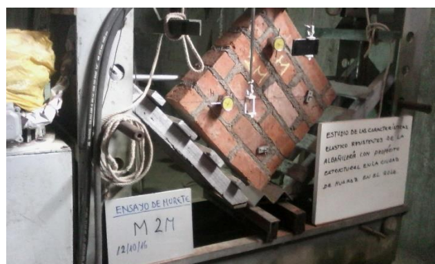
Figura G.76 Ensayo de compresión diagonal de murete M-2.
