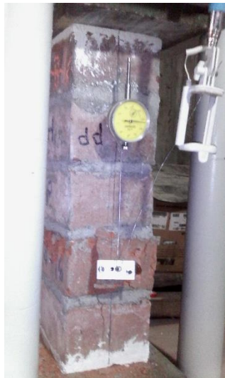
Figura E.46 Ensayo de compresión de prismas muestra H-2.
