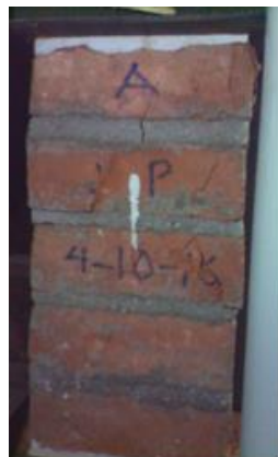
Figura D.1 Ensayo de compresión de prismas muestra A-1.
