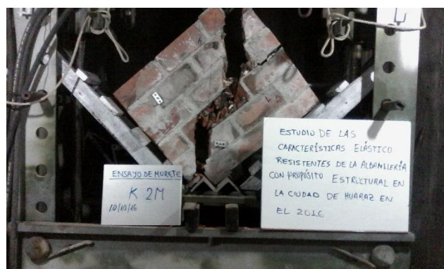
Figura G.64 Ensayo de compresión diagonal de murete K-2.
