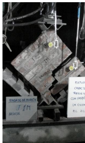
Figura F.10 Ensayo de compresión diagonal de murete J-1.
