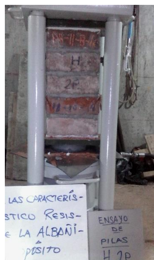
Figura D.8 Ensayo de compresión de prismas muestra H-2.
