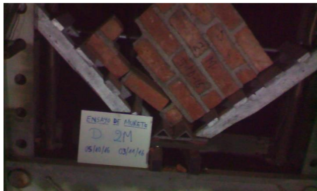
Figura G.22 Ensayo de compresión de diagonal de murete D-2.
