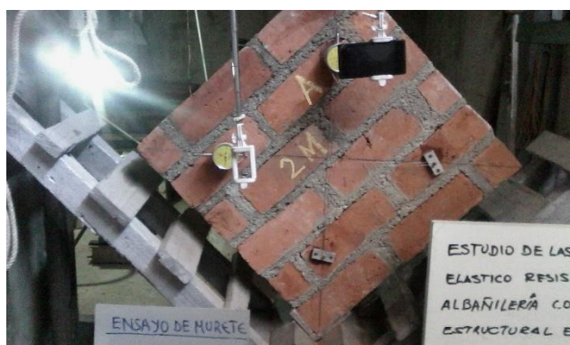
Figura G.4 Ensayo de compresión diagonal de murete A-2.
