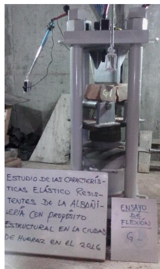
Figura C.7 Ensayo de flexión de la unidad muestra G-1.
