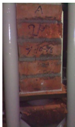
Figura E.4 Ensayo de compresión de prismas muestra A-2
