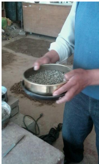
Figura A.1 Ensayo de granulometría de la arena gruesa.
