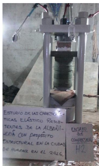
Figura B.8 Ensayo de compresión de la unidad muestra H-2.
