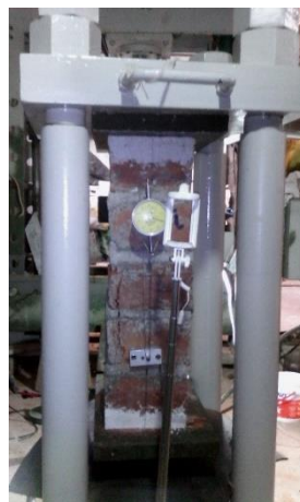
Figura E.22 Ensayo de compresión de prismas muestra D-2
