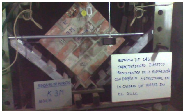
Figura G.66 Ensayo de compresión diagonal de murete K-3.
