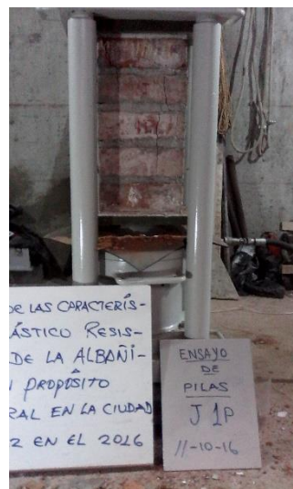
Figura D.10 Ensayo de compresión de prismas muestra J-1.
