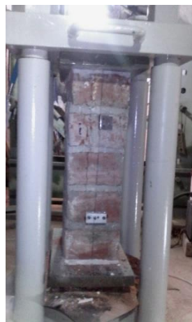
Figura E.60 Ensayo de compresión de prismas muestra J-3.
