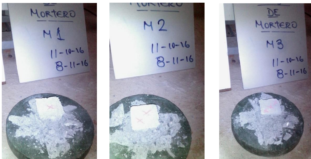
Figura A.7 Ensayo de compresión de mortero muestra 7.
