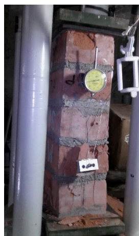
Figura E.78 Ensayo de compresión de prismas muestra M-3.
