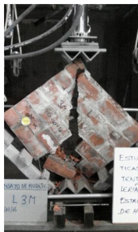
Figura F.12 Ensayo de compresión diagonal de murete L-3.
