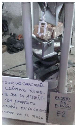
Figura C.5 Ensayo de flexión de la unidad muestra E-2.
