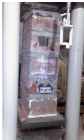
Figura E.54 Ensayo de compresión de prismas muestra I-3.
