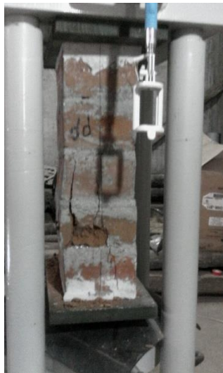
Figura E.38 Ensayo de compresión de prismas muestra G-1.
