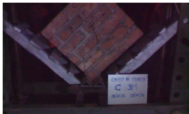
Figura G.18 Ensayo de compresión de diagonal de murete C-3.
