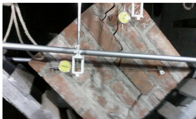
Figura G.36 Ensayo de compresión diagonal de murete F-3.
