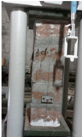
Figura E.42 Ensayo de compresión de prismas muestra G-3.
