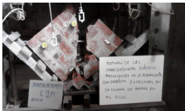
Figura G.70 Ensayo de compresión diagonal de murete L-2.
