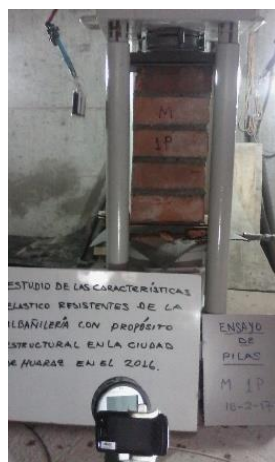
Figura E.74 Ensayo de compresión de prismas muestra M-1.
