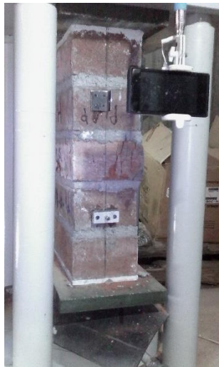
Figura E.44 Ensayo de compresión de prismas muestra H-1.
