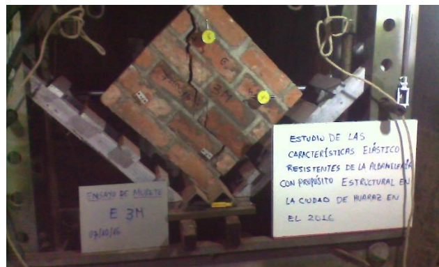
Figura G.42 Ensayo de compresión diagonal de murete G-3.
