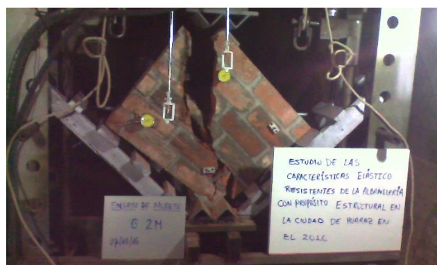
Figura G.40 Ensayo de compresión diagonal de murete G-2.
