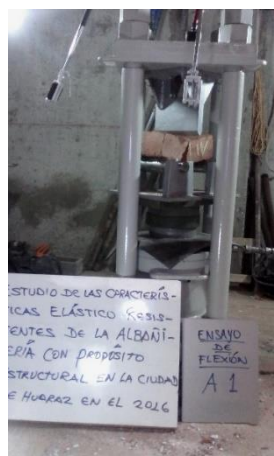
Figura C.1 Ensayo de flexión de la unidad muestra A-1.
