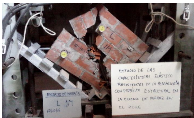
Figura G.68 Ensayo de compresión diagonal de murete L-1.
