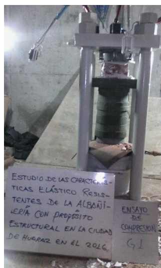
Figura B.7 Ensayo de compresión de la unidad muestra G-1.
