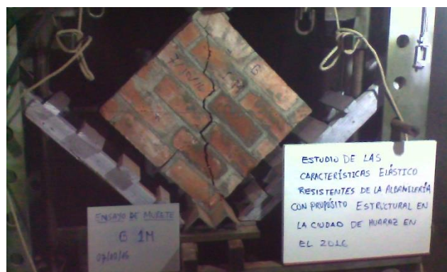
Figura F.7 Ensayo de compresión diagonal de murete G-1.
