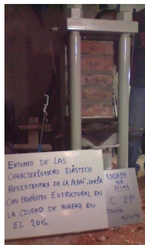
Figura D.3 Ensayo de compresión de prismas muestra C-3.
