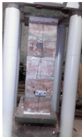
Figura E.58 Ensayo de compresión de prismas muestra J-2.
