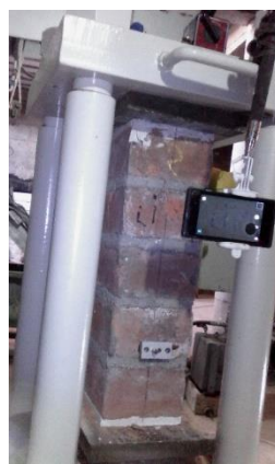
Figura E.50 Ensayo de compresión de prismas muestra I-1.
