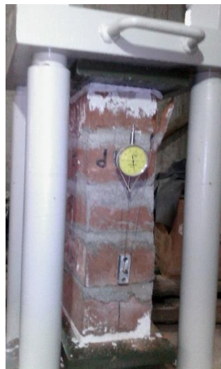
Figura E.36 Ensayo de compresión de prismas muestra F-3.
