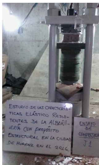
Figura B.10 Ensayo de compresión de la unidad muestra J-1.
