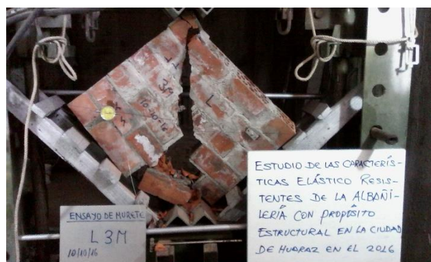
Figura G.72 Ensayo de compresión diagonal de murete L-3.
