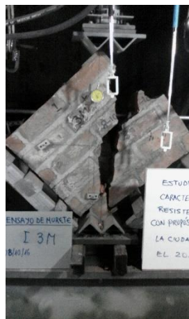
Figura F.9 Ensayo de compresión diagonal de murete I-3.
