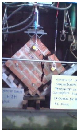
Figura G.34 Ensayo de compresión diagonal de murete F-2.
