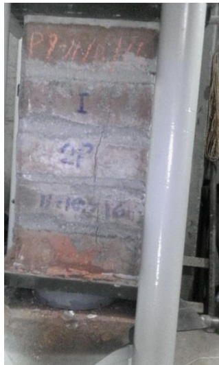
Figura E.52 Ensayo de compresión de prismas muestra I-2.
