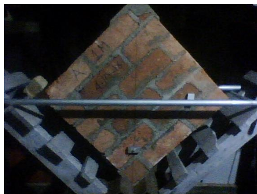
Figura F.1 Ensayo de compresión diagonal de murete A-1.
