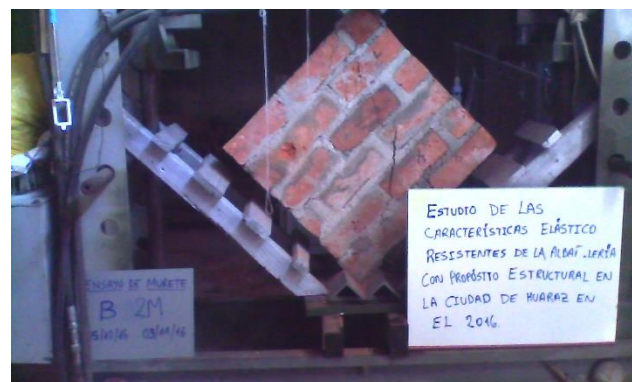
Figura F.2 Ensayo de compresión diagonal de murete B-2.
