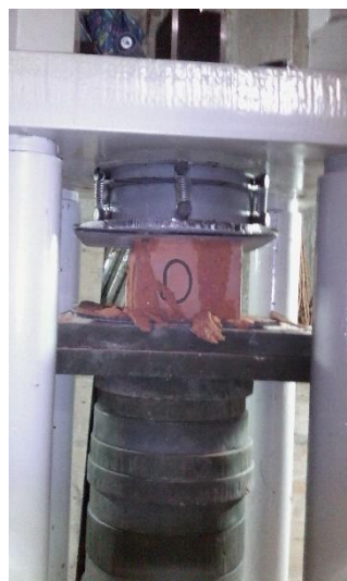
Figura B.15 Ensayo de compresión de la unidad muestra O-1.
