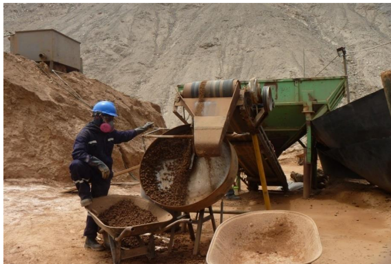
Foto N° 02: Peletizado de mineral relaves de agitación
