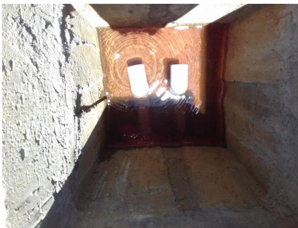
**Fotografía 48.** Salida del trazador en la caja de recolección del HFSSV.
