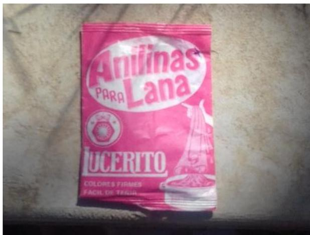
**Fotografía 46.** Trazador utilizado para medir el TRH del HFSSV.
