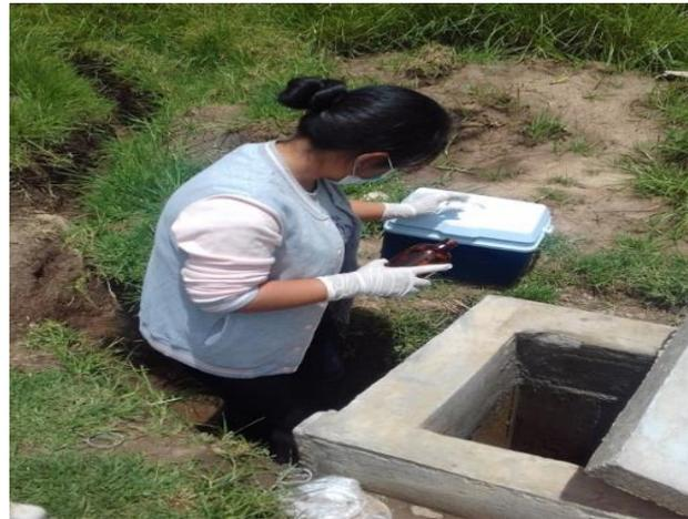
**Fotografía 60.** Toma de muestra para el análisis de coliformes totales y fecales en la salida del HFSSV (caja de recolección).
