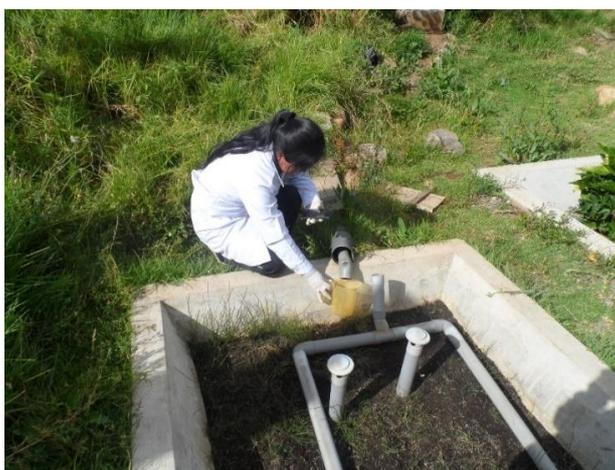
**Fotografía 49.** Medición del caudal en la entrada del HFSSV.
