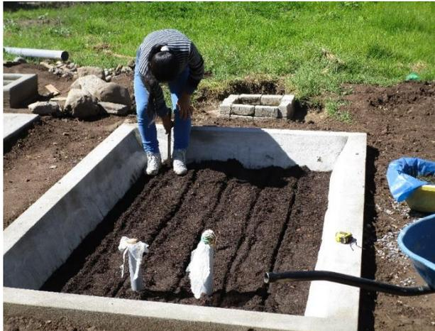
**Fotografía 33.** Medición cada 0.20 m en el ancho dentro del HFSSV.
