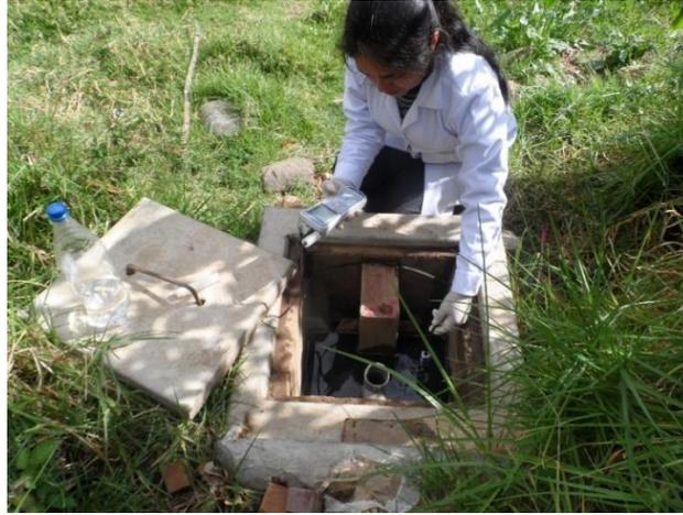
**Fotografía 56.** Medición del pH en el segundo vertedero, entrada del humedal.
