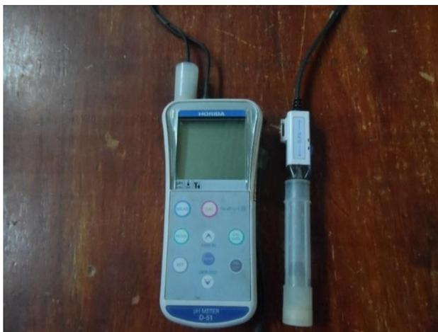
**Fotografía 55.** Equipo de pHmetro usado.
