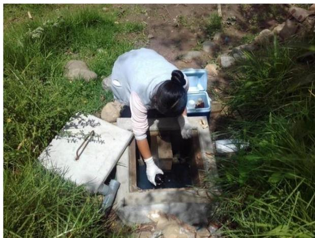
**Fotografía 58.** Toma de muestra para el análisis de CT y CF en la entrada del HFSSV (segundo vertedero).
