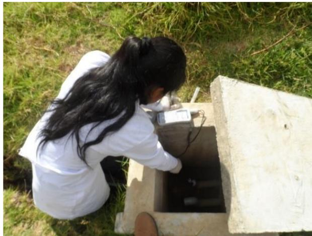
**Fotografía 57.** Medición del pH en la caja de drenaje proveniente del HFSSV.
