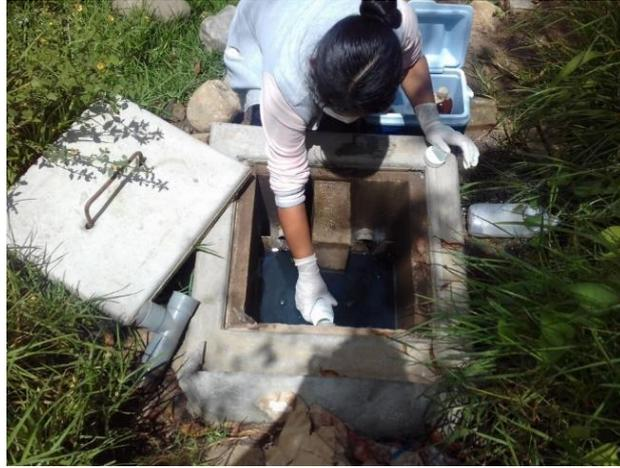
**Fotografía 59.** Toma de muestra para el análisis de DBO5 en la entrada del HFSSV (segundo vertedero).
