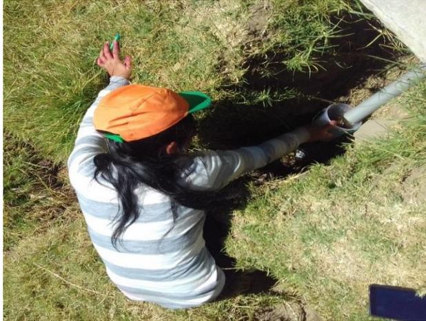
**Fotografía 50.** Medición del caudal en la salida de la caja de recolección del HFSSV.
