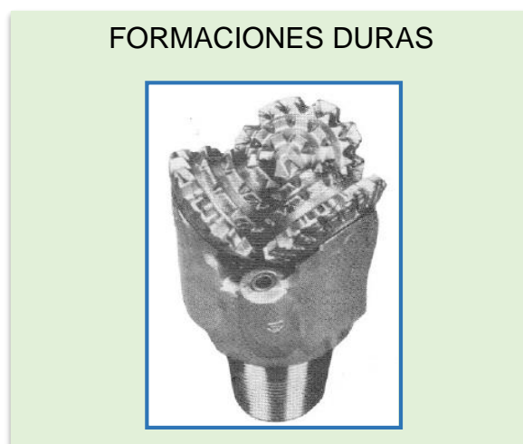
Figura N° 20: Tricono para formaciones duras
