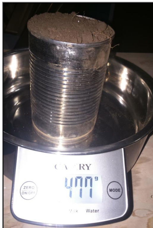
Fotografía N° 22: Pesado de muestra seca de suelo dentro del cilindro Uhland (Parcela N° 08 – Muestra 02: 25 a 50 cm)
