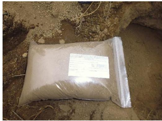
Excavación de hoyo de 30 cm, en la geoforma ladera de afloramiento lítico y extracción de muestra
