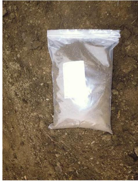
Excavación de hoyo de 30 cm, en la geoforma terraza y extracción de muestra
