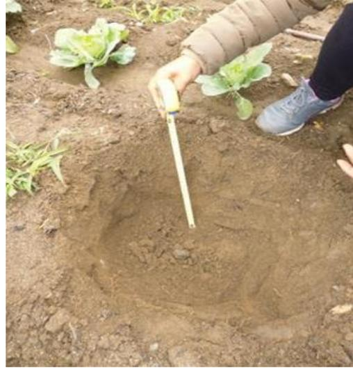
Excavación de hoyo de 30 cm, en la geoforma abanico aluvial
