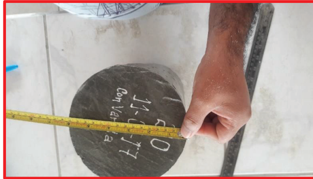
Fotografía 26: Se realizó la toma de las medidas de las Briquetas de concreto de 210 kg/cm 2 .
