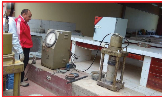
Fotografía 39: Rotura del concreto a compresión y la Medición de la Resistencia.
