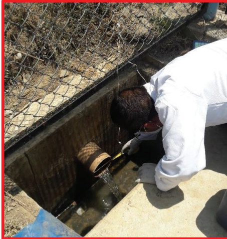
Fotografía 4: Medición del diámetro de la tubería y el tirante de ingreso del agua residual doméstico.
