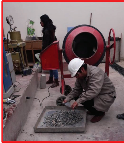
Fotografía 14: Preparación de los agregados para elaborar las Briquetas de concreto.
