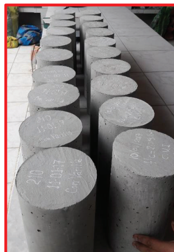
Fotografía 27: Se realizó la toma de los pesos de las briquetas después del secado.
