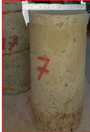
Fotografía 13: Coloración final después de la exposición al agua residual
