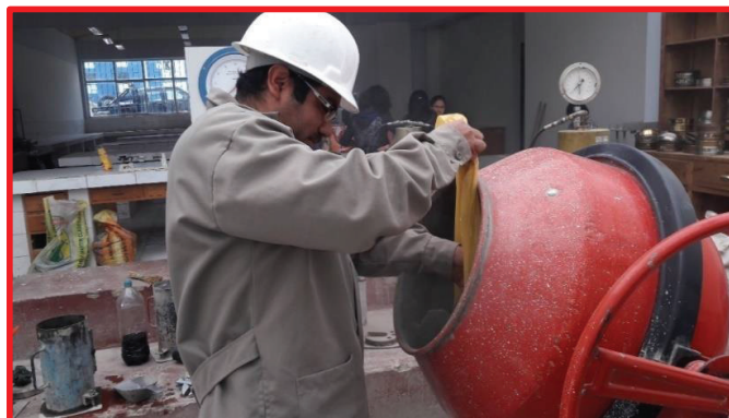
Fotografía 16: Adicionando el Cemento requerido según el Diseño de Mezcla.
