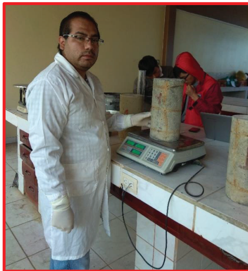
Fotografía 35: Pesado de las muestras luego de la exposición al agua residual.
