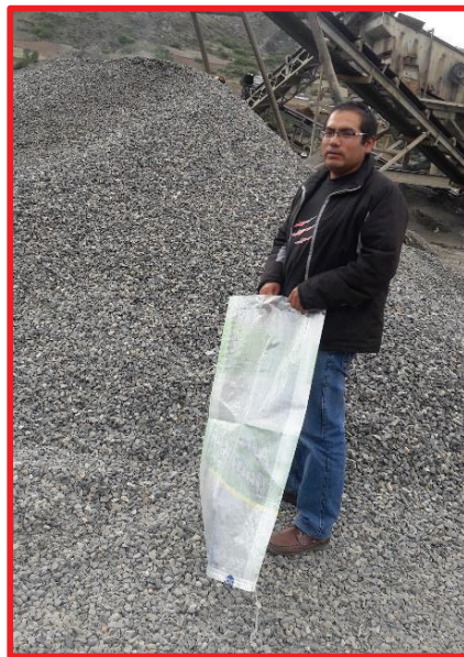
Fotografía 9: Recolección de muestra de la piedra chancada.
