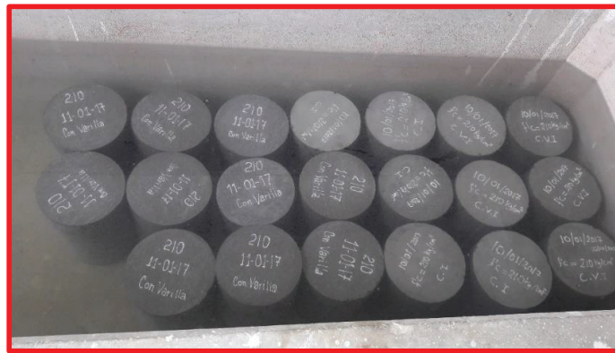
Fotografía 24: Curado según las indicaciones del método ACI por 07 días para obtener el 80 % de su resistencia.
