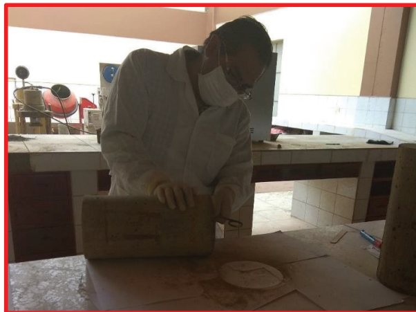
Fotografía 35: Pesado de las muestras luego de la exposición al agua residual.
