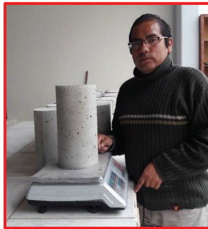
Fotografía 27: Se realizó la toma de los pesos de las briquetas después del secado.
