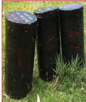
Fotografía 12: Coloración intermedia después de la exposición al agua residual
