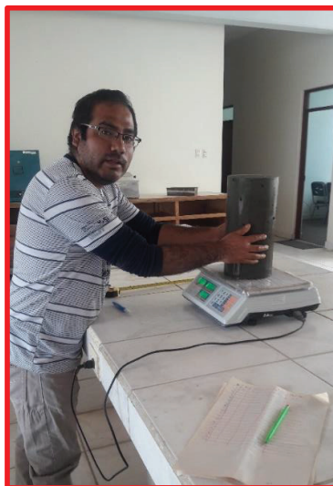
Fotografía 25: Se realizó el pesado de las Briquetas de concreto de 210 kg/cm 2 en estado húmedo.
