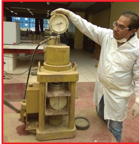
Fotografía 38: Rotura del concreto a tracción y la medición de la Resistencia.
