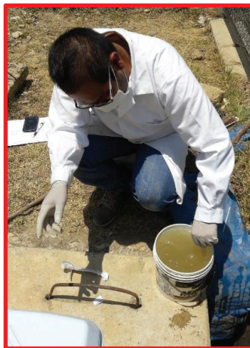
Fotografía 6: Homogenización de la muestra representativa del agua residual.
