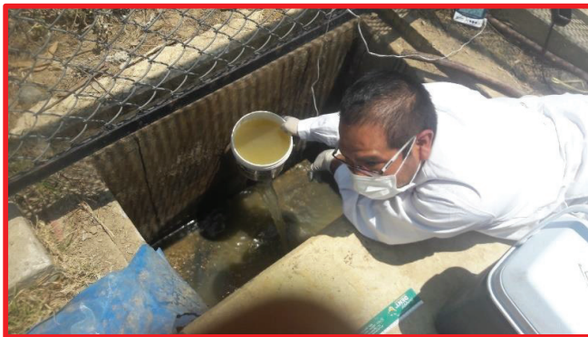
Fotografía 5: Obtención de la muestra representativa del agua residual.
