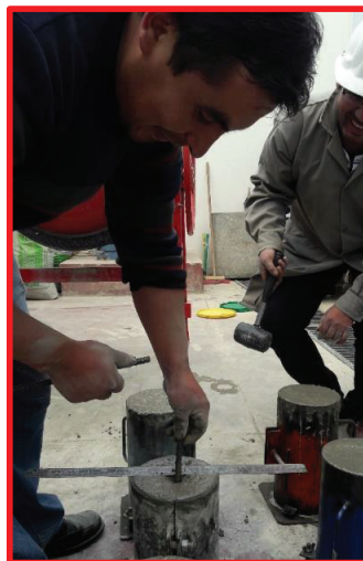
Fotografía 22: Colocación del acero a las probetas con Concreto.
