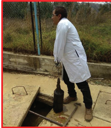
Fotografía 32: Extracción de Muestra para ser Evaluadas para la prueba de Tracción, Compresión y el efecto químico de los elementos tóxicos.
