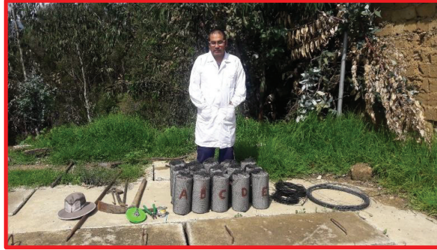
Fotografía 29: Las Briquetas de concreto f'c=210 kg/cm 2 agrupadas para ser sumergidos al agua residual
