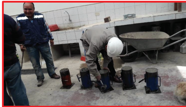
Fotografía 21: Realizando la compactación de las probetas siguiendo las recomendaciones del Técnico del Laboratorio de Suelos y Materiales de la UNASAM.
