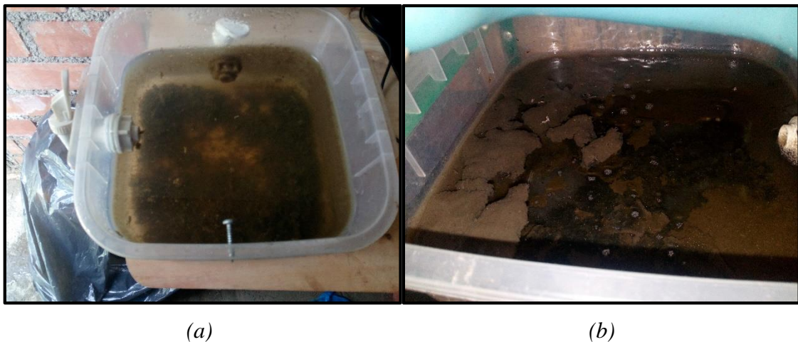
Figura 3.6.2. Sedimentador 2 en el efluente del reactor DHS-G6: (a) formación de lodos a 2 meses de la puesta en marcha; (b) formación de lodos en el sedimentador 2 a 4 meses del inicio de la investigación.
