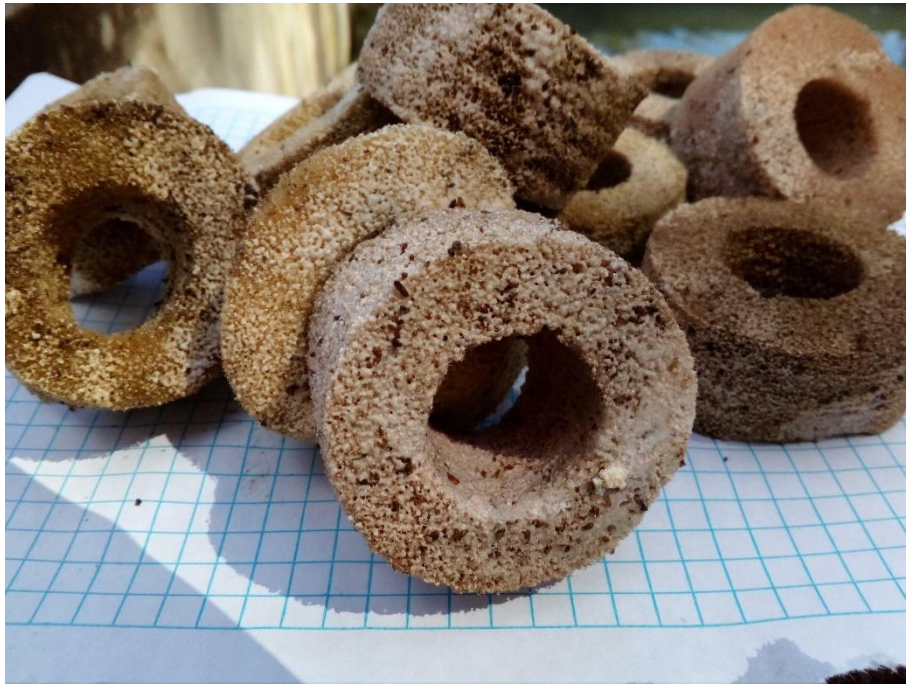
Figura 5.A: Estructura de la esponja rígida al finalizar la investigación.
