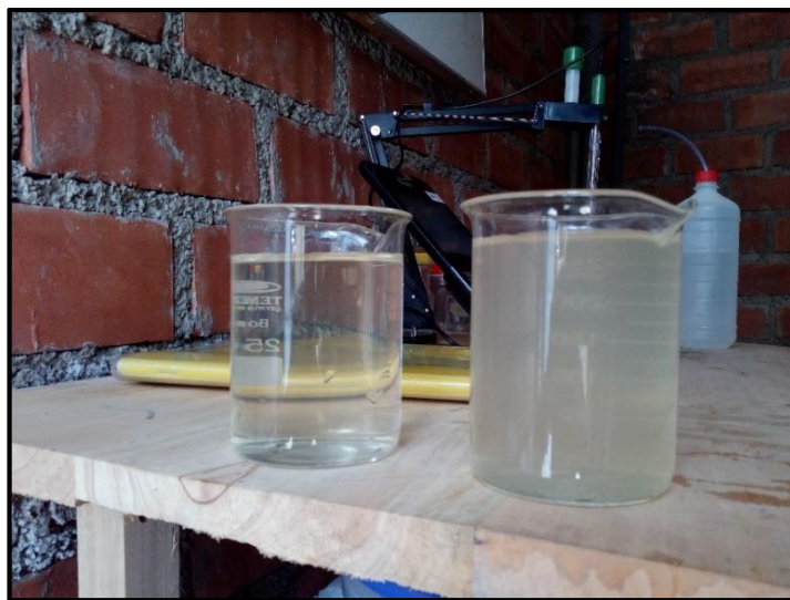
Figura 3.6.1. Características de la calidad de agua del afluente (derecha) y efluente (izquierda) del reactor DHS.
