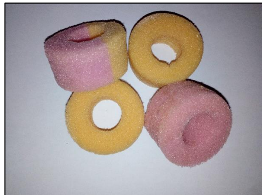
Figura 2.1.2. Estructura y dimensiones del medio filtrante; a) dimensiones de la esponja rígida. b) esponja rígida endurecida con resina epóxica.
