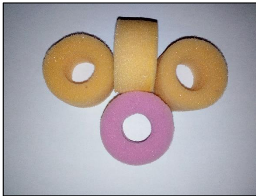
Figura 2.1.3. Estructura de la esponja de poliuretano de 23 kg/cm 3 de densidad.
