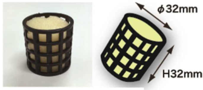
Figura 1.1.4. Esponjas cubiertas con plástico, usadas para el reactor G-3.
