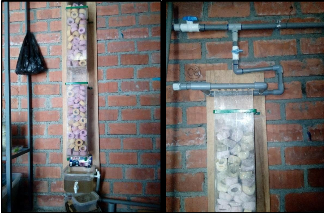
Figura 3.A: Configuración del reactor DHS y sistema de distribución de caudales.
