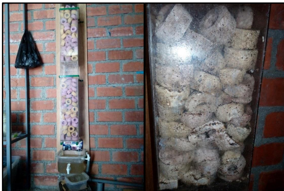
Figura 3.7.1. Características de las esponjas endurecidas al inicio y durante el periodo de investigación: (a) esponjas endurecidas al momento de la puesta en marcha; (b) características de las esponjas a los 3 meses.
