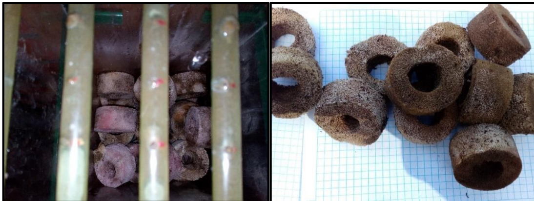
Figura 3.7.2. Esponjas endurecidas en el periodo final de la investigación: (a) acumulación de grasas y lodo en la superficie de las esponjas; (b) características de la esponja endurecidas al finalizar la investigación.
