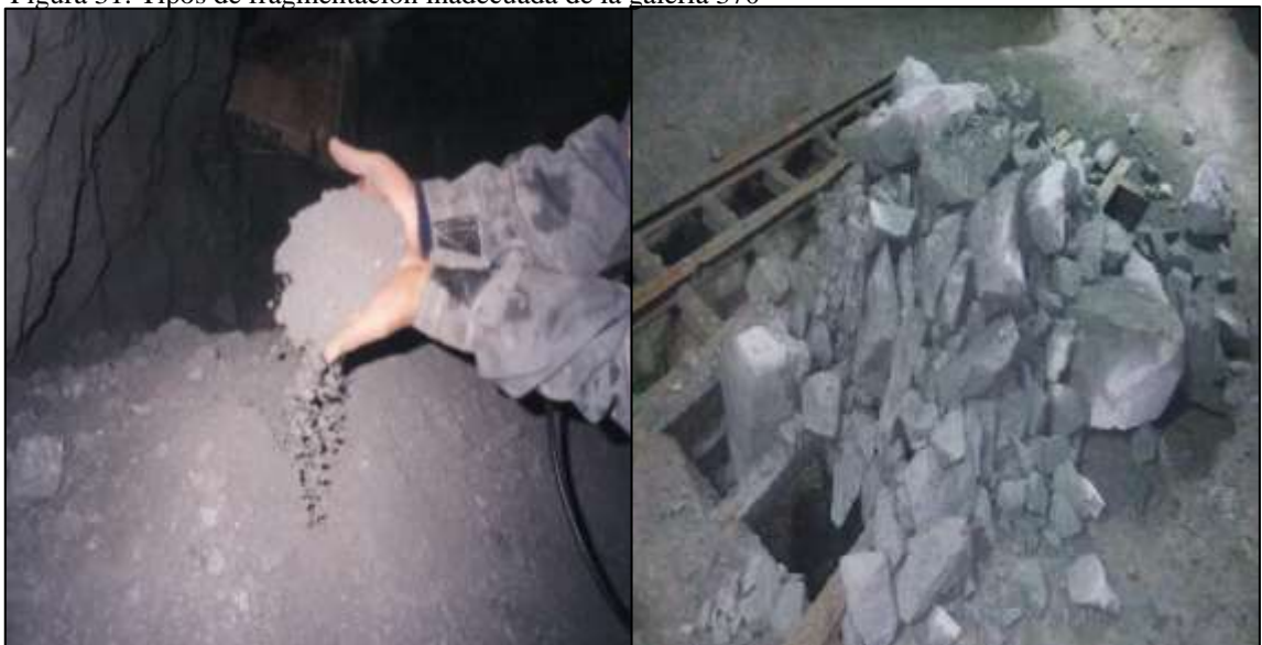
Figura 31: Tipos de fragmentación inadecuada de la galería 370
