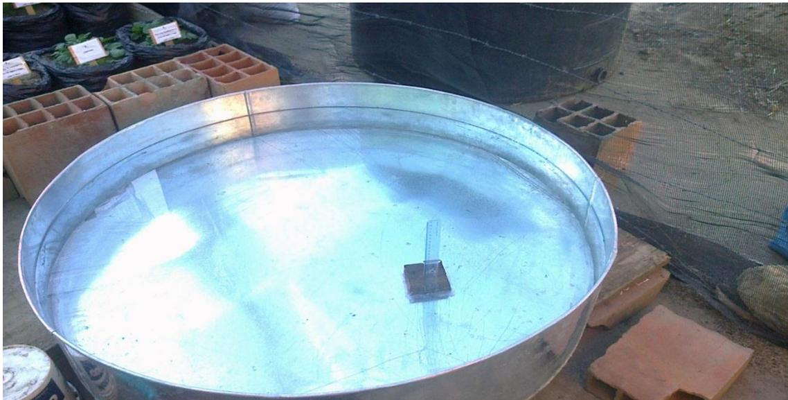
Foto 10: Instalación del Tanque evaporímetro Tipo “A”.
