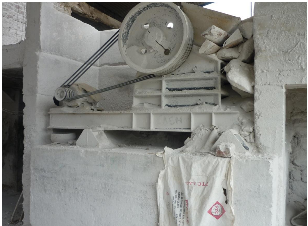
Equipo para trituración de piedra quemada Foto N° 08
