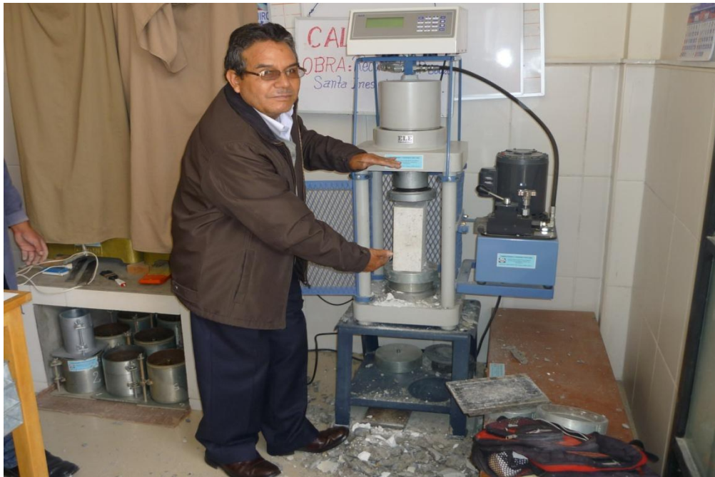
Falla de la briqueta de yeso Foto N° 23
