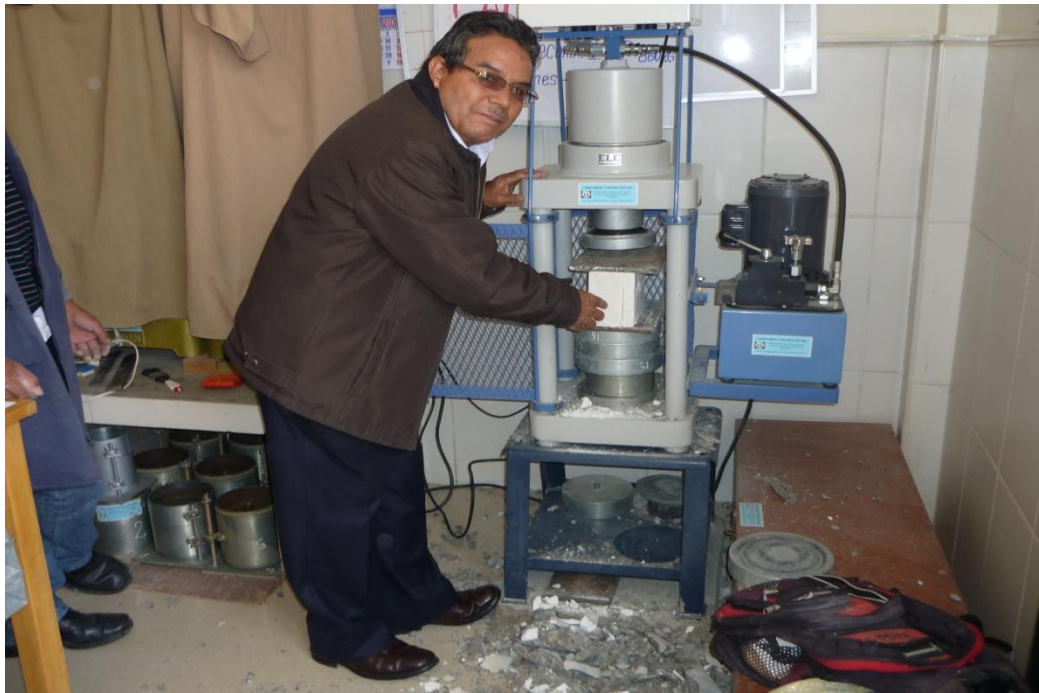
2ª Aplicación de carga perpendicular a la sección de 09 x 24 cm Foto N° 20
