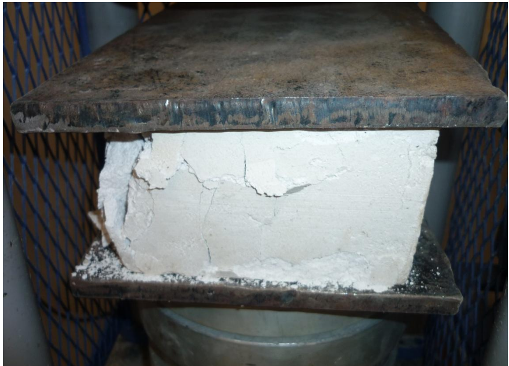
Falla de la briqueta de yeso Foto N° 21
