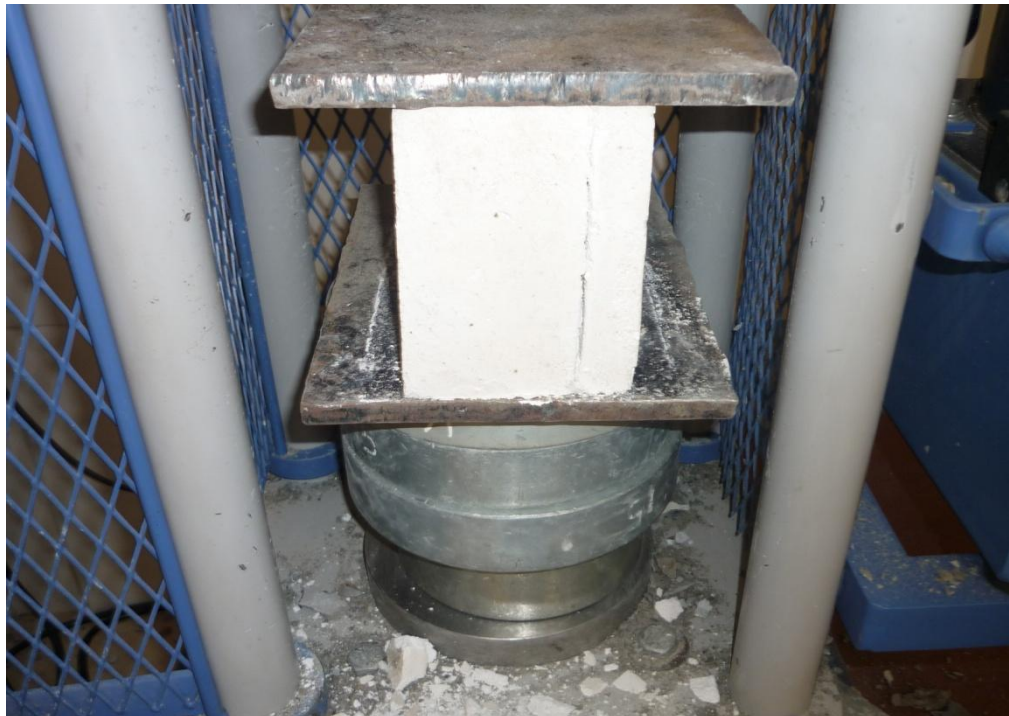
Falla de la briqueta de yeso Foto N° 23
