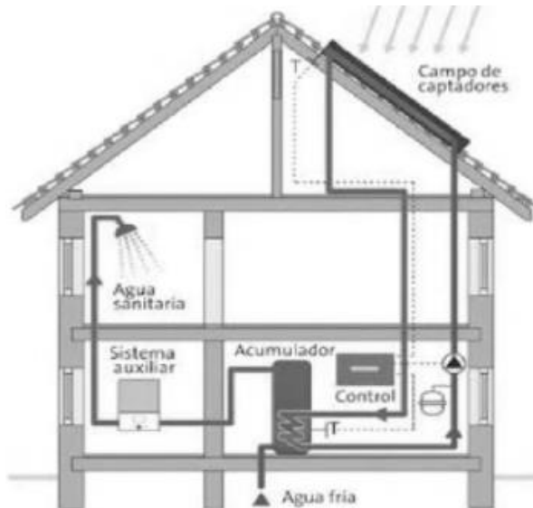
Figura 1: Instalación de energía solar térmica para la producción de agua caliente sanitaria
