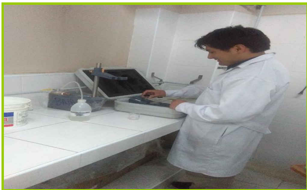
Fotografía N° 31: selección del pH óptimo del coagulante natural Vicia faba .
