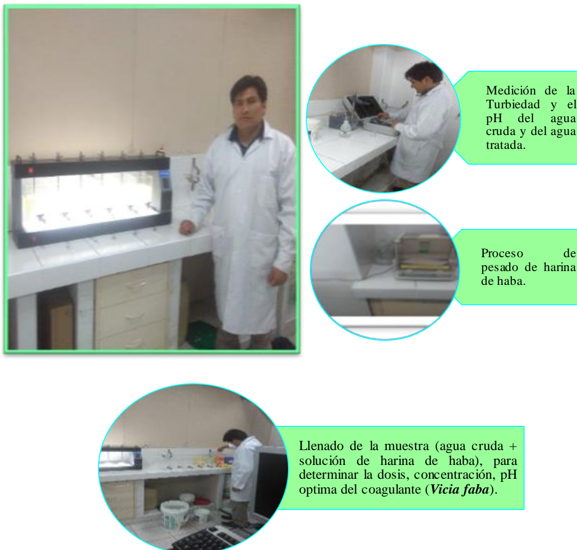
Fotografía N° 5: Procedimientos del test de jarras.
