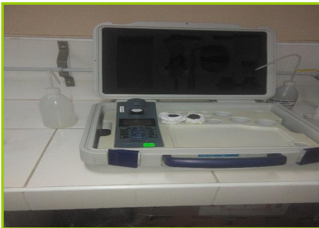
Fotografía N° 21: Equipo de medición de turbiedad – Turbidímetro.
