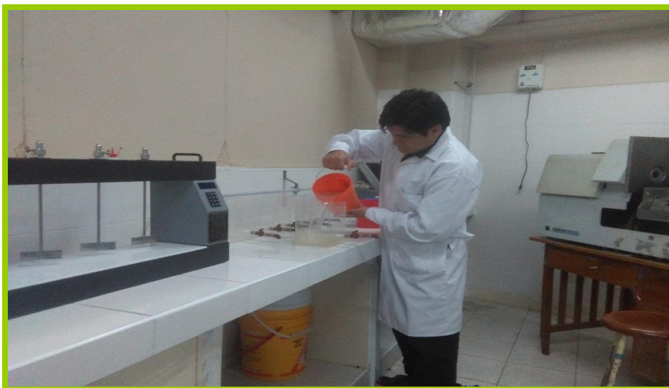
Fotografía N° 30: Llenado de vasos con muestra antes preparada a (pH: 6.5, 7.00, 7.5, 8.00, 8.5, 9.00).
