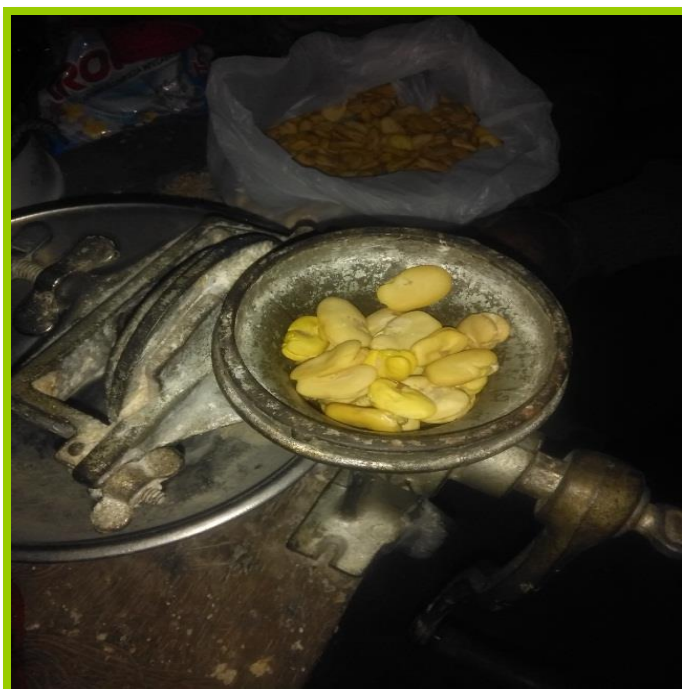
Fotografía N° 17: Proceso de molido de la semilla del haba pelado.
