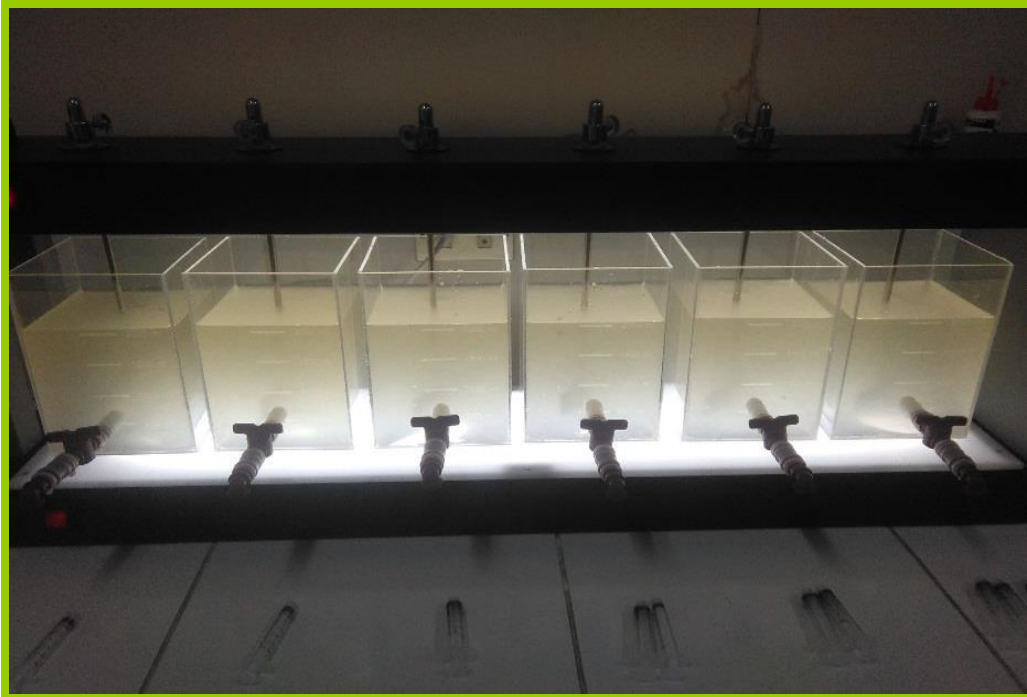
Fotografía N° 28: Proceso de sedimentación.
