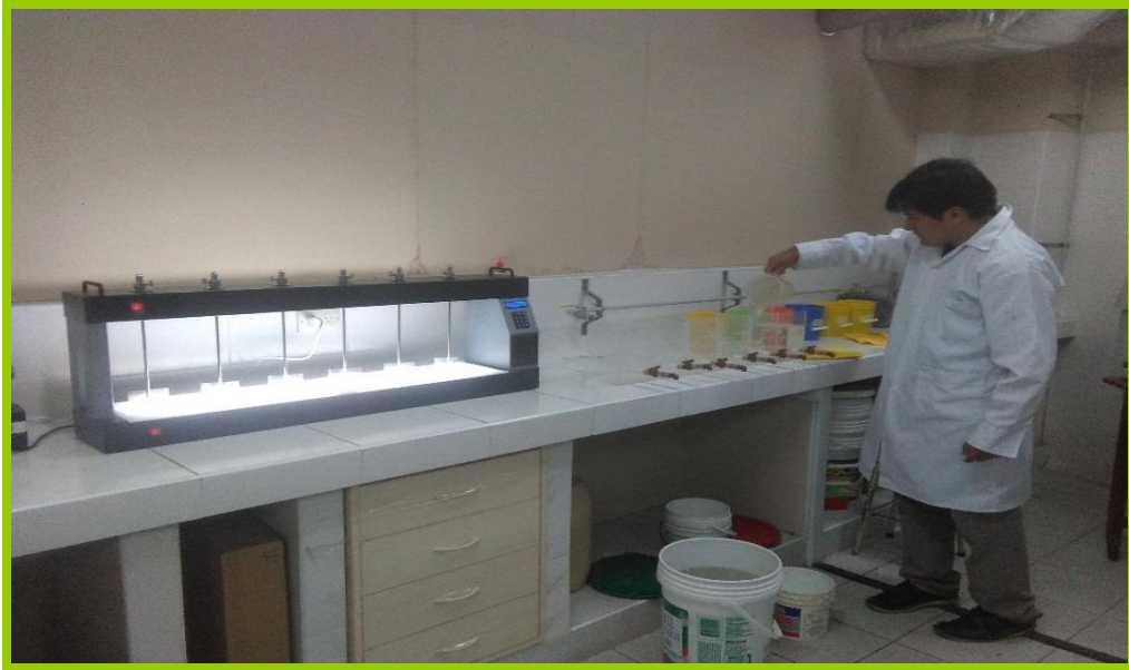
Fotografía N° 24: Llenado de los vasos de 2000 ml con muestra de agua cruda.
