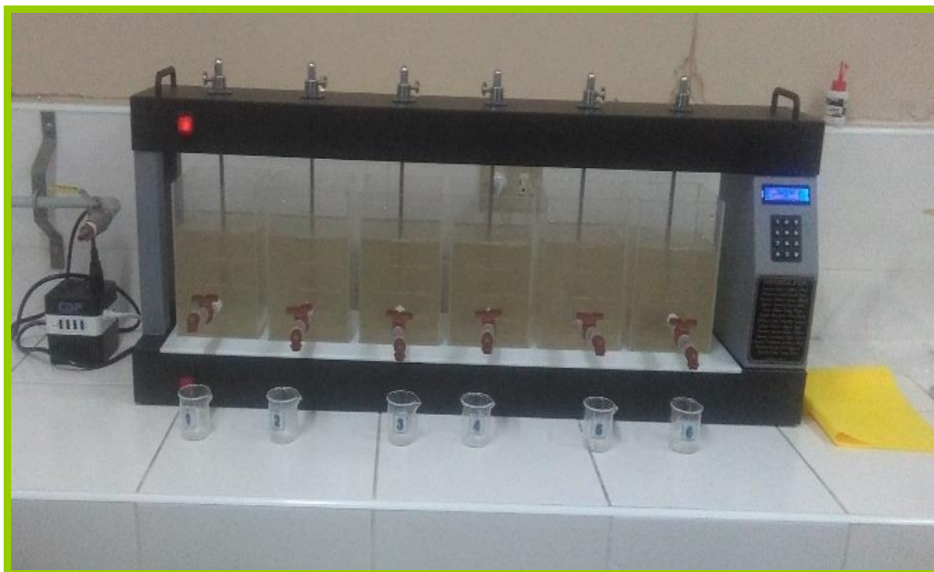
Fotografía N° 20: Equipo de prueba de jarras que se utilizó.
