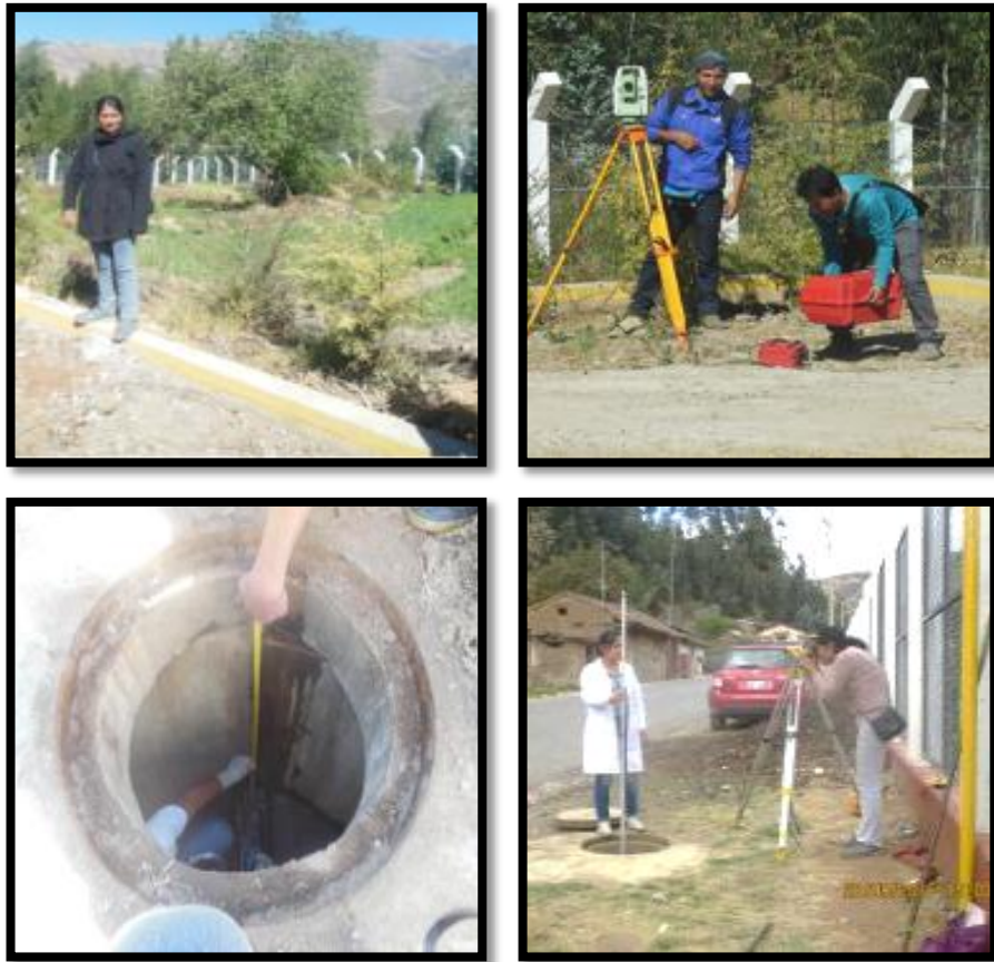
Fotografía 4: Levantamiento topográfico de todo el sistema a escala piloto. Fuente. Trabajo de Campo.
