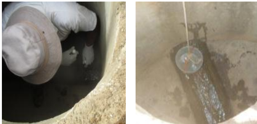
Fotografía 24: Aforo de Caudal del Agua Residual de la Red mediante el método de las esferas de corcho y toma de muestras del agua residual a tratar. Fuente. Trabajo de Campo.
