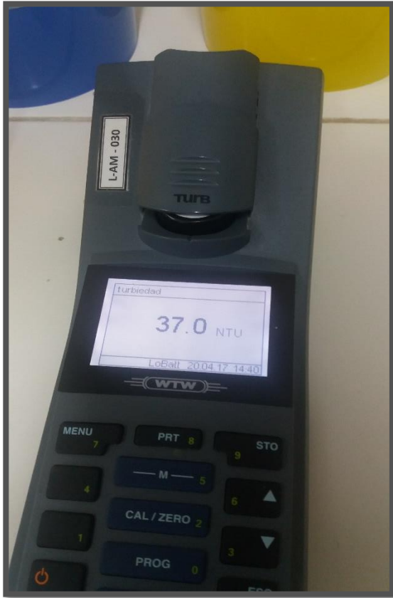
Fotografía N° 11: Equipo para medir la turbiedad (Turbidimetro)
