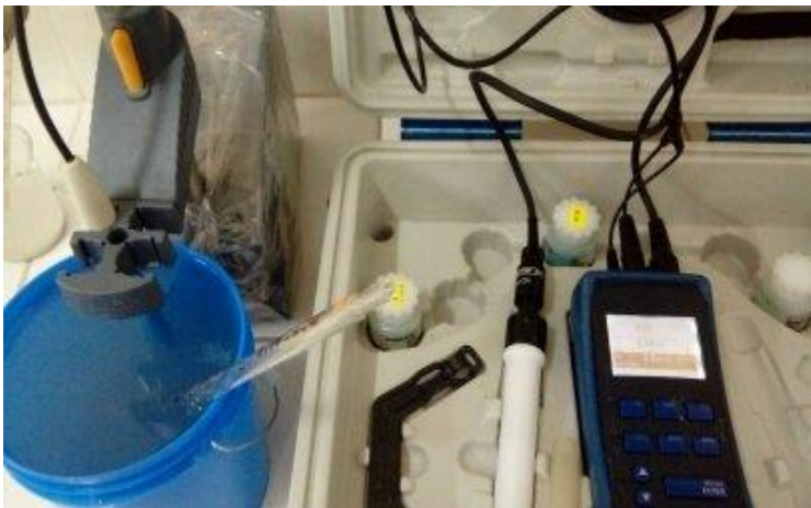
Fotografía N° 12: Equipo para medir el pH (pH- metro)
