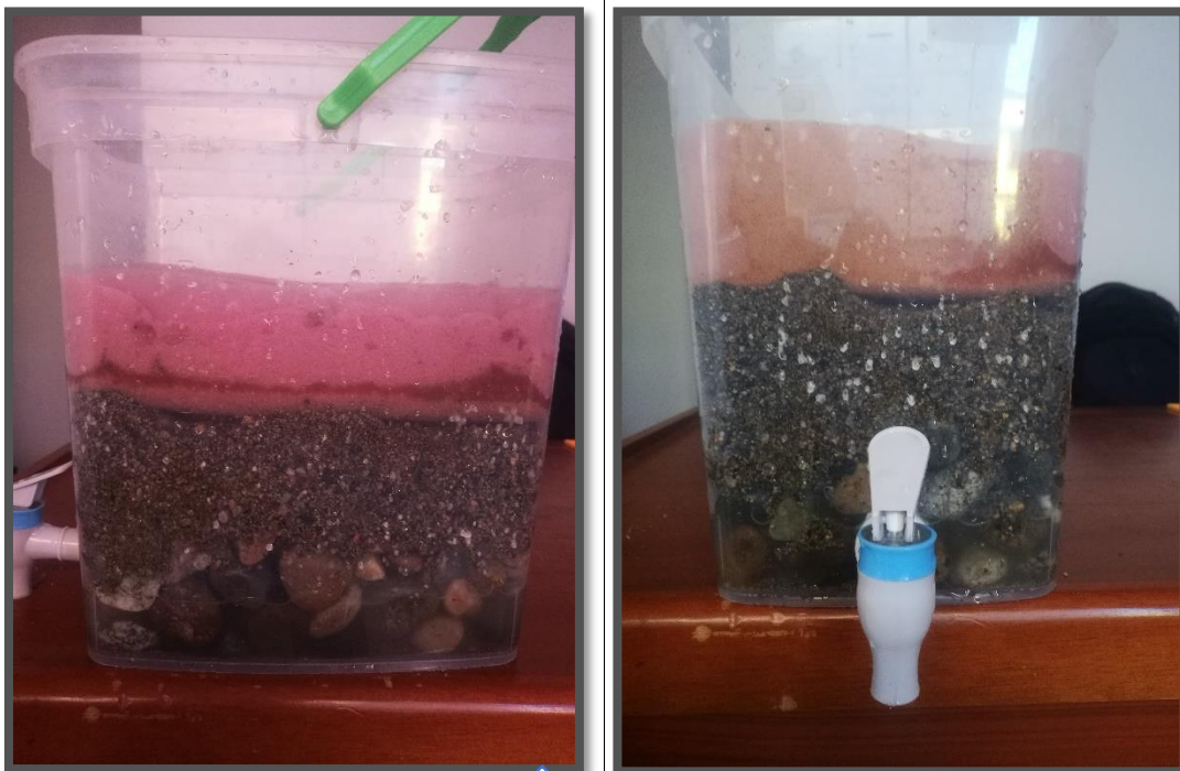
Fotografía N° 30: Proceso de filtración lenta modificado.
