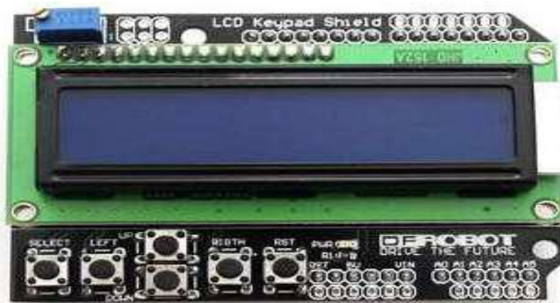
Gráfico 3 Pantalla Lcd para Arduino 16x2
