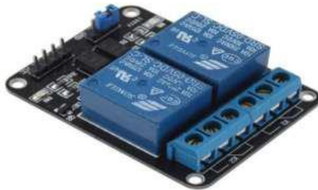
Gráfico 5 Relé 2 canales 5v Arduino
