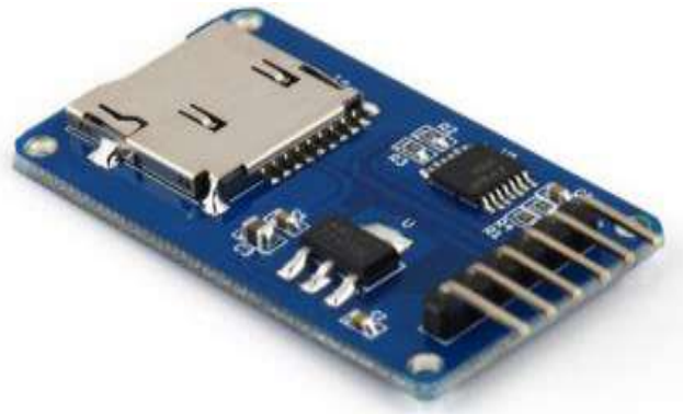
Gráfico 6 Modulo lector de tarjeta Sd Arduino
