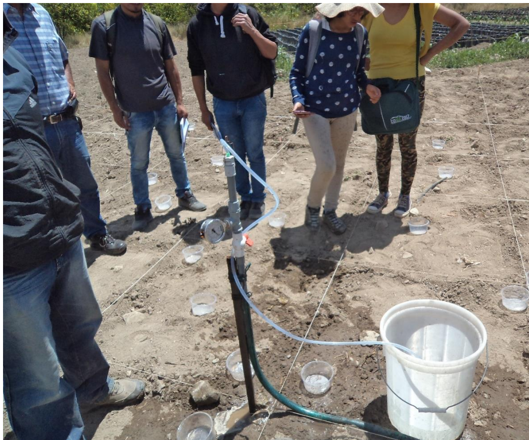
Figura D 8. Proceso de medición de caudal de los micro aspersores Nota: Se puede apreciar el enmallado y los pluviómetros
