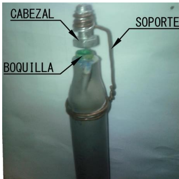
Figura 1. Micro aspersor artesanal de impacto a un cabezal de tornillo Nota: construido a partir de la serie Agroecología (2009). Riego por micro-aspersores artesanales”. / Elaboración propia.
