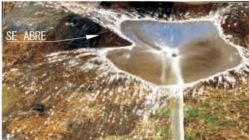
figura 2. Funcionamiento del micro aspersor artesanal de impacto a un cabezal de tornillo Nota: Se puede apreciar la forma de dispersión del agua
