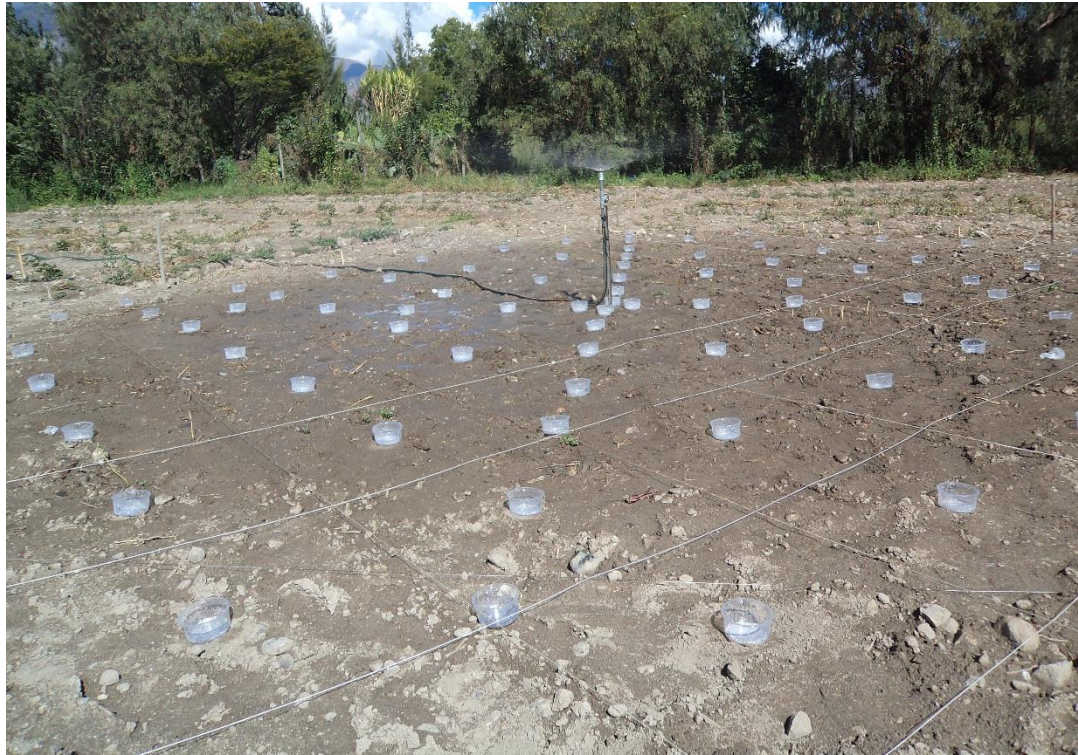
Figura D 11. Inicio de prueba de coeficiente de uniformidad
