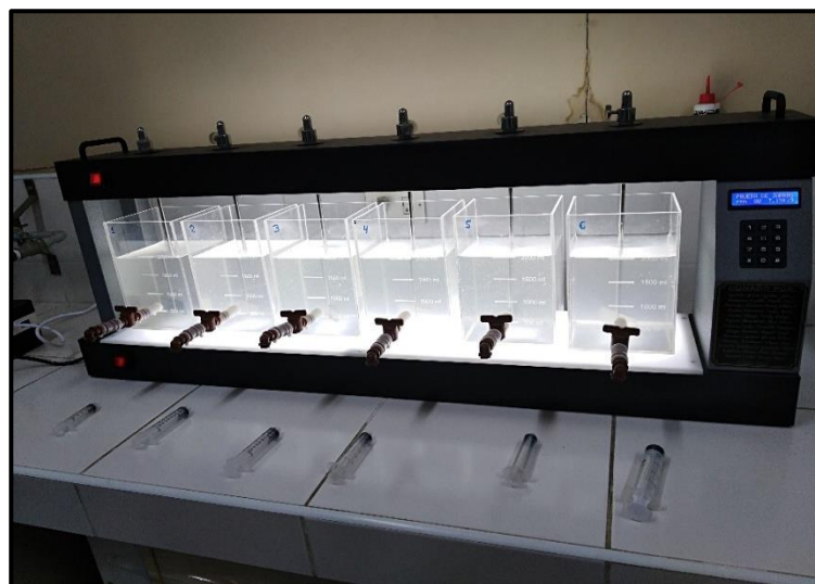
Fotografía 13 Inyección del Almidón de Yuca al Equipo
