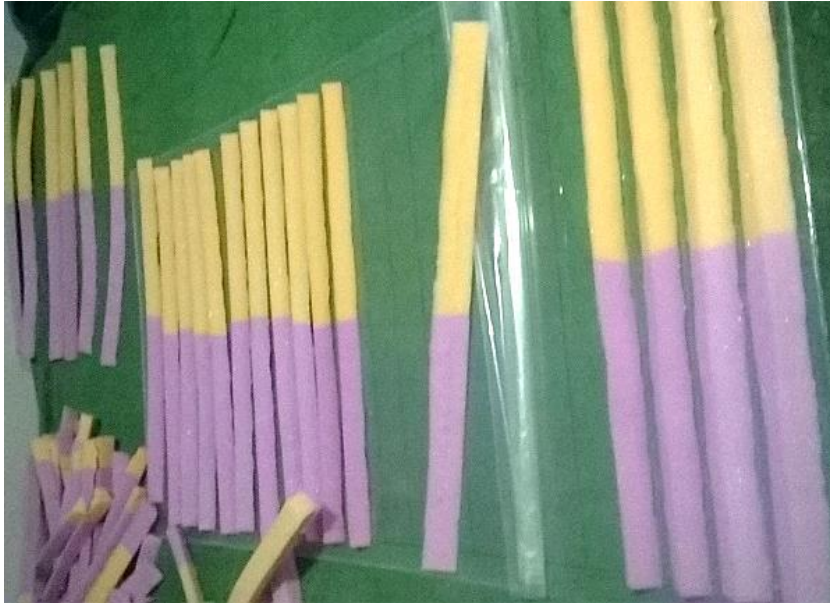
Fotografía N° 7: Armado del reactor DHS tipo cortina
