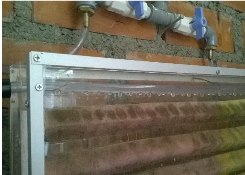
Fotografía N° 9: Sistema de distribución de caudal
