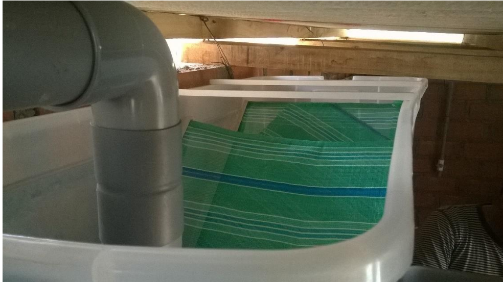
Fotografía N° 4: Paneles del sedimentador primario piloto
