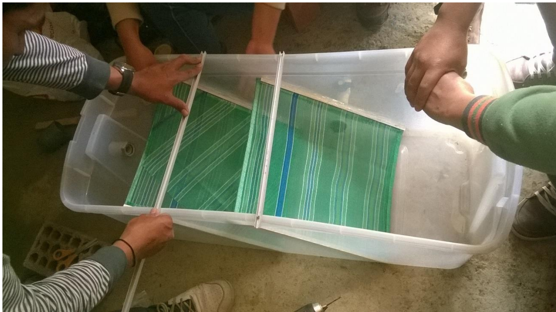
Fotografía N° 25: Construcción del sedimentador primario piloto.
