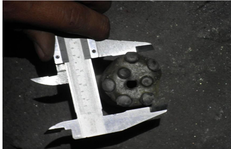
Fotografía N°15 , Medición del diámetro de la broca de perforación
