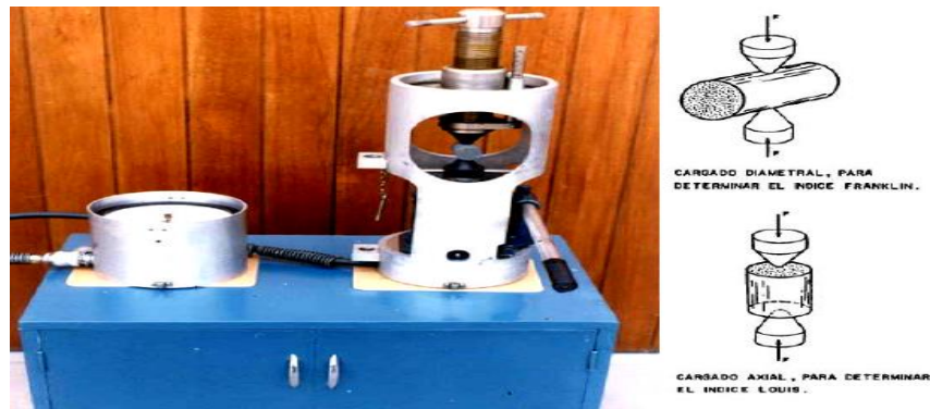
Figura N°05: Ensayos de Carga Puntual.
