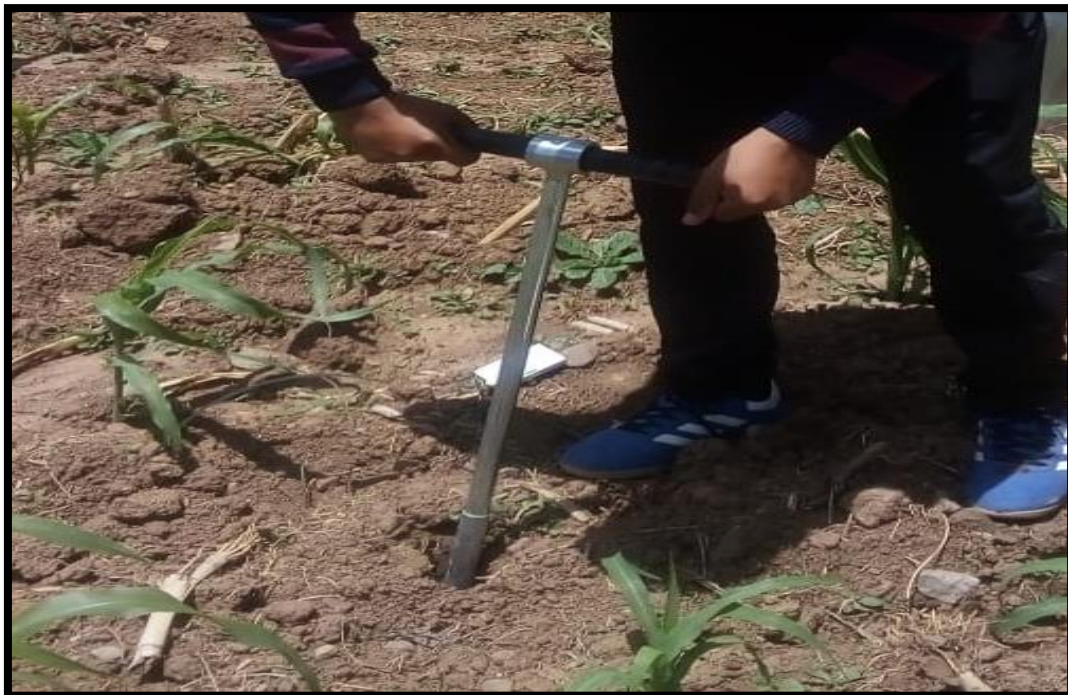
Fig. N° 26: Se hicieron agujeros con el barreno no mayor de 40 cm y diámetro 6 cm
