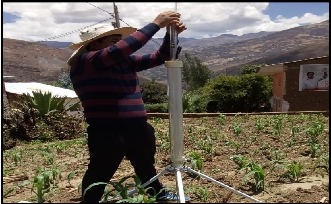
Fig. N° 30: Se levantó el tubo de aire a 5 cm para medir las variaciones de carga hidráulica a partir de ese momento en el permeámetro Guelph.
