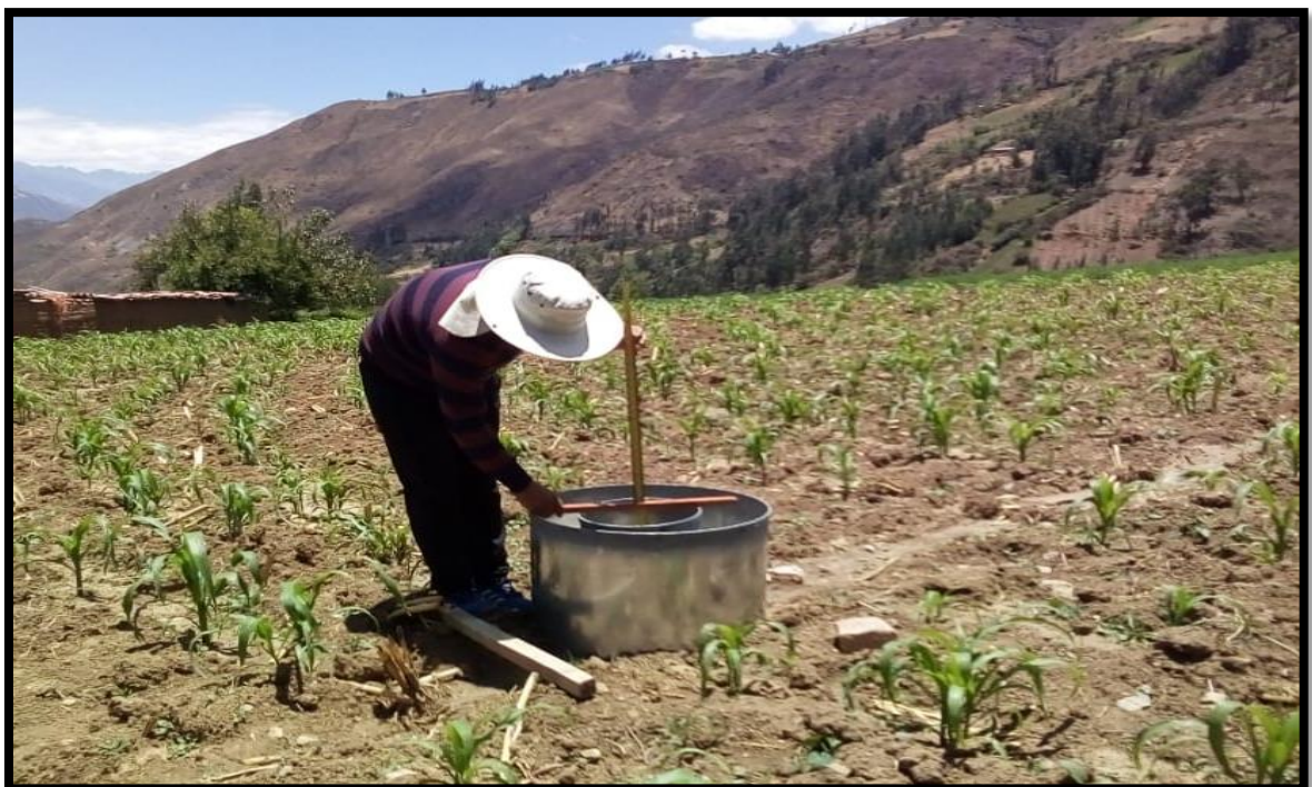
Fig. N° 32: Se Instaló el Infiltrómetro de doble anillo con comba y tabla a 10 cm el de mayor diámetro y 15 el de menor diámetro.
