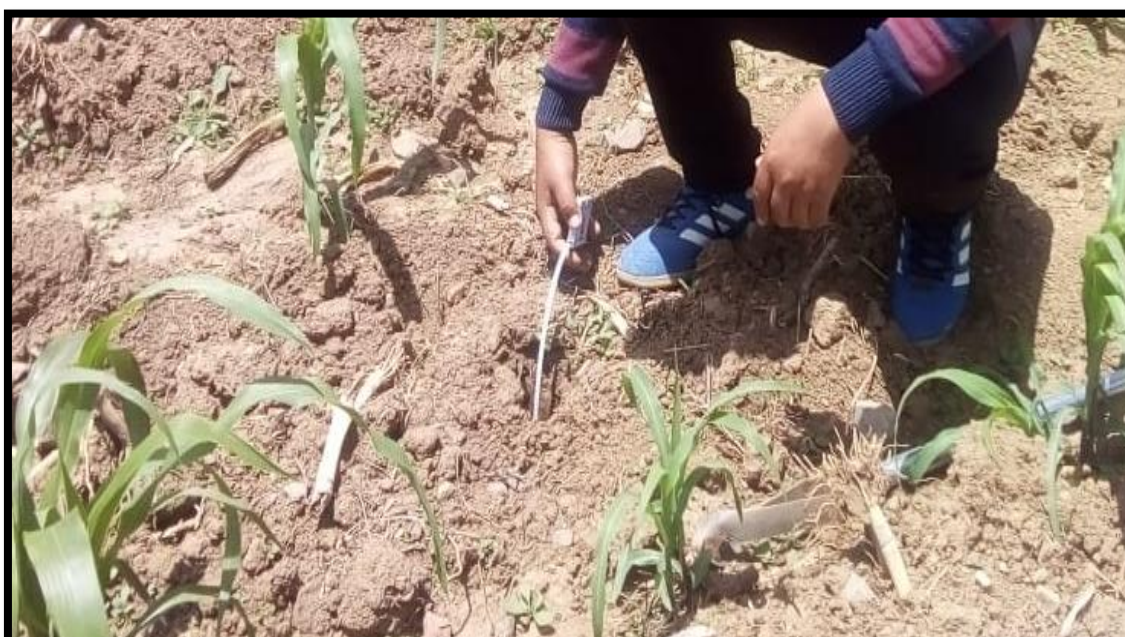
Fig. N° 28: Se verifico la profundidad del agujero con una wincha milimétrica para el permeámetro Guelph y Porchet.
