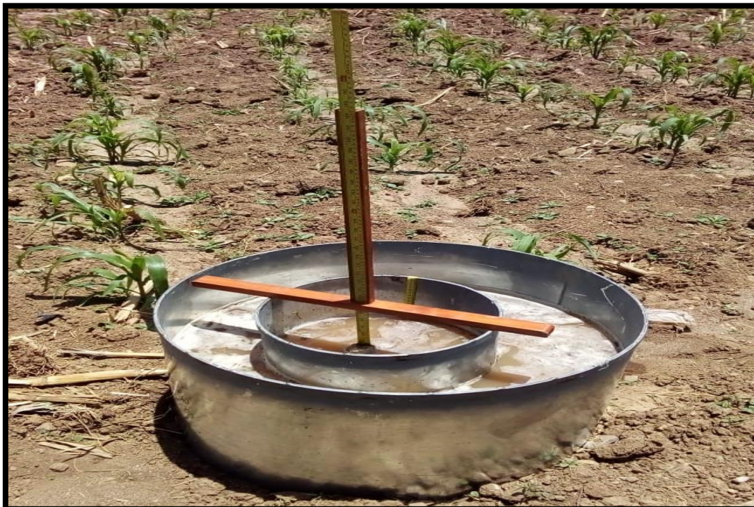
Fig. N° 34: Se hizo las lecturas según la descendencia de agua en el infiltrómetro de doble anillo
