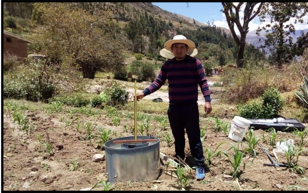
Fig. N° 33: Se verifico la correcta instalación del Infiltrómetro de doble anillo
