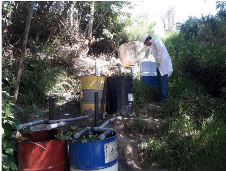
**FOTOGRAFÍA 33: TOMA DE MUESTRA EN LA SALIDA DEL HUMEDAL ARTIFICIAL DE FLUJO VERTICAL**
