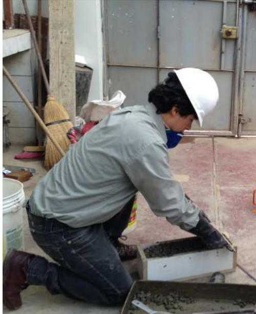
*Figura 19: Proceso de vaciado y enrasado del concreto en encofrado para ser ensayado a flexión.*
