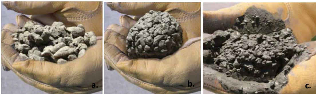
*Figura 2:* Muestras de concreto permeable con diferentes contenidos de humedad, formadas en una bola: (a) muy poca agua, (b) apropiada cantidad de agua, y (c) demasiada agua.
