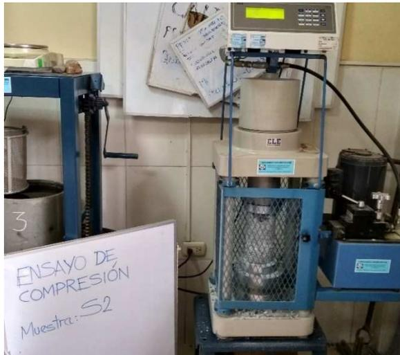
*Figura 17: Proceso de ensayo a compresión de muestra cilíndrica.
