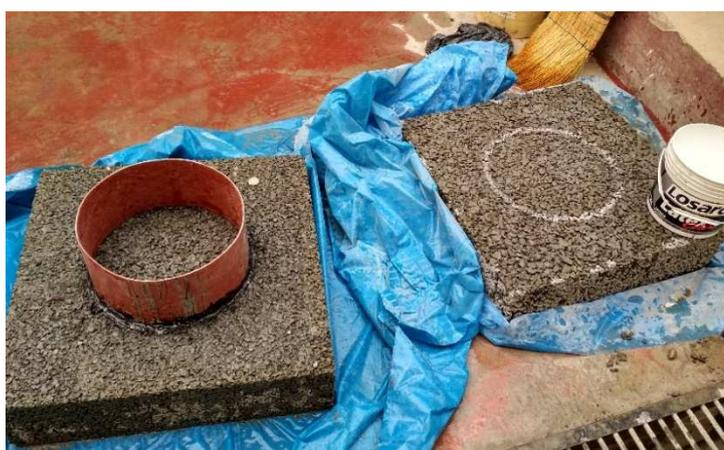
*Figura 26: Losas de concreto permeable siendo preparados para ser ensayados a permeabilidad.
