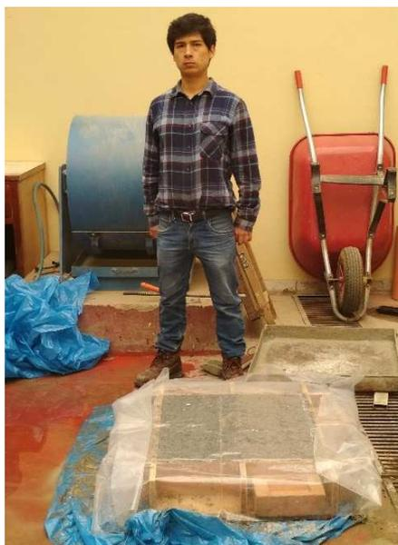
*Figura 25: Curado del concreto permeable en losas de prueba.
