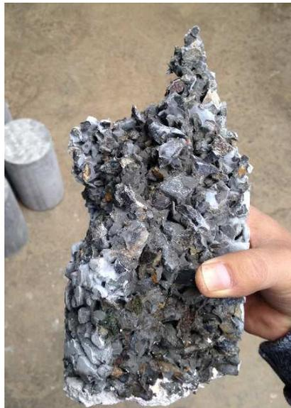
*Figura 18: Apariencia de la muestra cilíndrica luego de ensayada a compresión.
