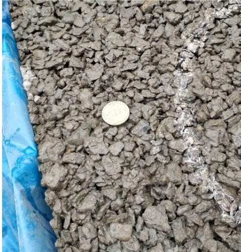
*Figura 29: Textura superficial en la losa de concreto permeable fabricado con piedra de TM de 1/2''*
