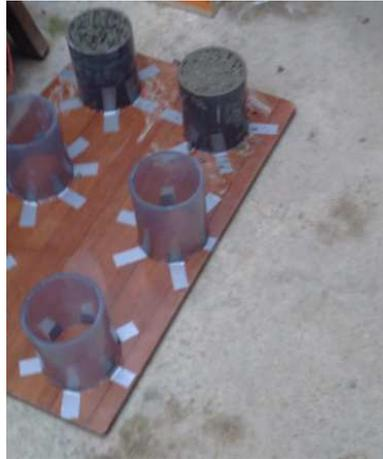
*Figura 21:* Proceso de vaciado de concreto en los moldes para ser usados en los ensayos de infiltración.
