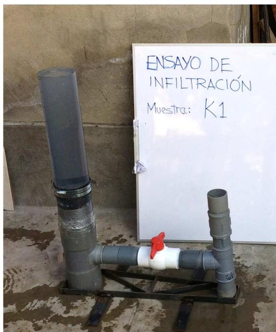
Figura 23: Permeámetro de carga variable de fabricación propia
