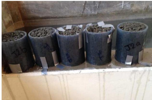
*Figura 22:* Muestras de concreto permeable endurecidas para ser ensayados a infiltración.
