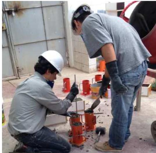
*Figura 15: Proceso de vaceado y compactación del concreto en los moldes cilíndricos
