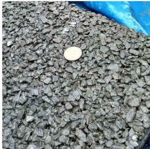
*Figura 30: Textura superficial en la losa de concreto permeable fabricado con piedra de TM de 3/8''*
