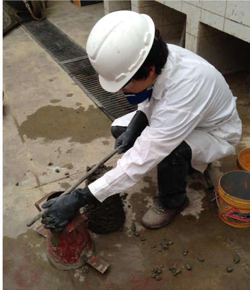
*Figura 27: Proceso de medición del Slump en el concreto permeable fabricado.*
