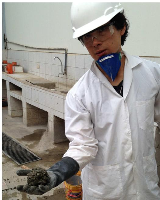
*Figura 28: Muestra de concreto permeable moldeado en una bola, indicador de la propicia cantidad de agua en la mezcla.*
