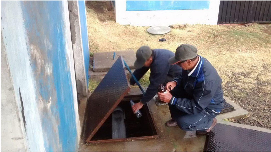
Figura 10: Toma de muestra de agua en la salida de los filtros
