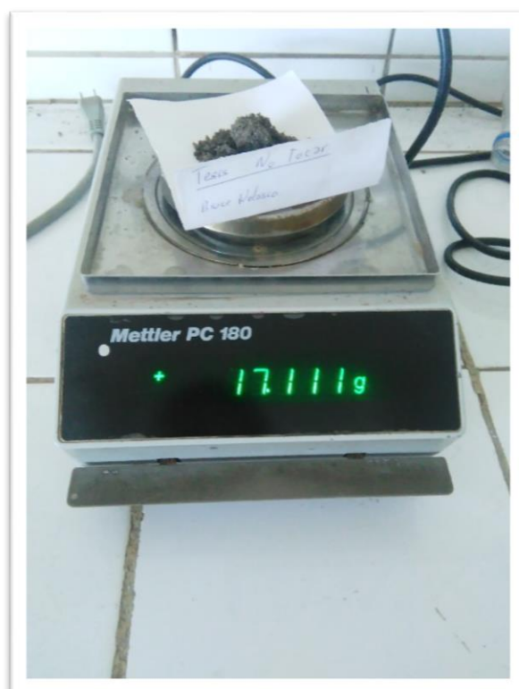
Foto 10. Peso de muestra de suelo para determinar la humedad gravimétrica
