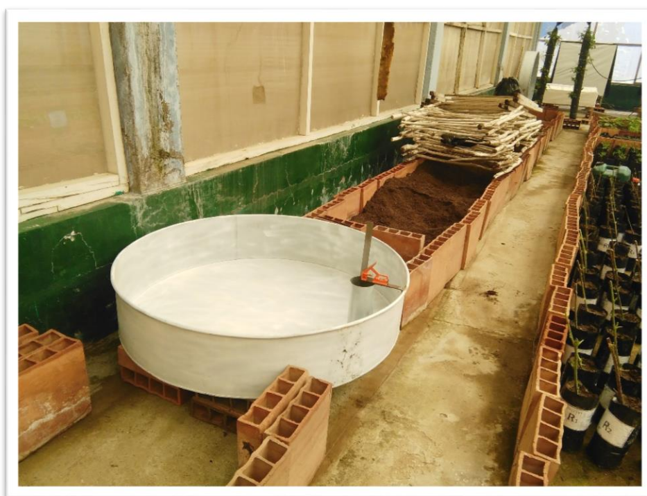
Foto 7. Instalación del Tanque evaporímetro tipo A
