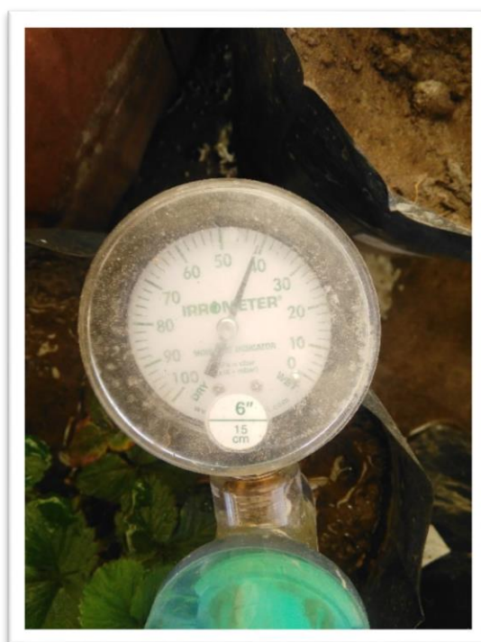
Foto 12. Lectura del tensiómetro marcando 40 cb.
