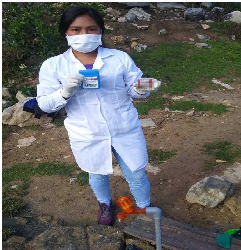
Fotografía 25: Muestreo de cloro residual - vivienda final
