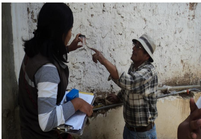
Fotografía 12: Medición del cloro residual
