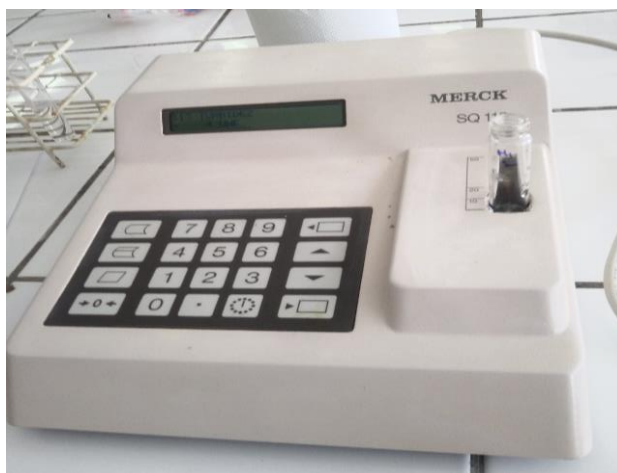
Fotografía 11: Medición de la turbiedad
