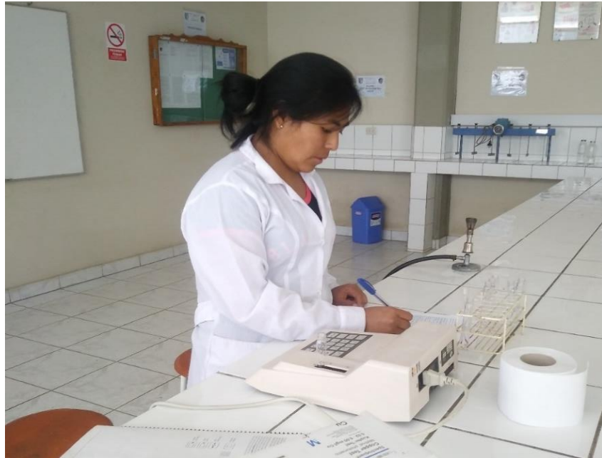
Fotografía 10: Medición de la conductividad
