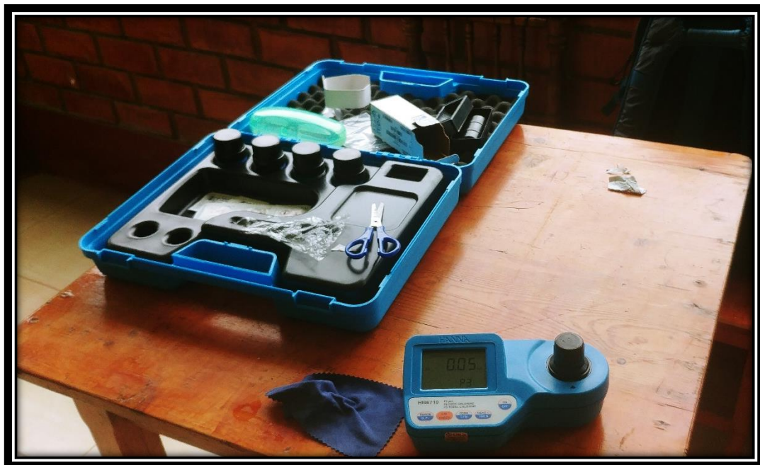
Fotografía 03: Fotómetro digital con que se medirá el Cloro libre, total y pH
