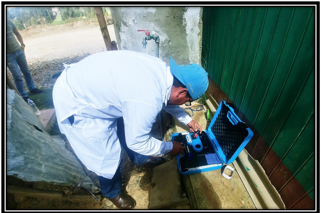
Fotografía 16: Medición del Cloro Libre
