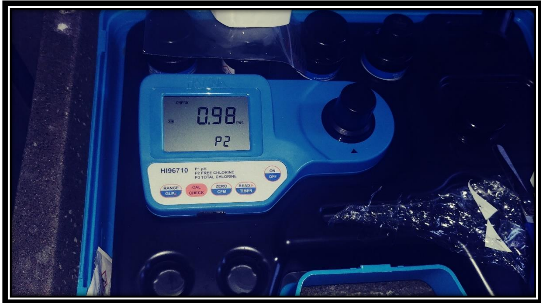
Fotografía 11: Medición del cloro libre en el cuarto punto de muestreo
