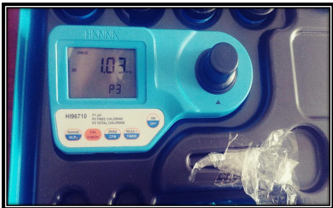
Fotografía 08: Medición del cloro total en el segundo punto de muestreo
