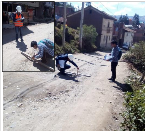
Foto 03: Recoleccion de Datos para Inventario de Carretera en Malas Condiciones (Daños por Erosion)
