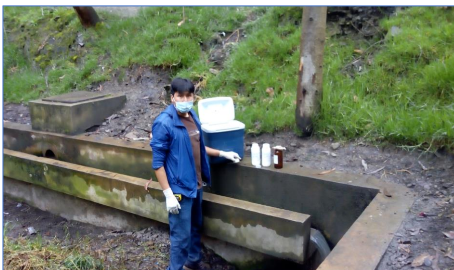
Figura 81. Muestreo del Efluente de la PTAR N° 02
