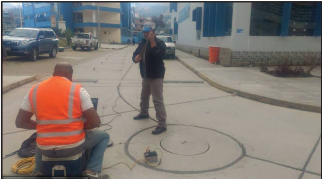
Figura 24: Se muestra el otro extremo de la línea sísmica donde se decepcionaba los datos de velocidad generadas por el martillo de 24 lb.
