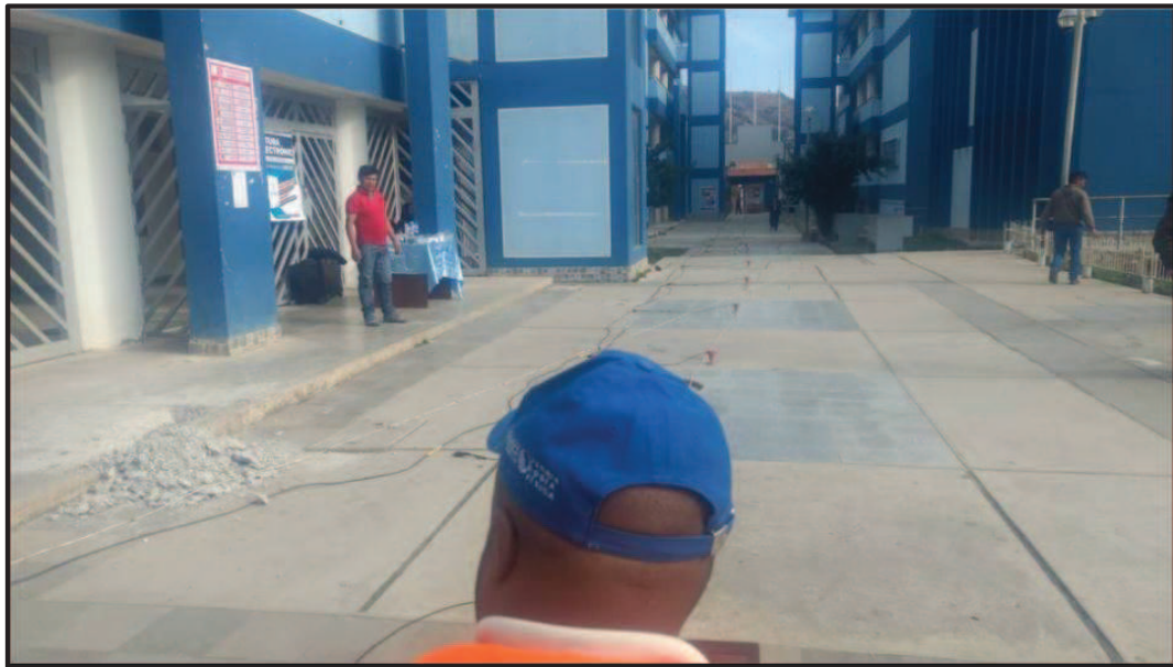
Figura 27: Se muestra el tendido de 75m de línea sísmica con 24 geófonos espaciados a 3 m.
