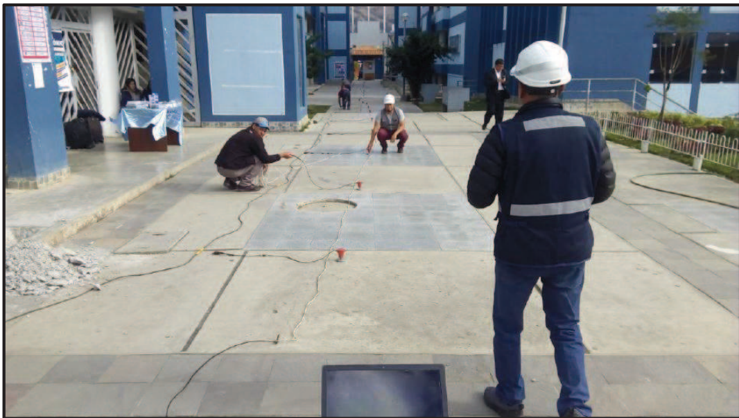
Figura 28: Se muestra los geófonos responsables de sentir la onda de corte y transmitirla al sismógrafo para su procesamiento posteriormente.
