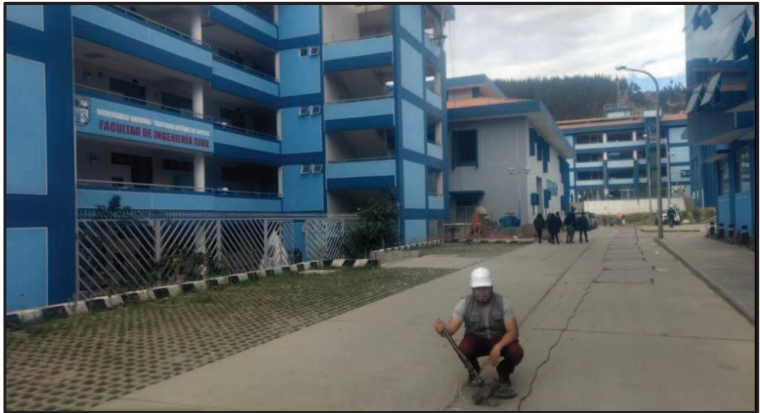
Figura 23: Se muestra el tendido de 75m de línea sísmica con 24 geófonos espaciados a 3 m.
