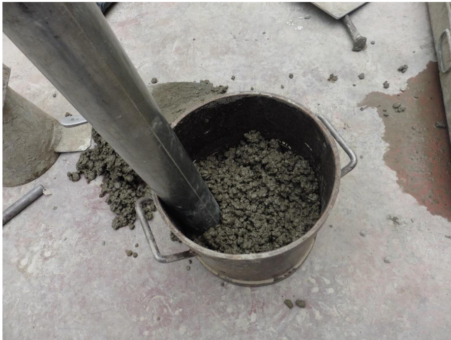
Imagen 3. Compactación de concreto permeable con martillo proctor.
