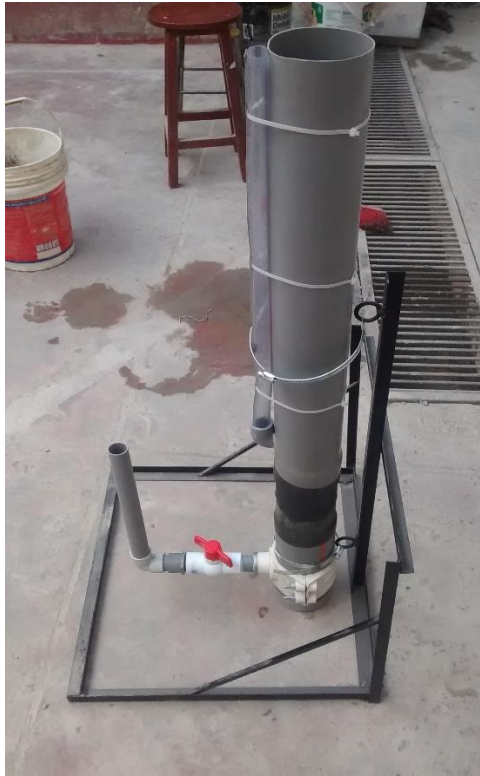
Imagen 6. Permeámetro de carga variable con muestra de concreto permeable sellado.
