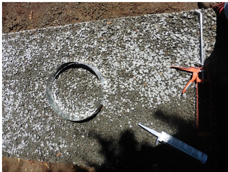
Imagen 9. Prueba de infiltración en campo.
