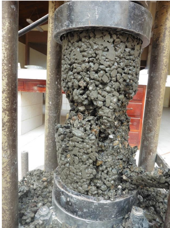
Imagen 8. Rotura de probeta de concreto permeable y tipo de falla cónica.
