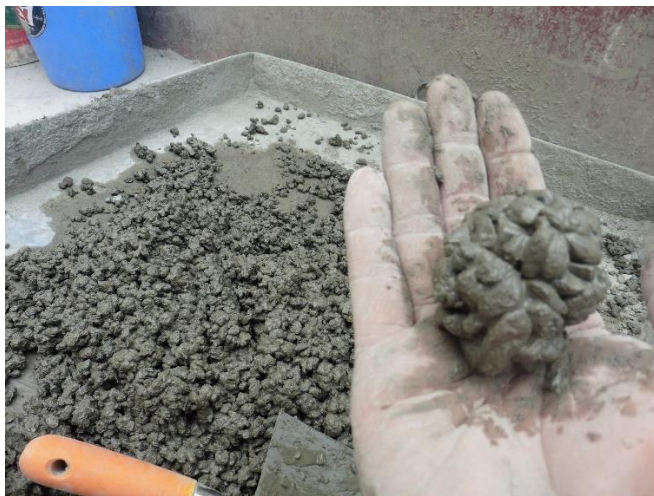
Imagen 5. Dosificación en pequeñas proporciones para obtener valor de relación agua/cemento.
