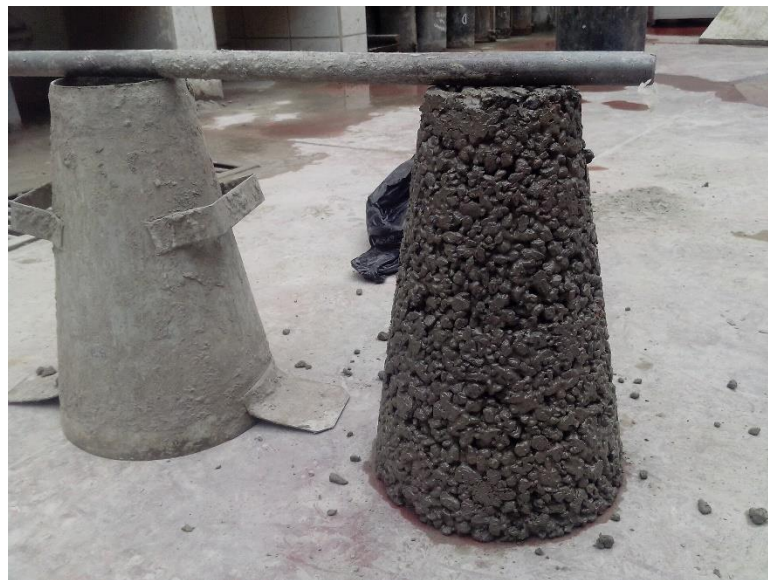
Imagen 7. Revenimiento cero de concreto permeable.
