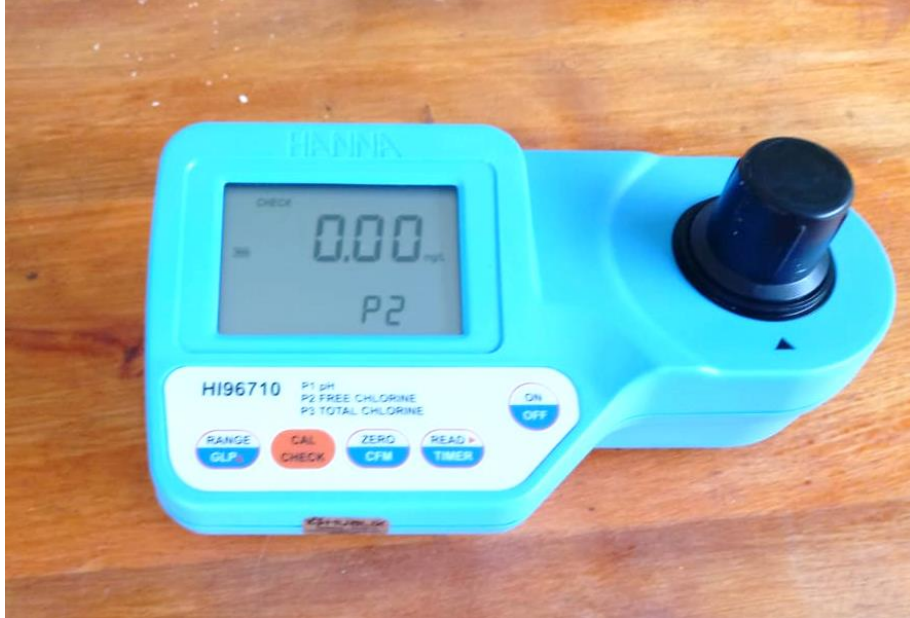
FOTOGRAFÍA 1: EQUIPO DE MEDICIÓN (FOTÓMETRO HI 96710 PARA CLORO + pH)
