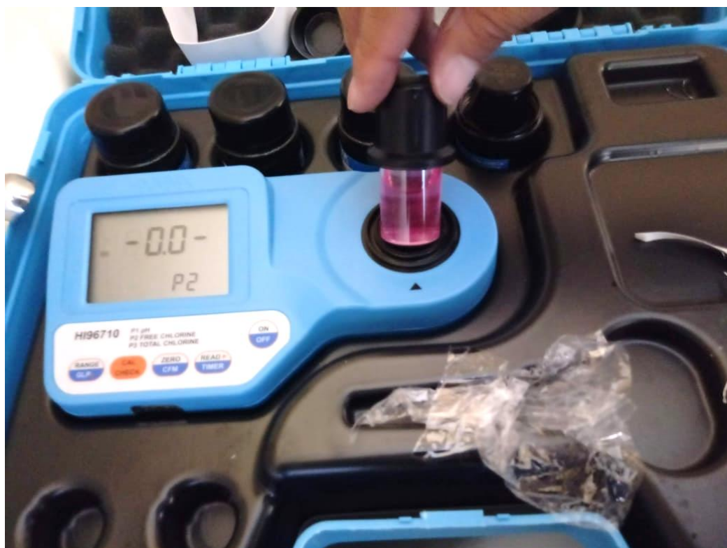
FOTOGRAFÍA 6: MEDICIÓN DEL CLORO EN EL FOTÓMETRO HI 96710 PARA CLORO + pH
