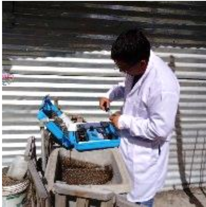
FOTOGRAFÍA 11: MEDICIÓN DEL CLORO EN OTRO PUNTO CON EL FOTÓMETRO HI 96710 PARA CLORO + pH
