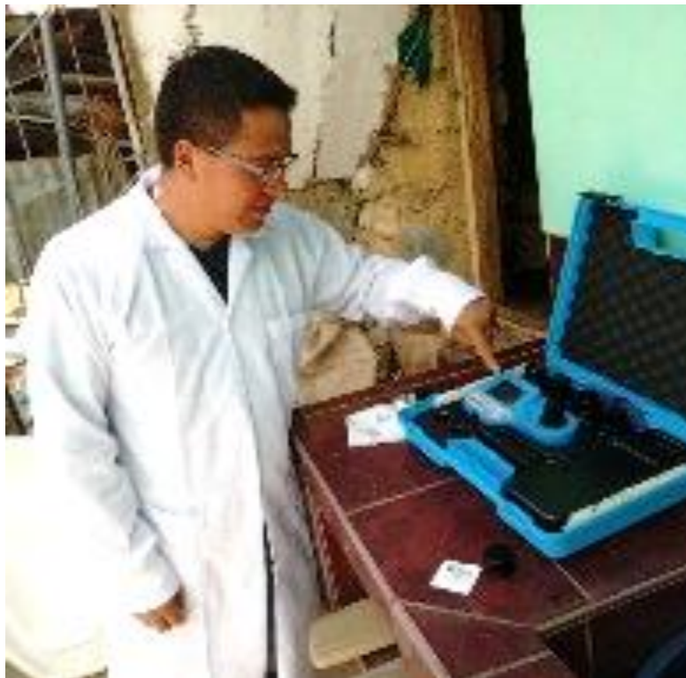
FOTOGRAFÍA 16: TESISTA EN LA MEDICIÓN DEL CLORO EN EL FOTÓMETRO HI 96710 PARA CLORO + pH
