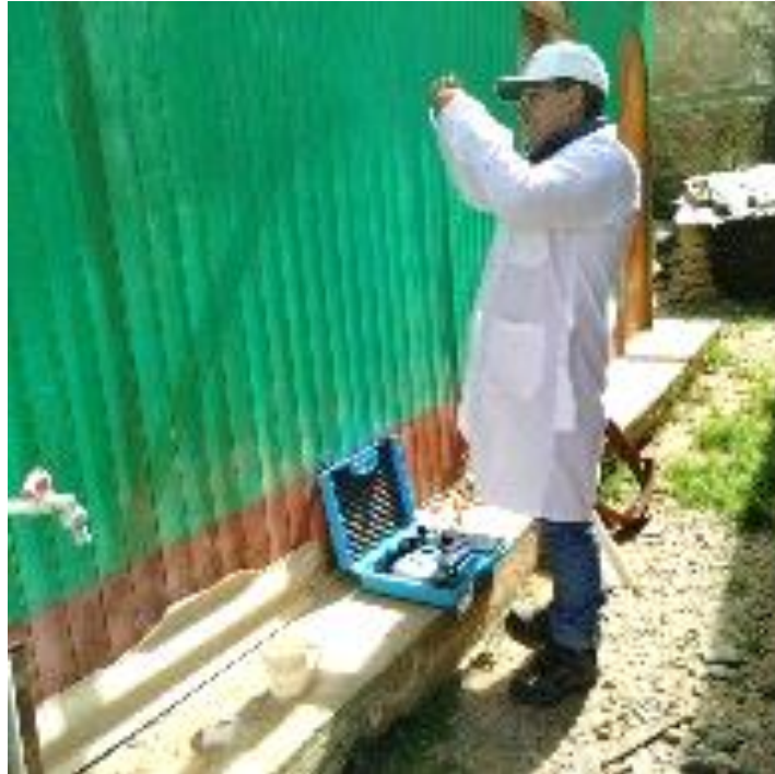
FOTOGRAFÍA 13: ADICIÓN DEL REACTIVO PARA LA MEDICIÓN DEL CLORO CON EL FOTÓMETRO HI 96710 PARA CLORO + pH
