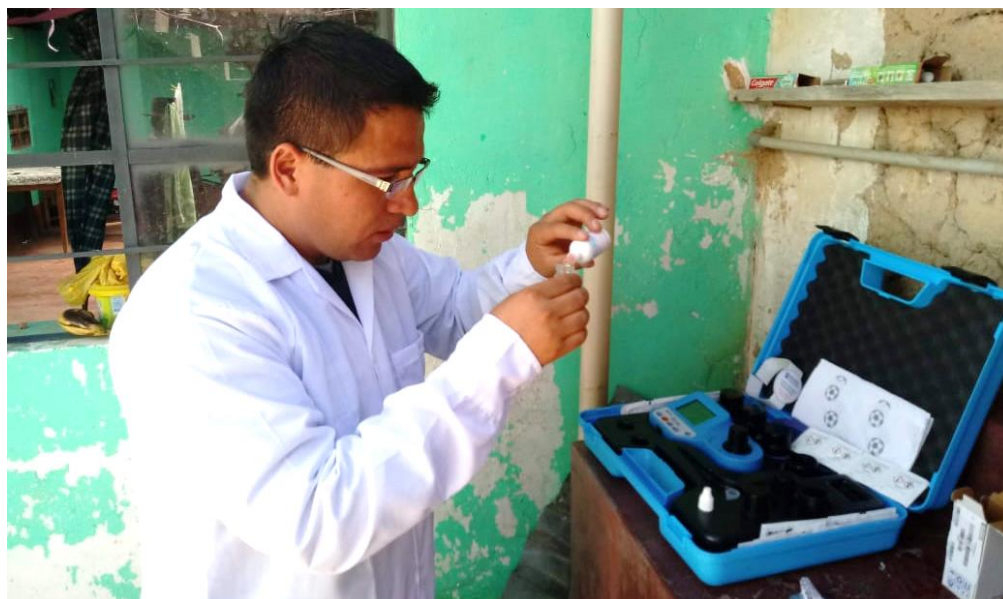
FOTOGRAFÍA 5: ADICIÓN DEL REACTIVO PARA LA MEDICIÓN CON EL FOTÓMETRO HI 96710 PARA CLORO + pH
