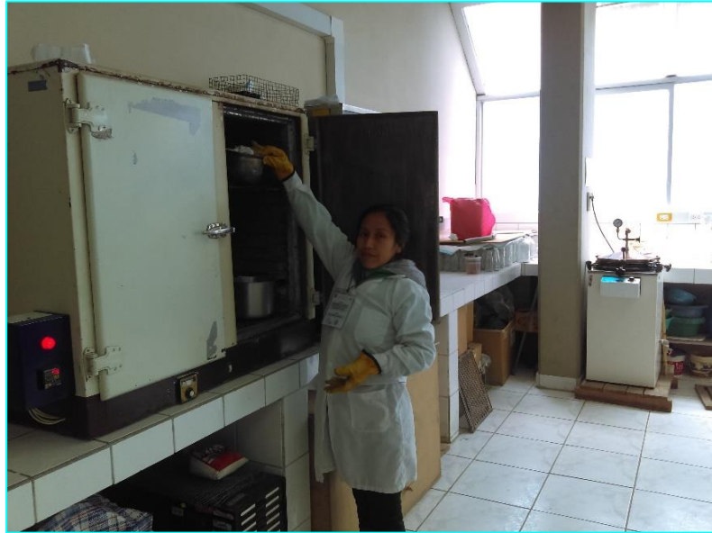
Fotografía N° 22: Muestra de residuos sólidos peligrosos puesta en el Horno de Mufla Eléctrica
