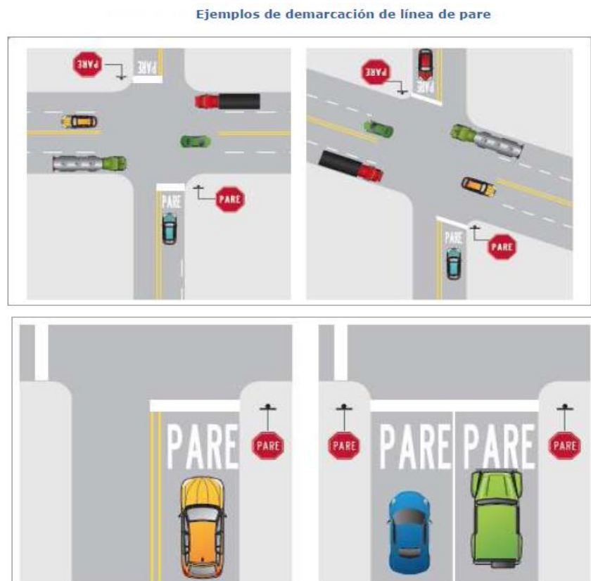
Figura N° 16: Demarcación de línea de pare
